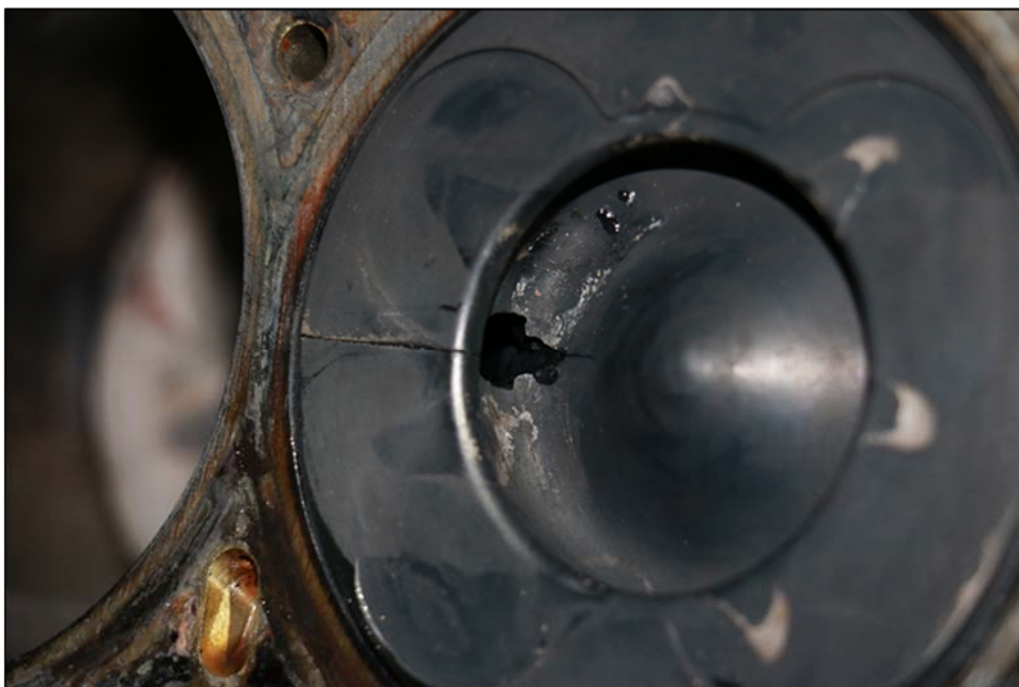
圖 1.16-8 第 4 缸活塞破洞
