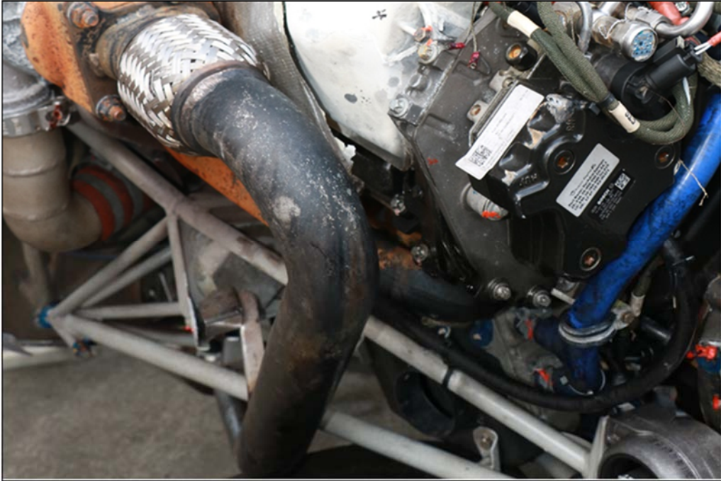
圖 1.16-2 渦輪增壓器排氣導管
