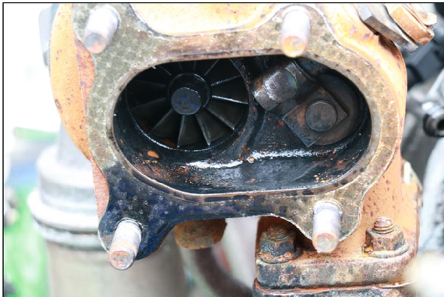
圖 1.16-3 渦輪增壓器排氣接收端
