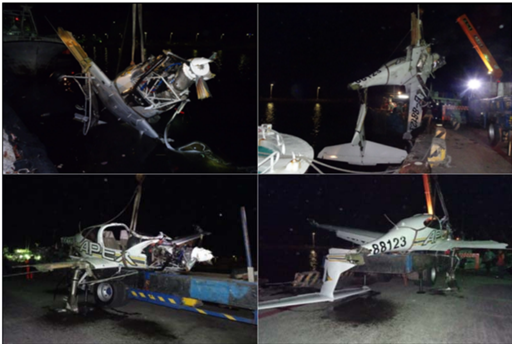
圖 1.12-1 事故機殘骸自水中吊起
