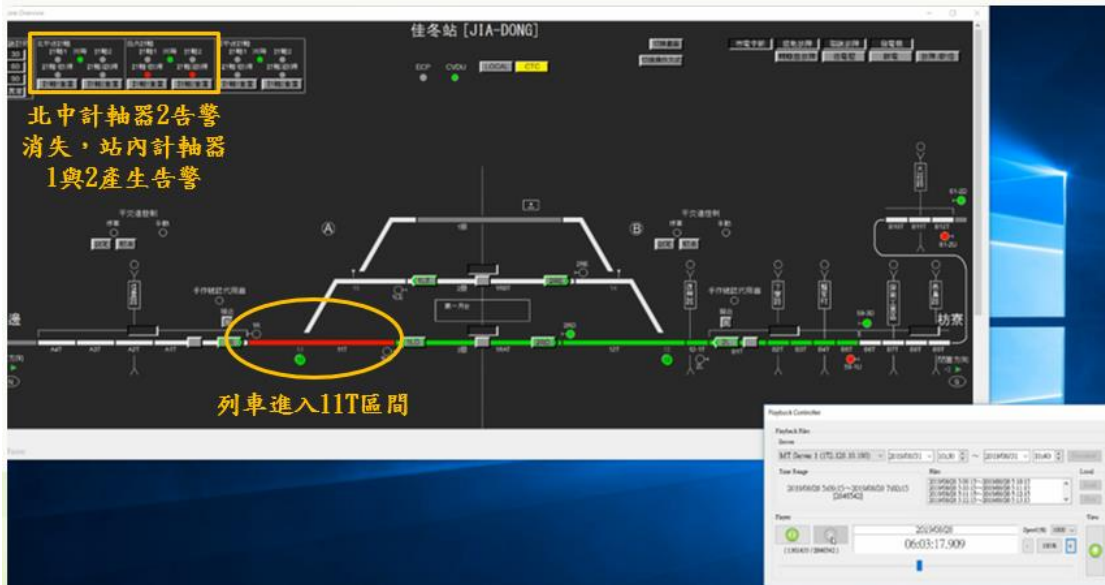
圖 1.9-24 第 333 次車佳冬站通過期間產生之異常 (3)
