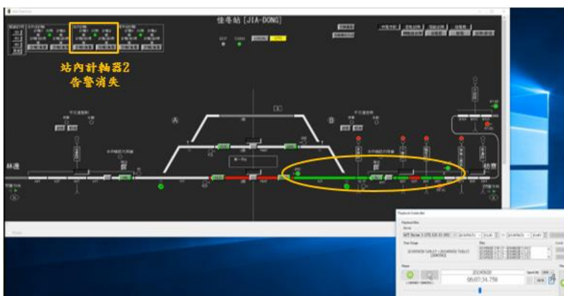
圖 1.9-29 出發號誌機 2RD 路徑開通與站內計軸器告警消失
