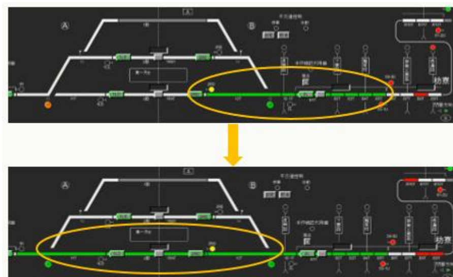
圖 1.9-17 月台出站與進站路徑先後開通
