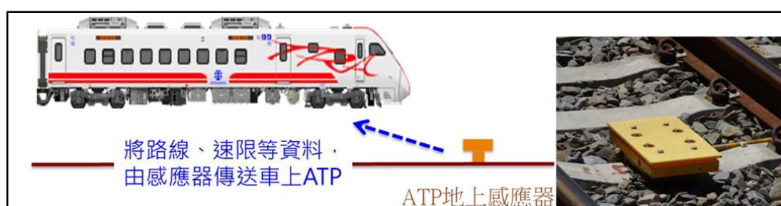
圖 1.8-3 ATP 系統運作原理
