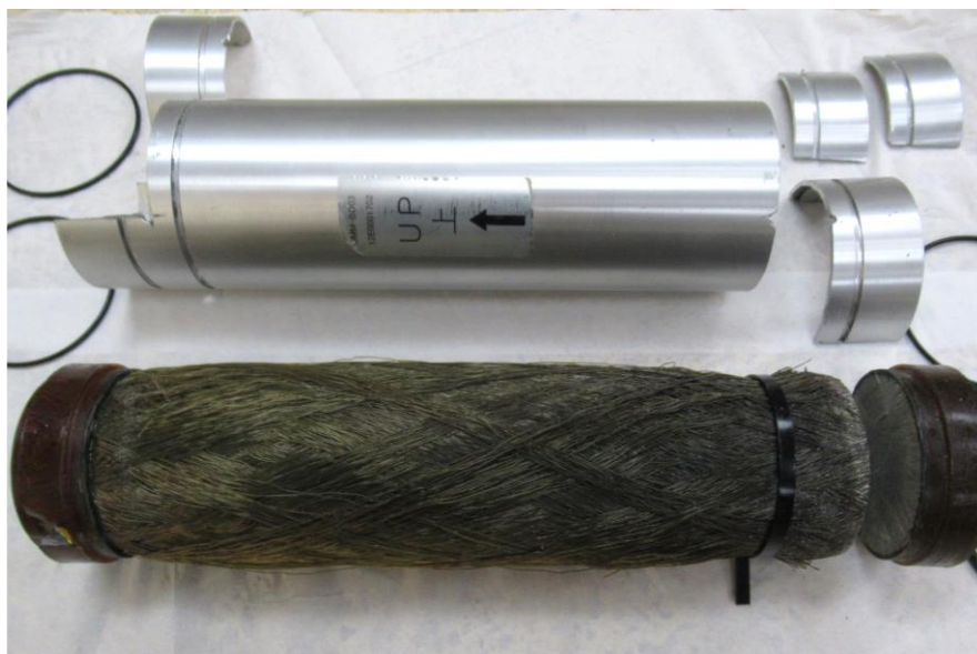
事故車TED2008車（8車） 中空絲膜濾心狀態
