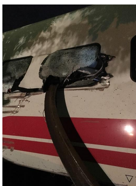
鋼軌插入車廂海側 (事故當日拍攝照片)
