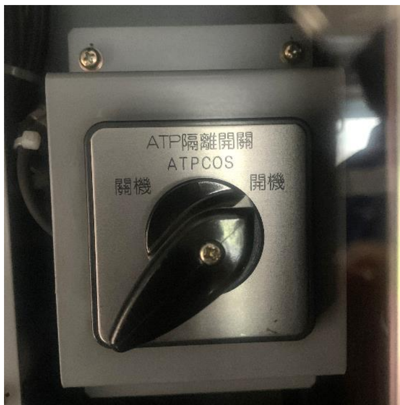
圖 1.8-8 駕駛室背向面板的 ATP 隔離開關
