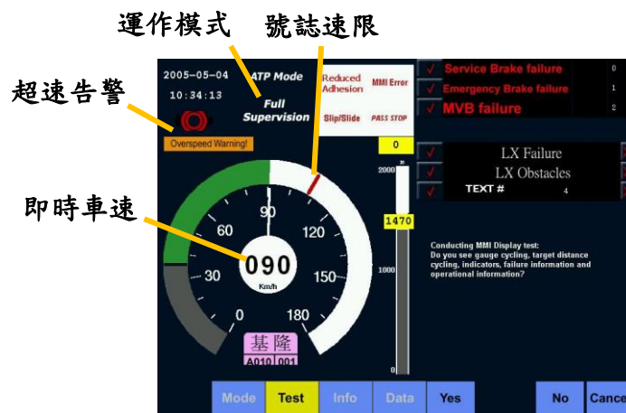
圖 1.9-2 車載 ATP 螢幕畫面說明
