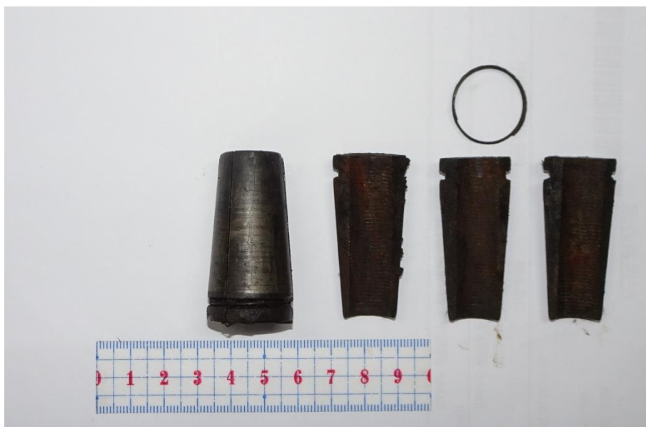
圖 1.10-4 事故橋梁之夾片照片及尺寸
