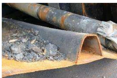
(e) AB4 與 AB5 間斜破裂面
