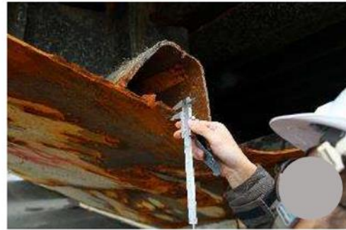
(b) 量測鋼板厚度
