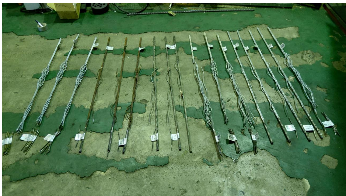
圖 1.11-4 拉伸試驗完成之斷裂鋼絞線
