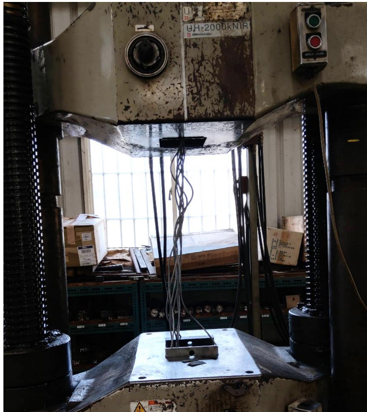
圖 1.11-3 拉伸試驗機台及斷裂鋼絞線
