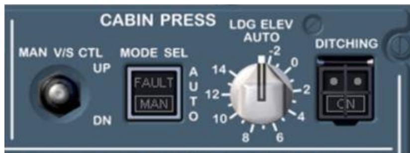
圖 1.6-3 艙壓系統控制面板
