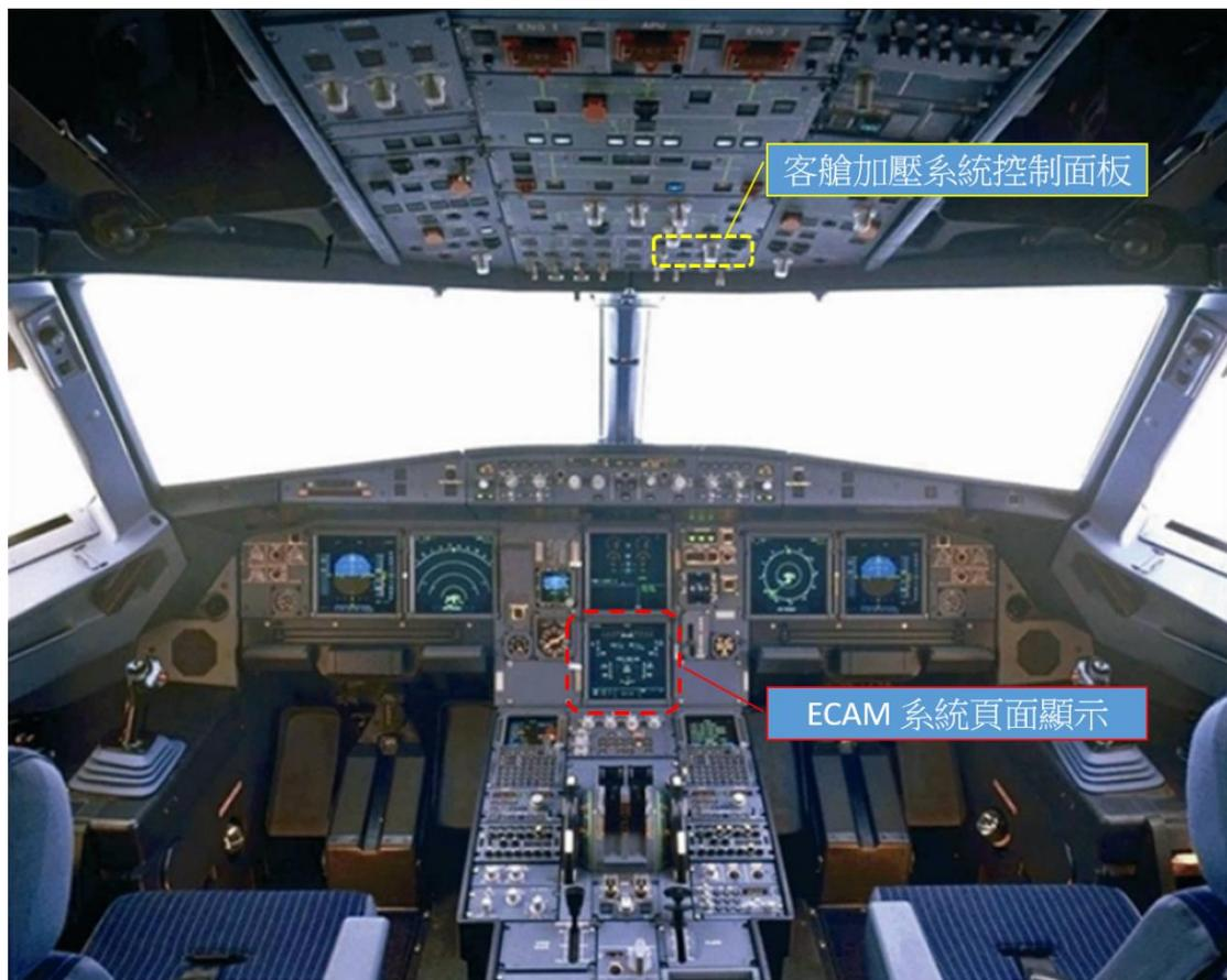
圖 1.6-2 艙壓系統控制面板及 ECAM 系統顯示位置
