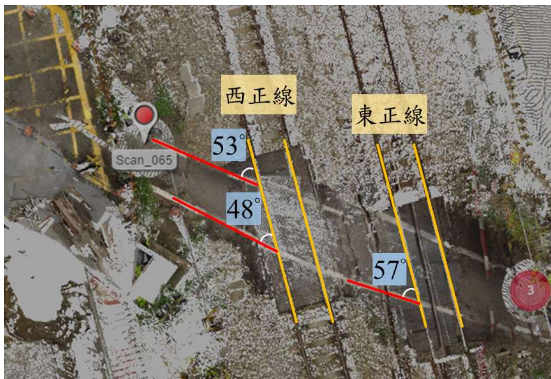
圖 1.12-3 新興巷平交道與道路夾角量測數據
