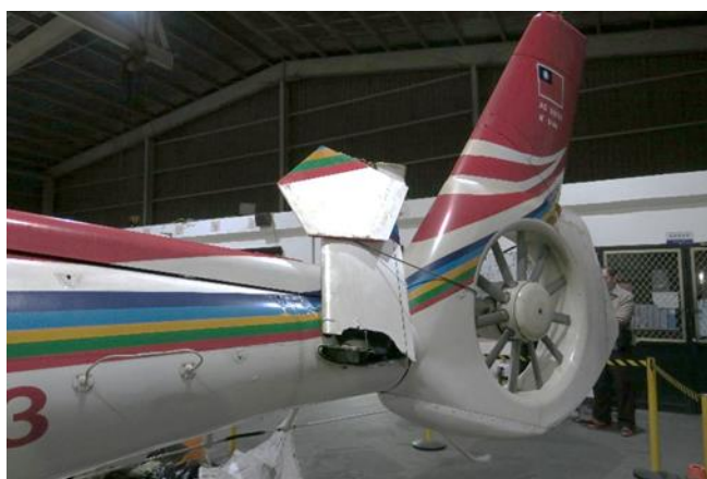
圖 1.12-5 尾桁及尾旋翼受損情形
