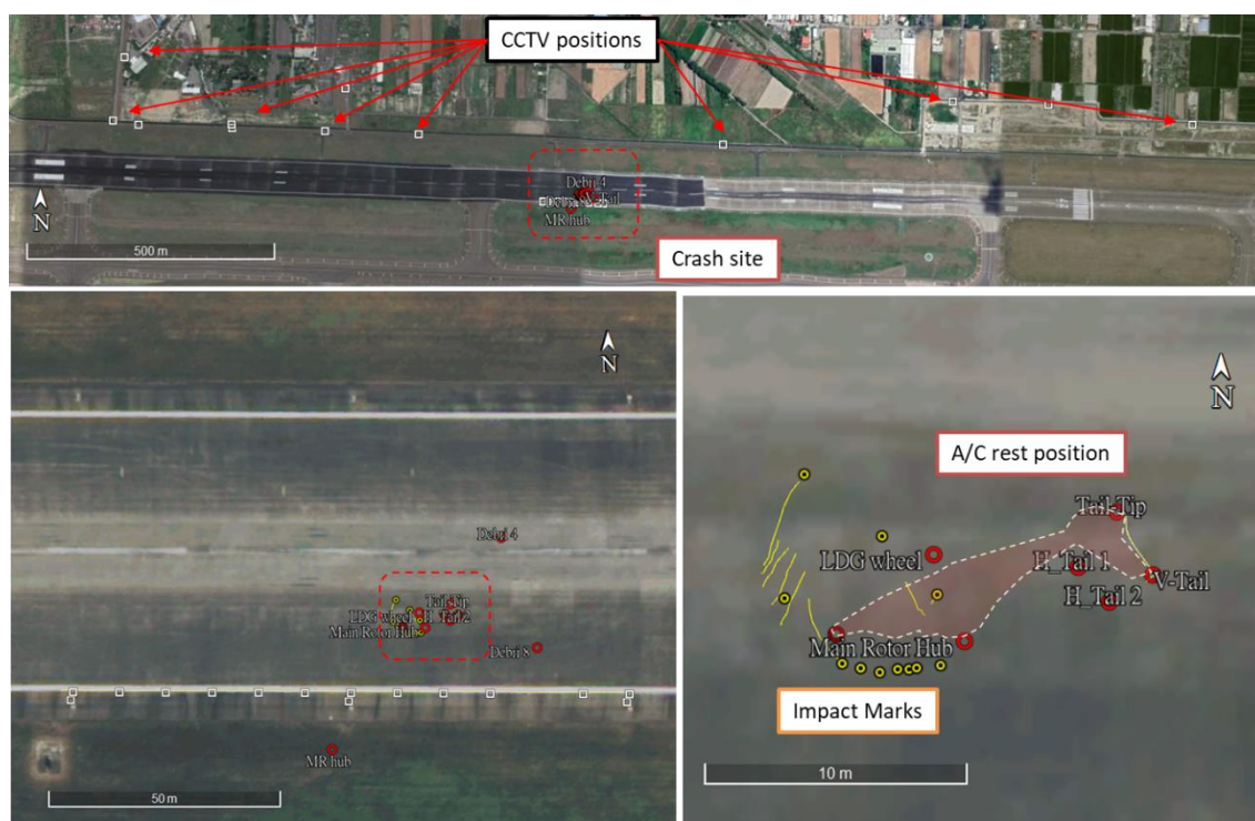
圖 1.12-13 現場測量結果及 CCTV 位置
