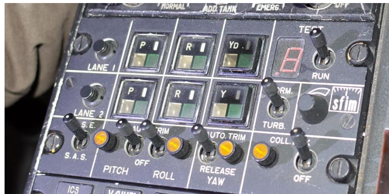
圖 1.12-11 yaw damper 及 yaw control 開關位置
