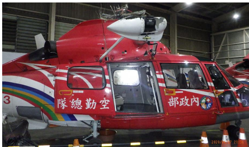
圖 1.12-3 機身右側受損情形
