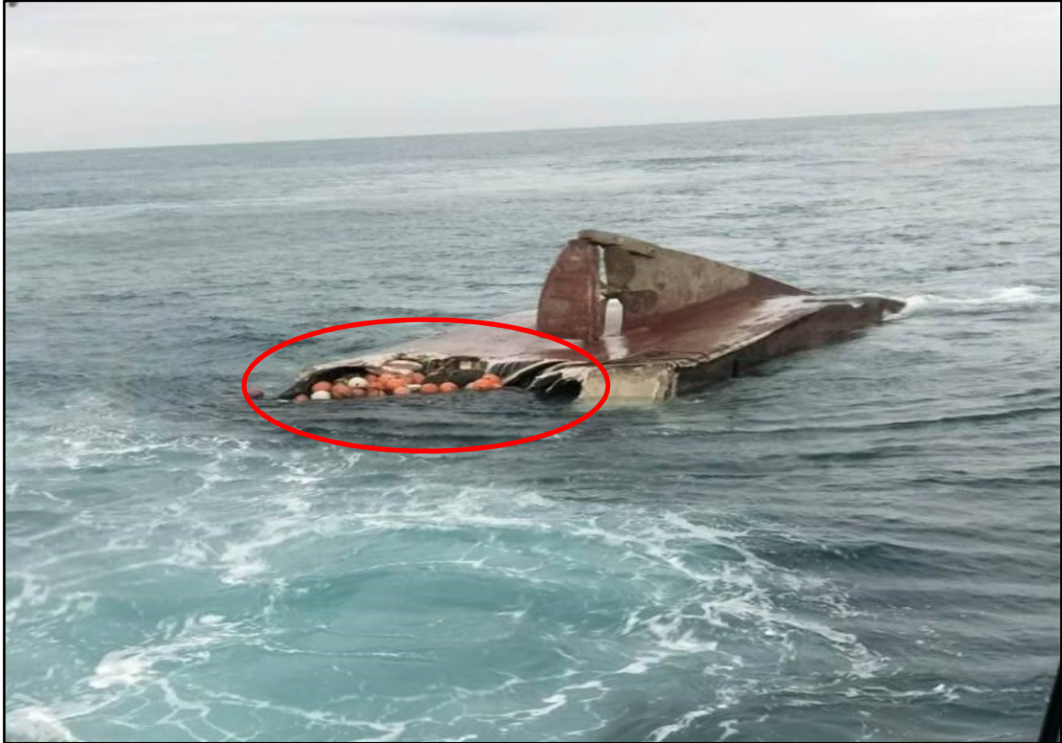
圖 1.10-5 新億編殘骸現場船艙撞擊處呈圓形凹陷
