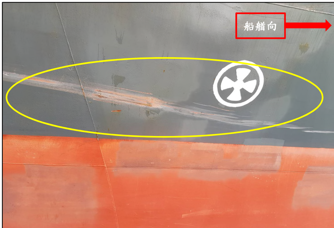
圖 1.10-2 MARCLIFF 右舷船殼擦撞痕跡 (一)
