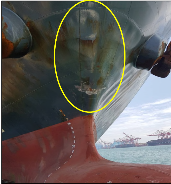
圖 1.10-1 MARCLIFF 船艏擦撞痕跡
