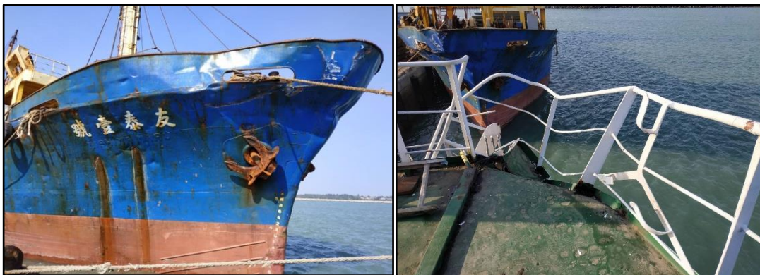
圖 1 友泰 1 號船艏受損狀況
