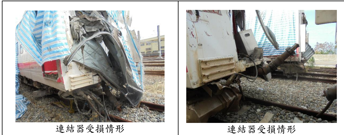
圖 1.3-6 第 7 車連結器損傷概況
