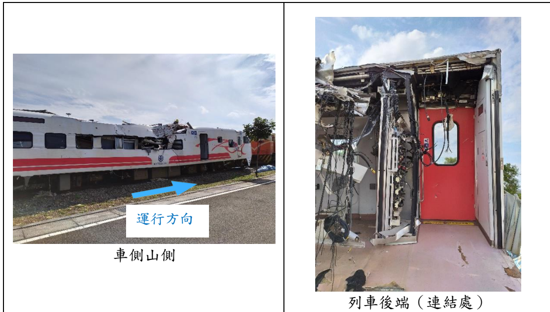
圖 1.3-1 第 8 車車廂損傷概況圖
