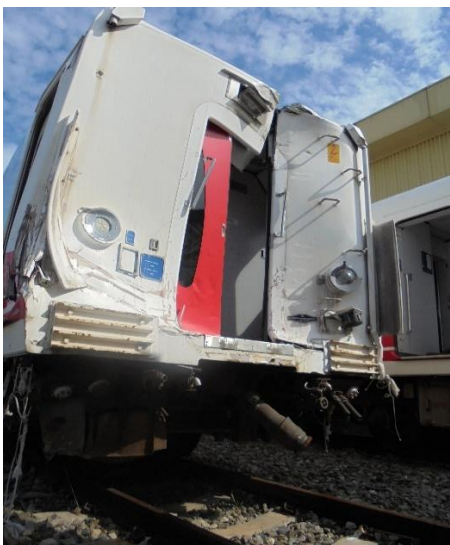
車端受損情形
