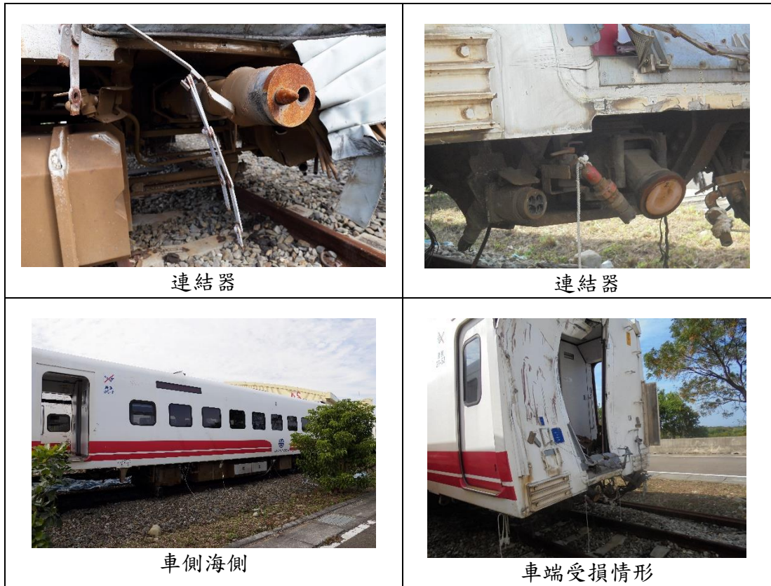
圖 1.3-15 第 2 車損傷概況圖
