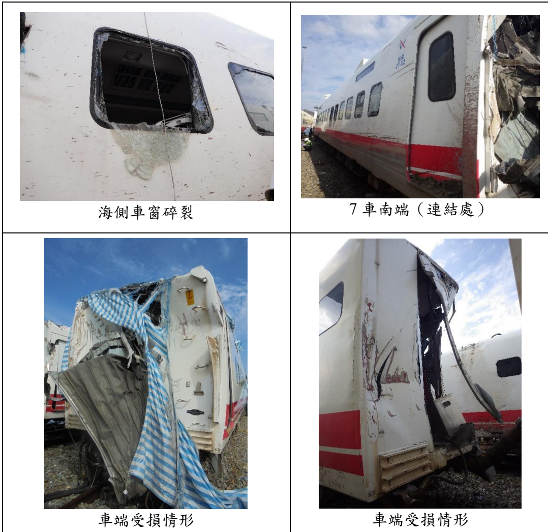
圖 1.3-5 第 7 車車廂損傷概況圖
