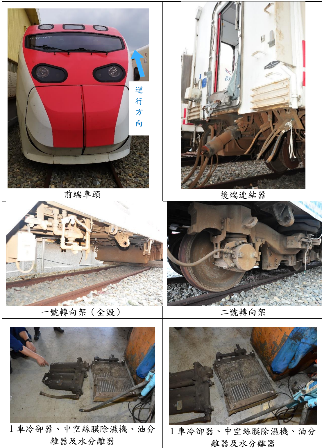
圖 1.3-16 第 1 車損傷概況圖
