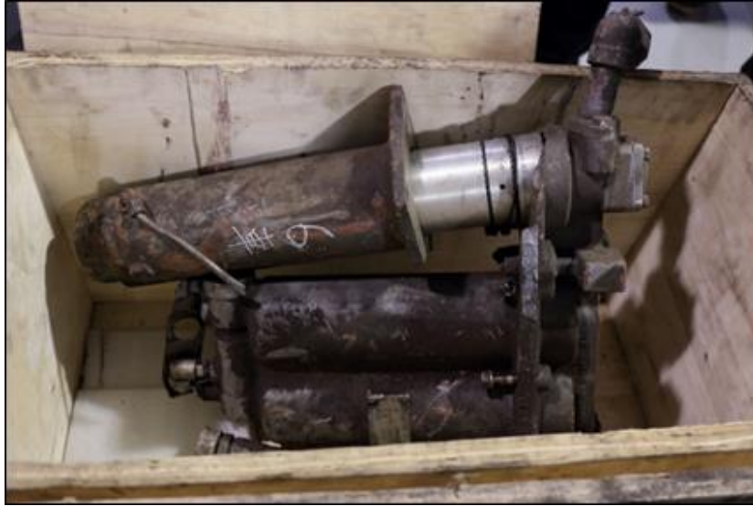
圖 1.3-10 第 6 車中空絲膜除濕機、油分離器及水分離器
