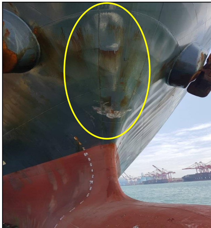
圖 1.10-1 MARCLIFF 船艙擦撞痕跡
