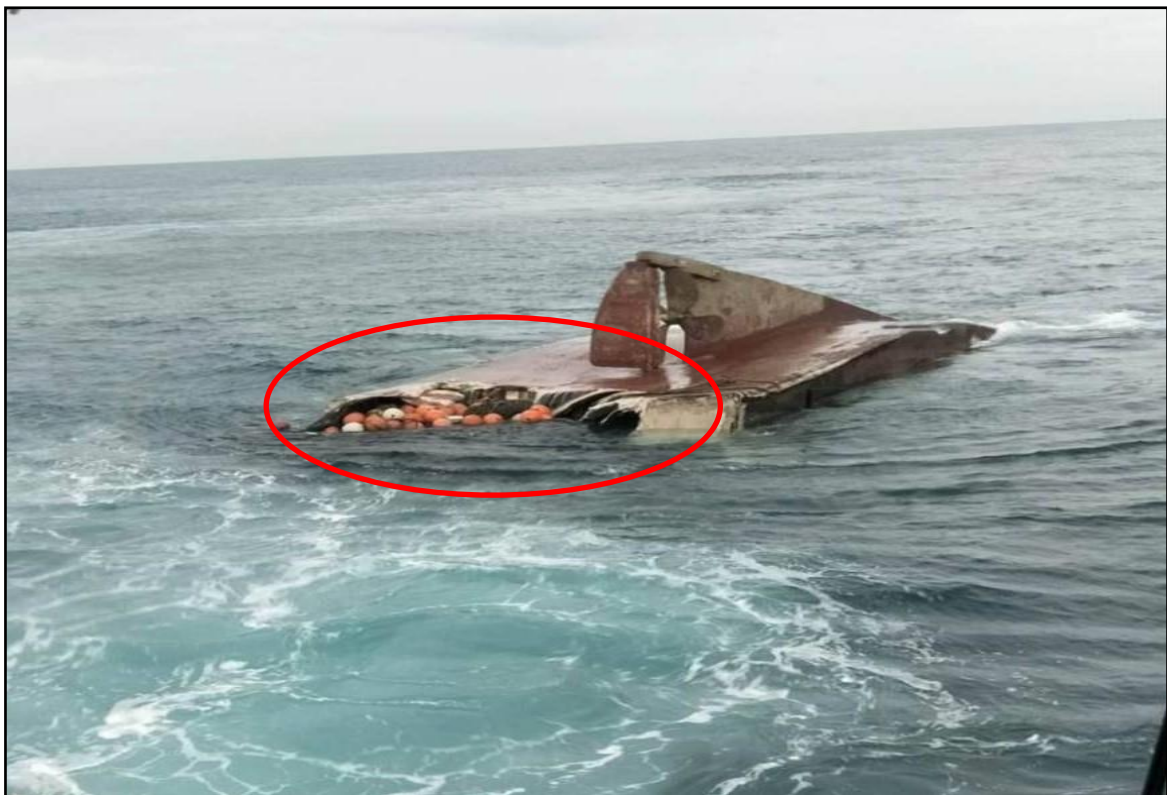
圖 1.10-5 新億編殘骸現場船艙撞擊處呈圓形凹陷
