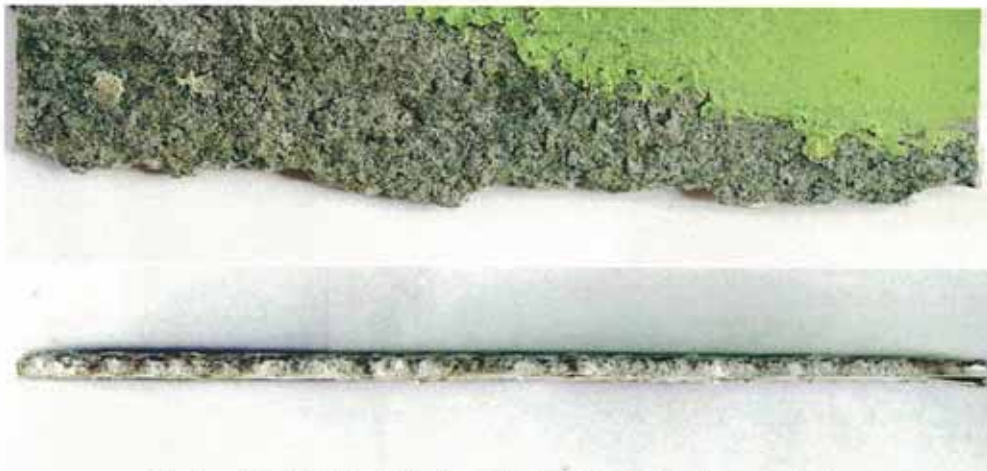
圖 9、編號 7 蒙皮試片巨觀觀察(下圖為斷面正視)。
