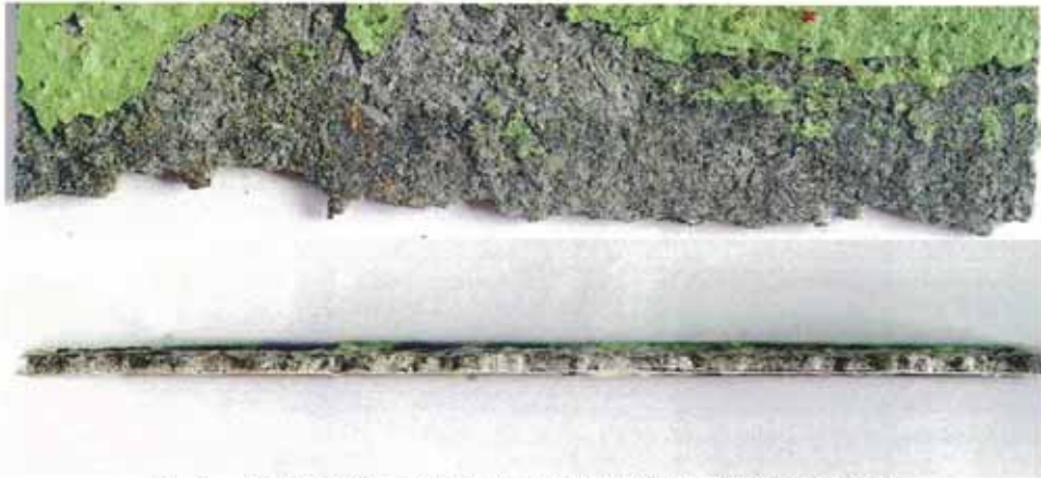
圖 5、編號 3 蒙皮試片巨觀觀察(下圖為斷面正視)。
