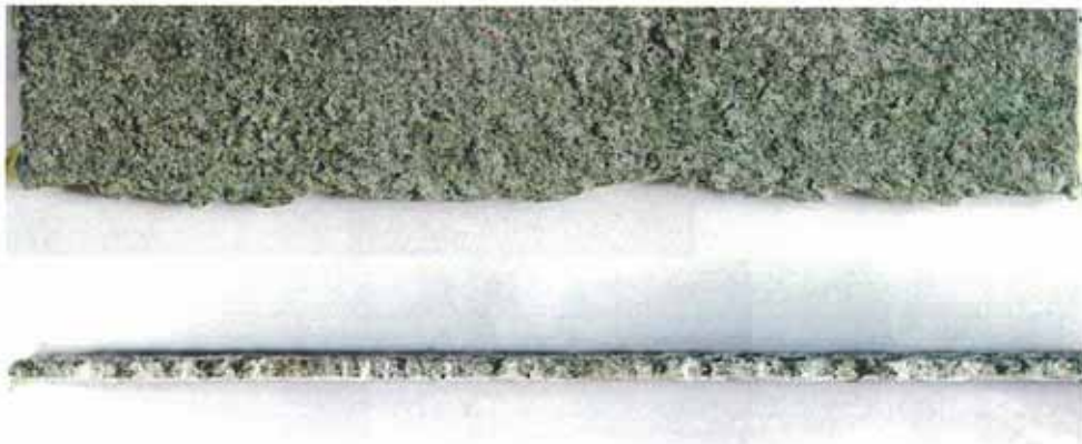
圖 8、編號 6 蒙皮試片巨觀觀察(下圖為斷面正視)。
