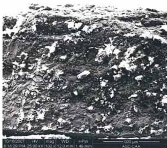
圖 14、編號 1 號試片 SEM 下之破断面微觀特徵觀察。
