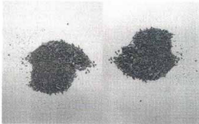
圖 31、自送檢蒙皮取下之腐蝕粉末，分成兩等份---(a) & (b)
