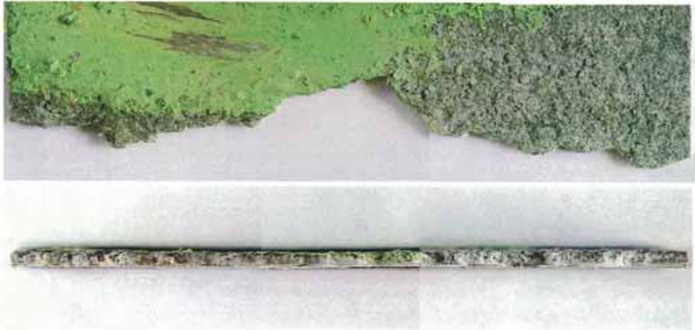
圖 7、編號 5 蒙皮試片巨觀觀察(下圖為斷面正視)。
