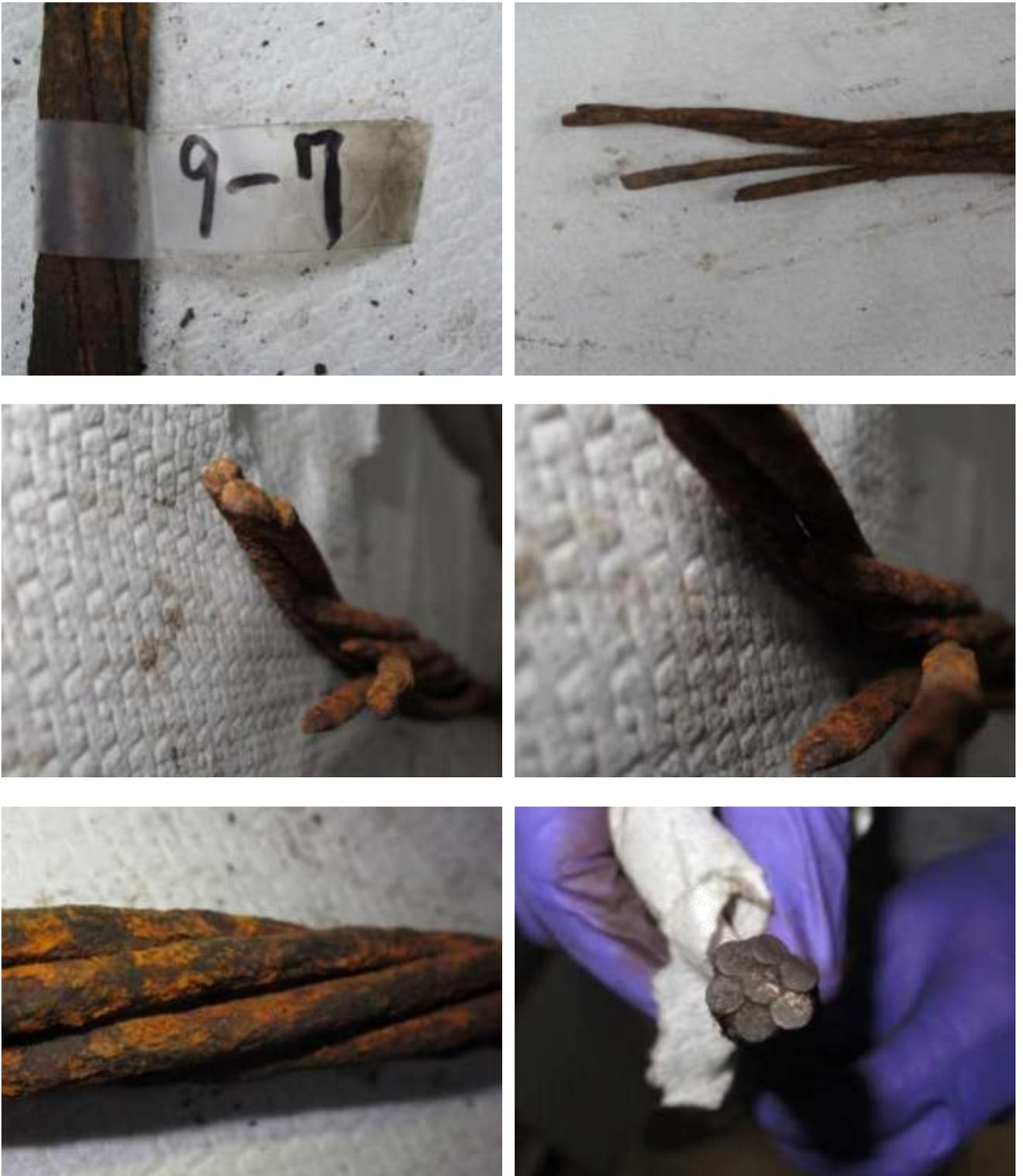
圖111 橋面9號錨頭殘留之鋼絞線9-7束外觀
