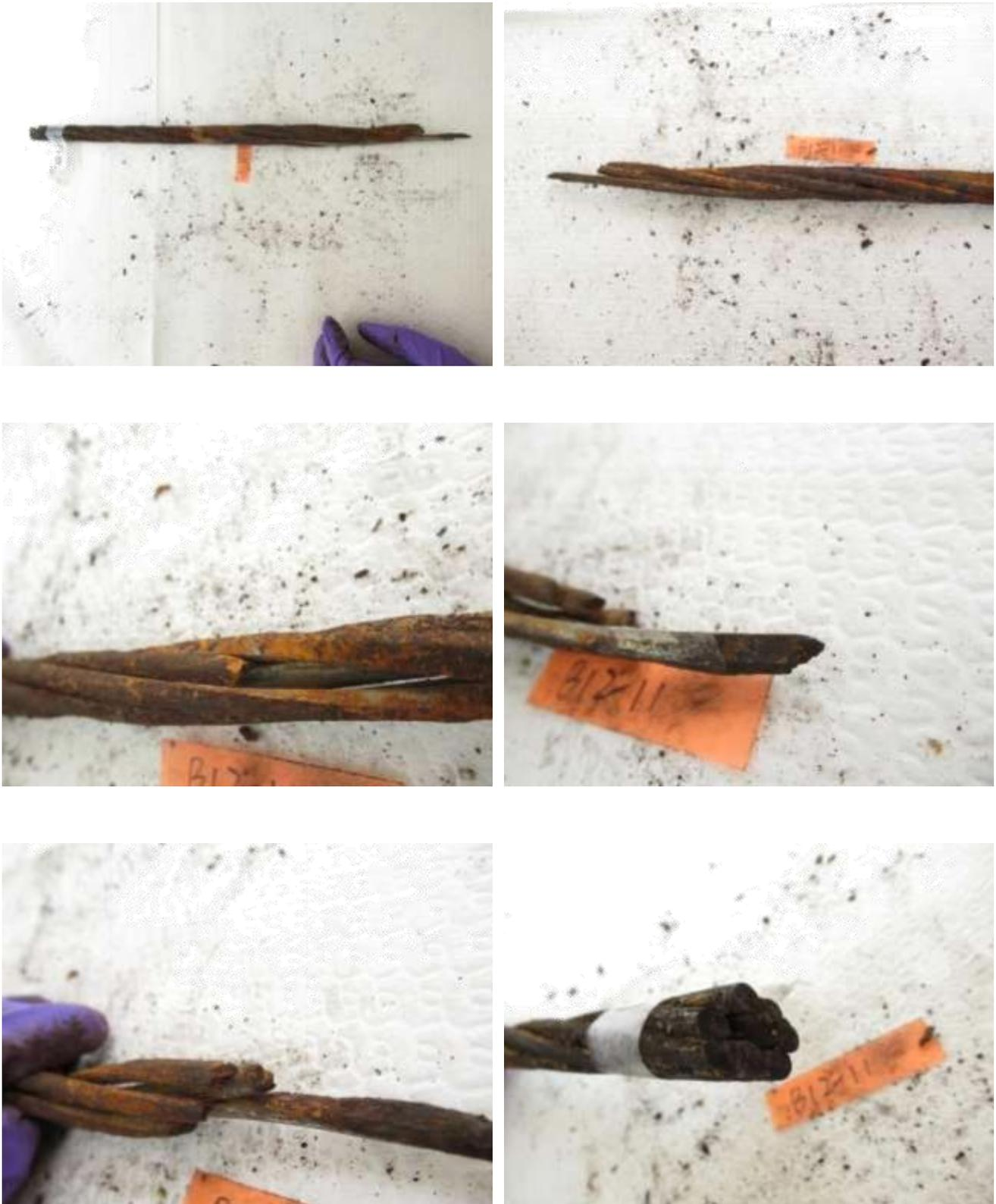
圖152 橋面 12 號錨頭殘留之鋼絞線 12-11 束外觀
