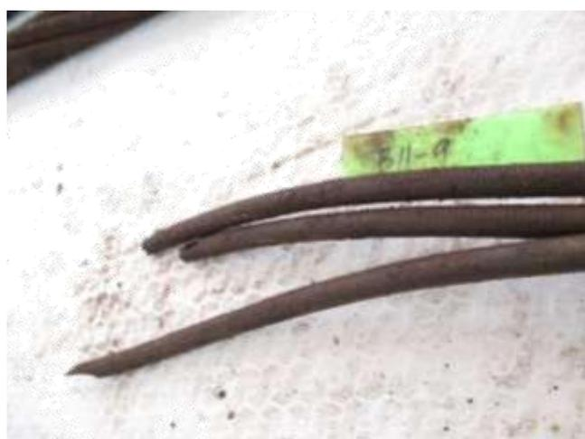
圖139 橋面 11 號錨頭殘留之鋼絞線 11-9 束外觀
