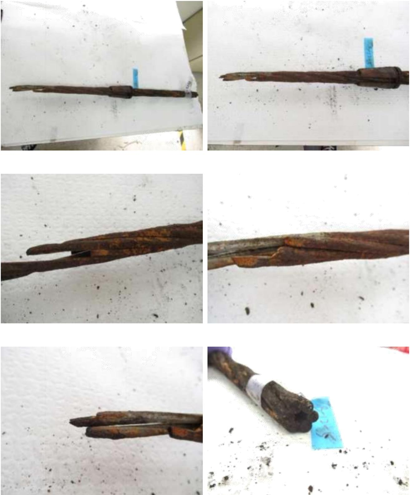
圖146 橋面 12 號錨頭殘留之鋼絞線 12-5 東外觀
