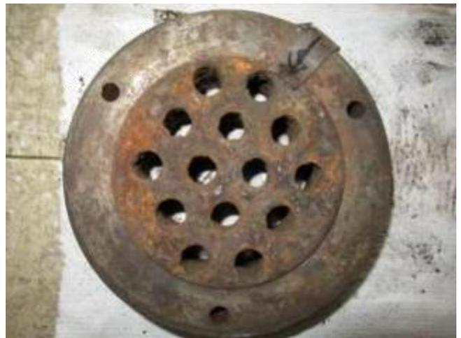
圖83 橋面 12 號錨頭拆解後外觀
