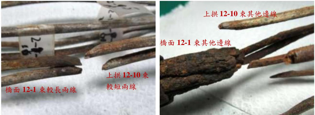
圖171 橋面第 12-1 束與上拱 12-10 束斷裂處上下端邊緣對應外觀
