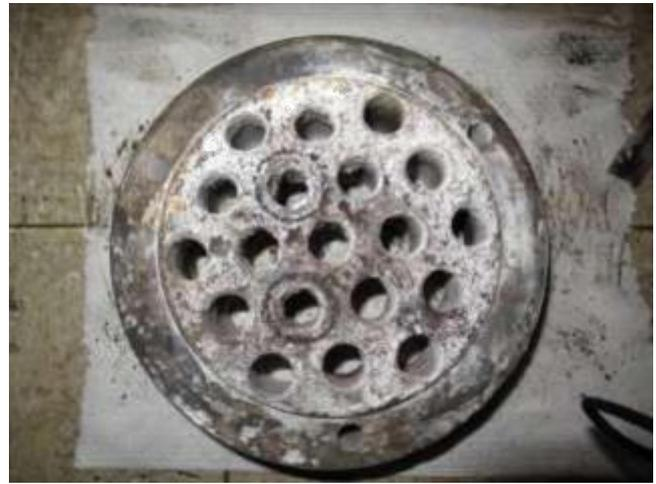
圖84 橋面 13 號錨頭拆解後外觀
