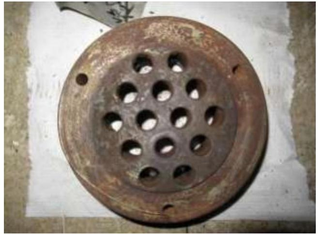
圖75 橋面 4 號錨頭拆解後外觀
