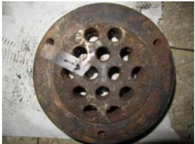
圖79 橋面 8 號錨頭拆解後外觀
