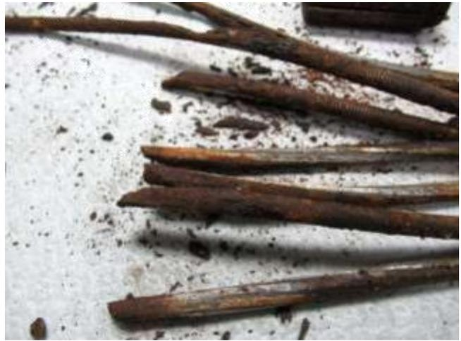
圖175 橋面第 12-1 束鋼線拆解後外觀
