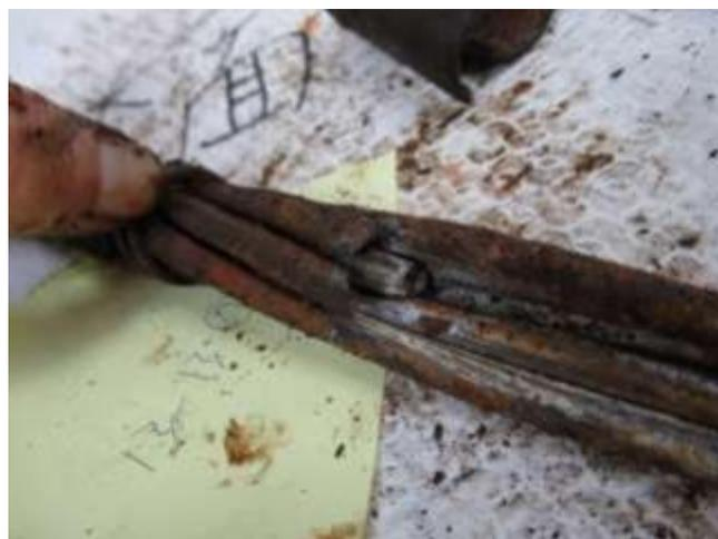
圖168 橋面 13 號錨頭殘留之鋼絞線 13-13 束外觀
