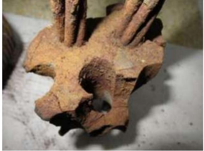
圖72 橋面 1 號錨頭拆解後外觀
