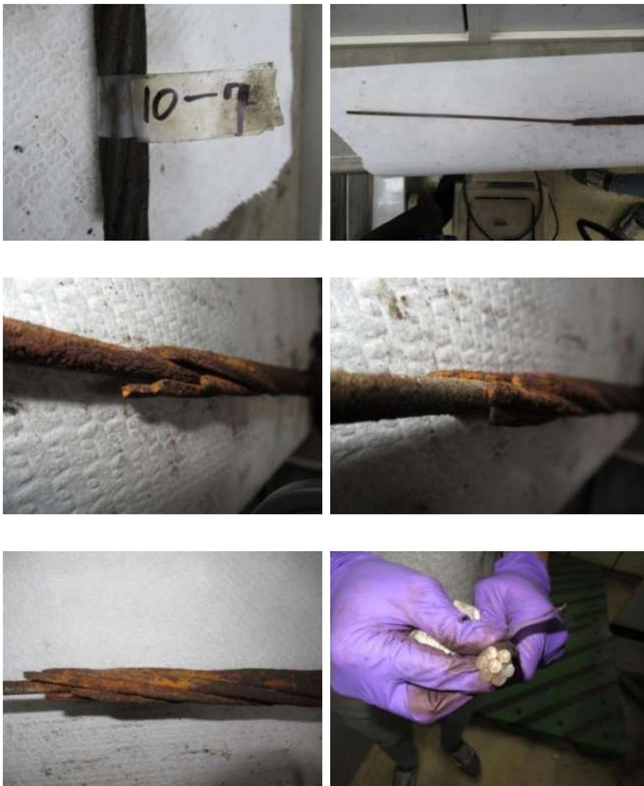
圖125 橋面 10 號錨頭殘留之鋼絞線 10-7 束外觀
