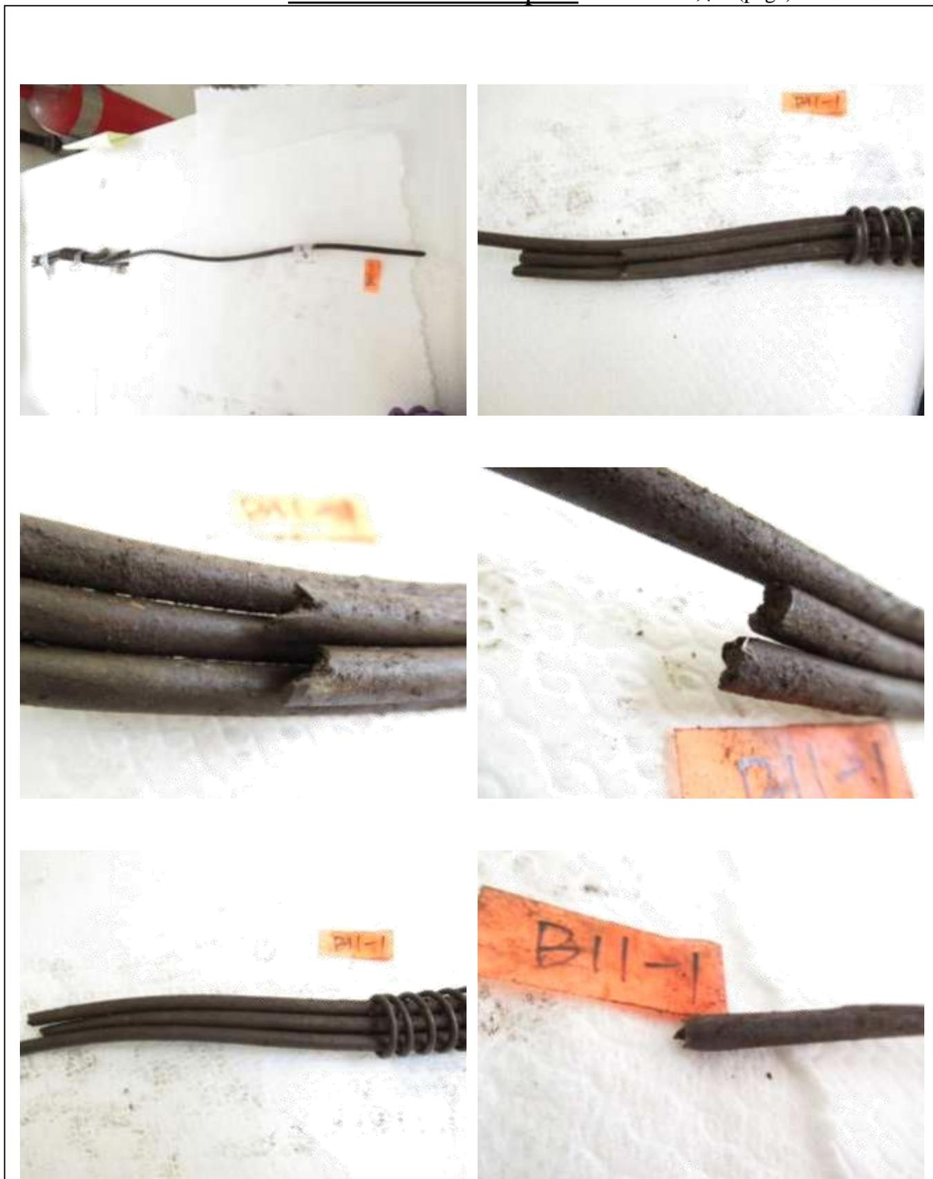
圖131 橋面 11 號錨頭殘留之鋼絞線 11-1 束外觀
