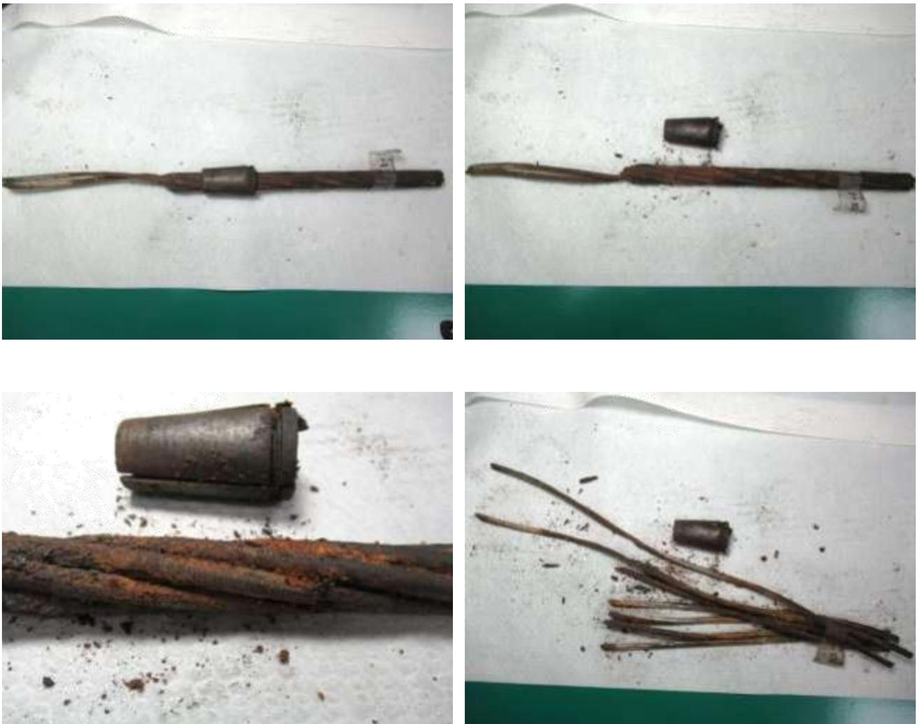
圖174 橋面第 12-1 束鋼線拆解過程
