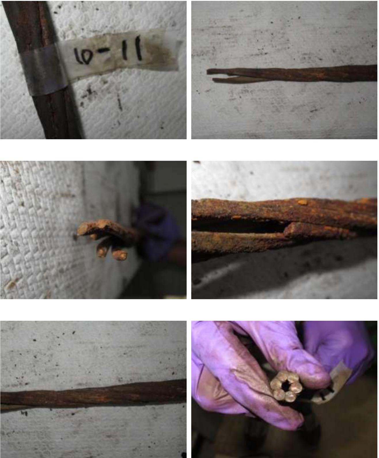
圖129 橋面 10 號錨頭殘留之鋼絞線 10-11 束外觀
