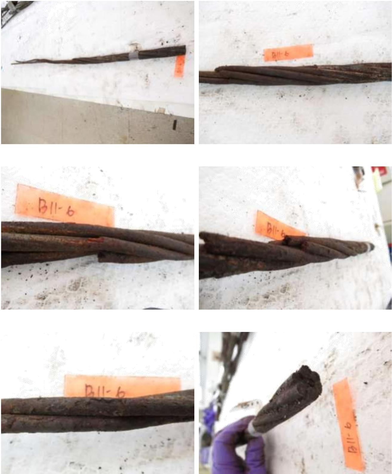
圖136 橋面 11 號錨頭殘留之鋼絞線 11-6 束外觀
