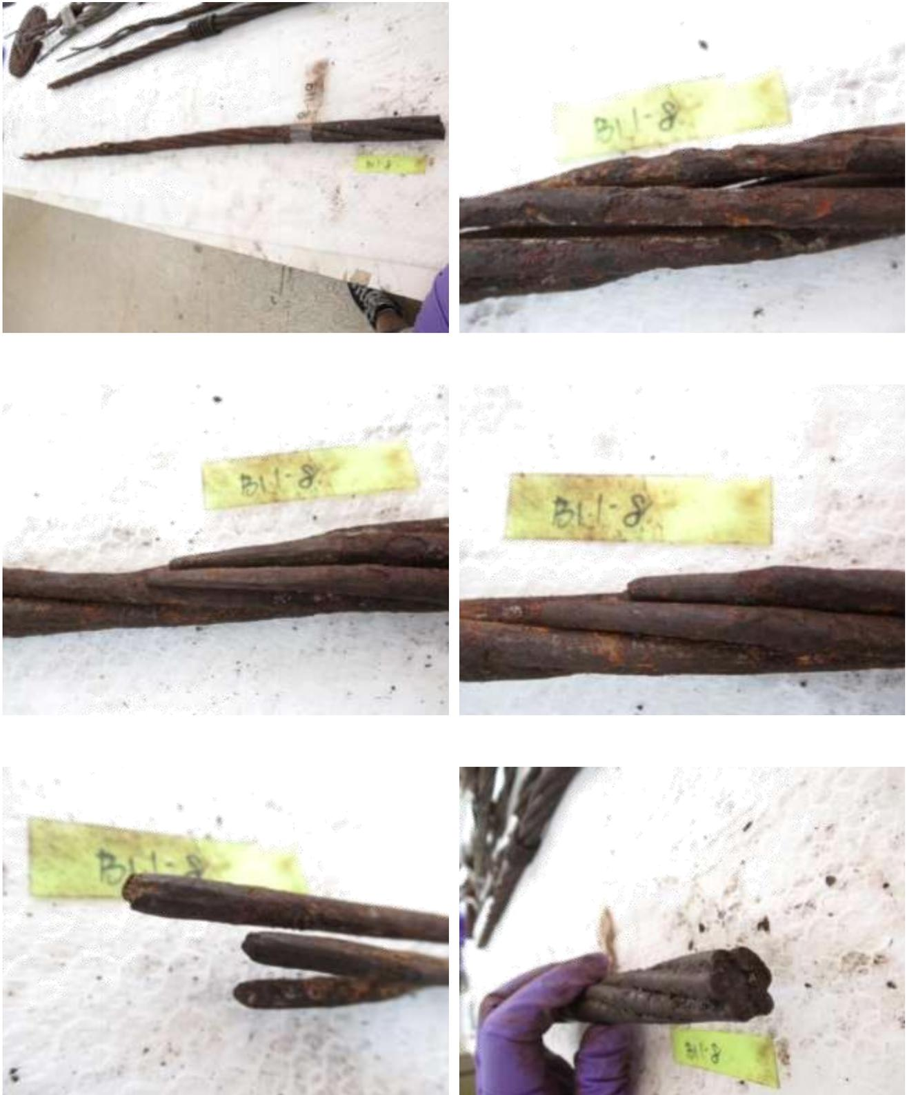
圖138 橋面 11 號錨頭殘留之鋼絞線 11-8 束外觀
