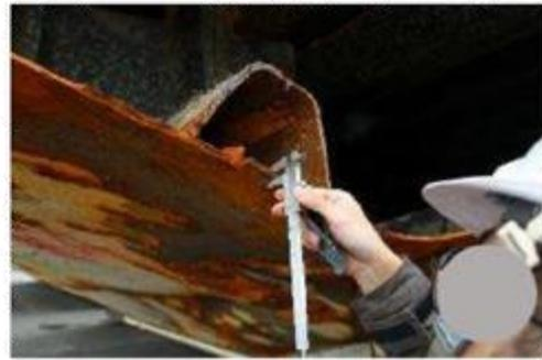
(b) 量測鋼板厚度
