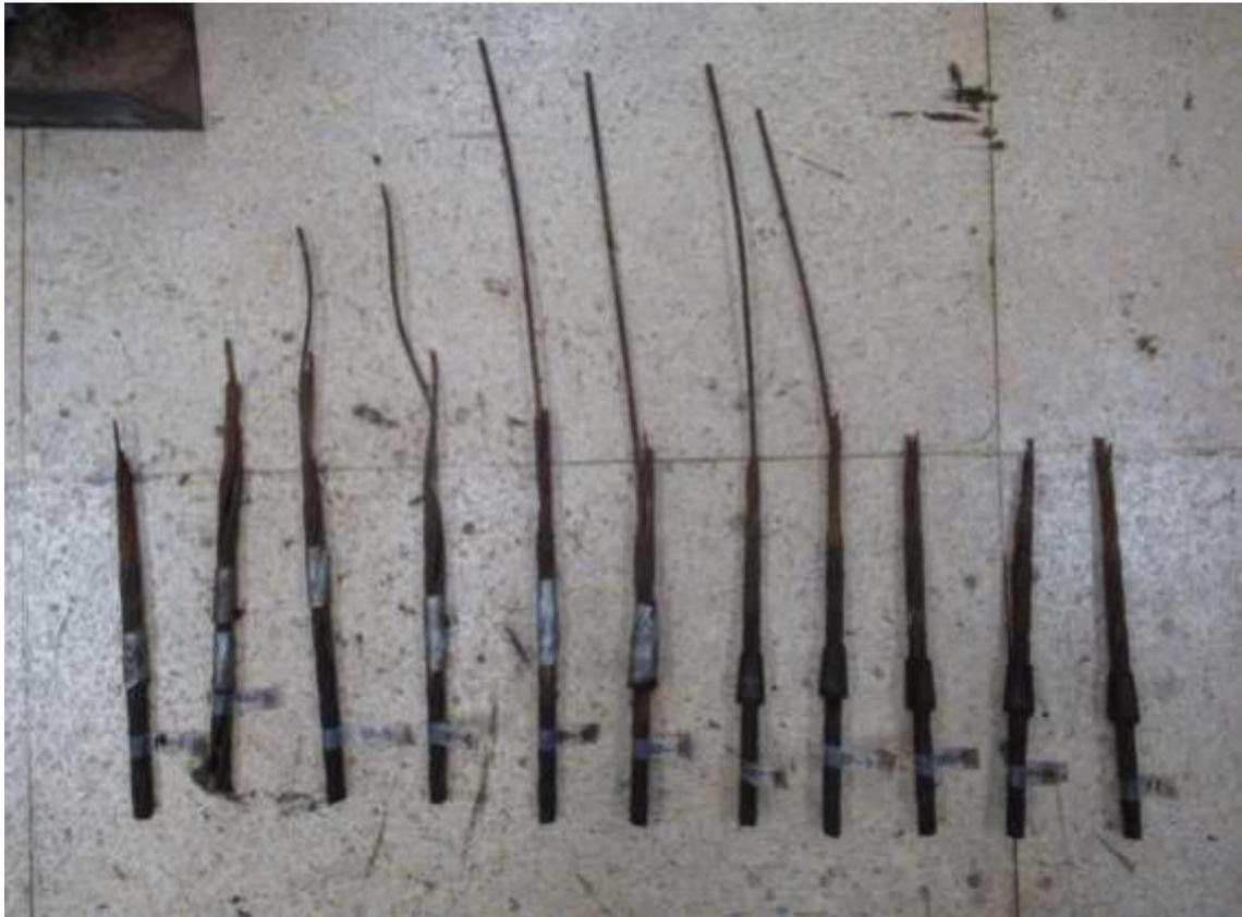
圖118 橋面 10 號錨頭殘留之全部鋼絞線外觀
