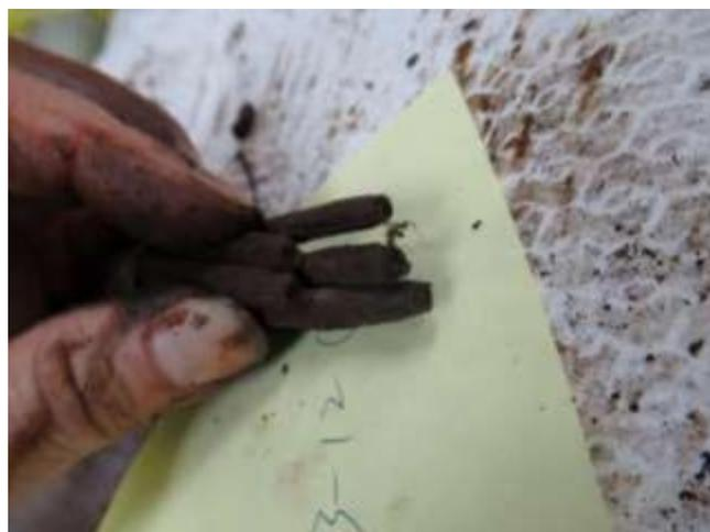
圖167 橋面 13 號錨頭殘留之鋼絞線 13-12 束外觀
