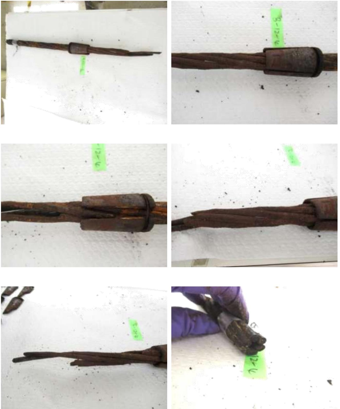
圖145 橋面 12 號錨頭殘留之鋼絞線 12-4 束外觀
