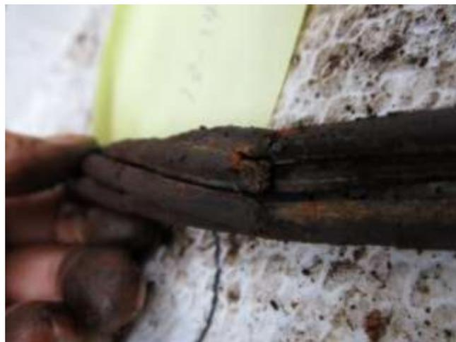
圖169 橋面 13 號錨頭殘留之鋼絞線 13-14 束外觀
