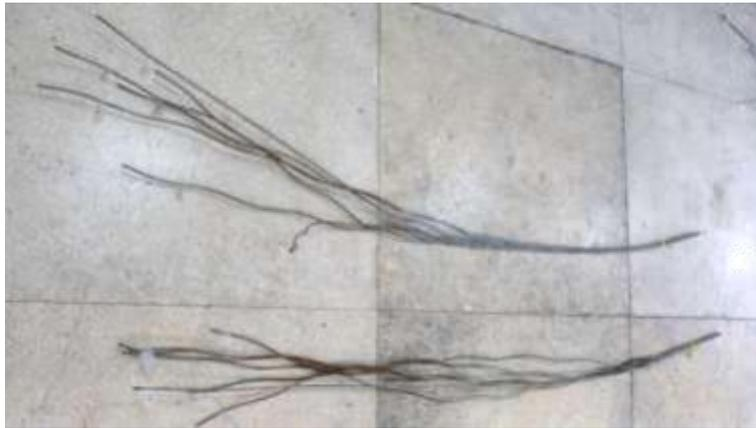
圖18 編號第 8 股吊索之 2 束鋼絞線外觀
