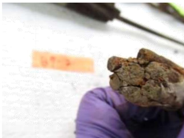
圖100 橋面 7 號錨頭殘留之鋼絞線 7-2 束外觀
