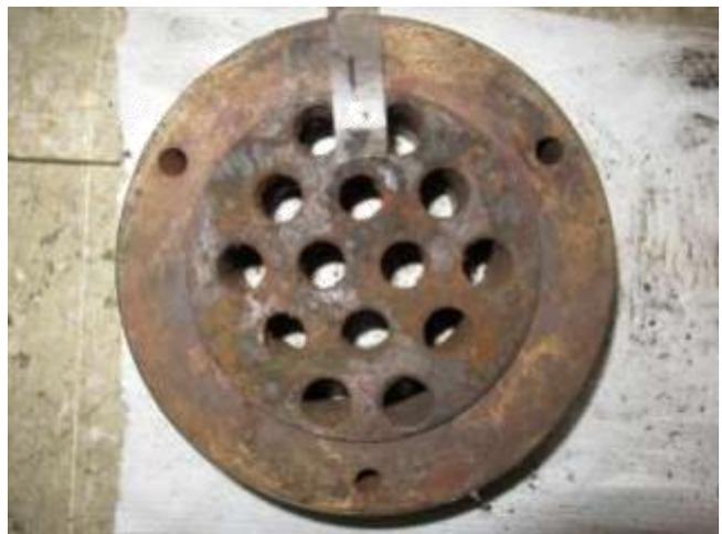
圖80 橋面 9 號錨頭拆解後外觀
