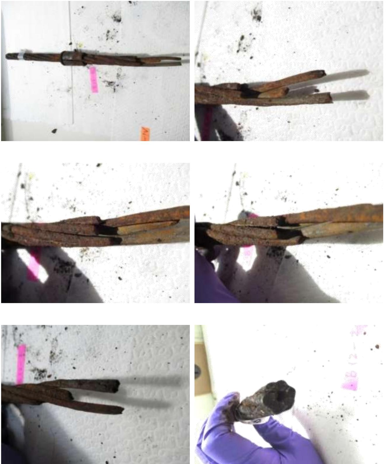
圖143 橋面 12 號錨頭殘留之鋼絞線 12-2 束外觀
