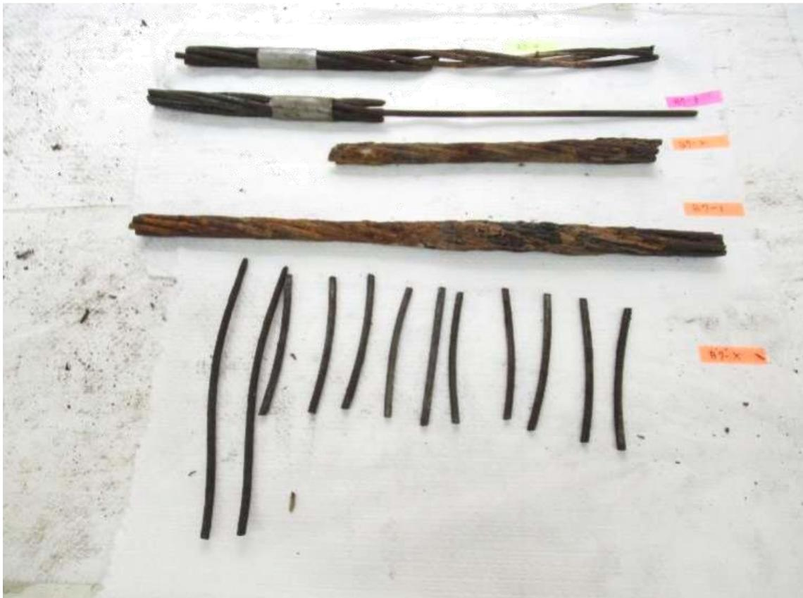
圖98 橋面 7 號錨頭殘留之全部鋼絞線外觀
