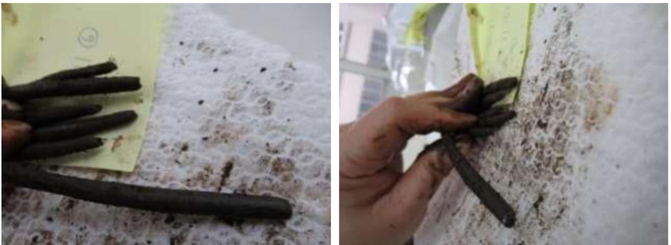
圖166 橋面 13 號錨頭殘留之鋼絞線 13-11 束外觀
