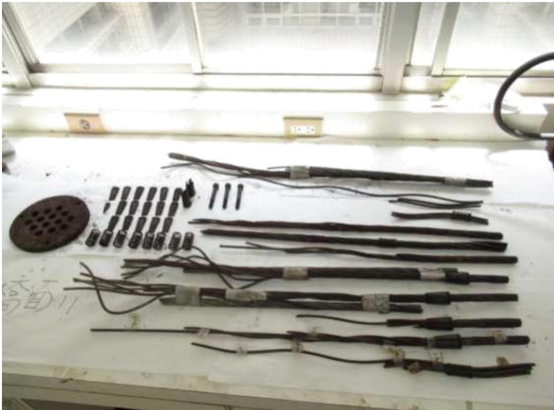
圖130 橋面 11 號錨頭殘留之全部鋼絞線外觀
