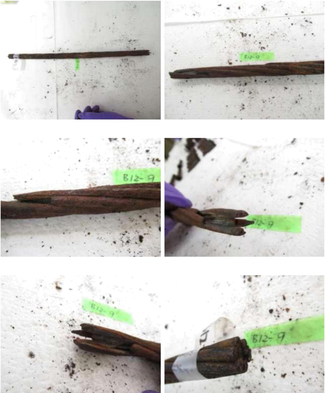
圖150 橋面 12 號錨頭殘留之鋼絞線 12-9 束外觀
