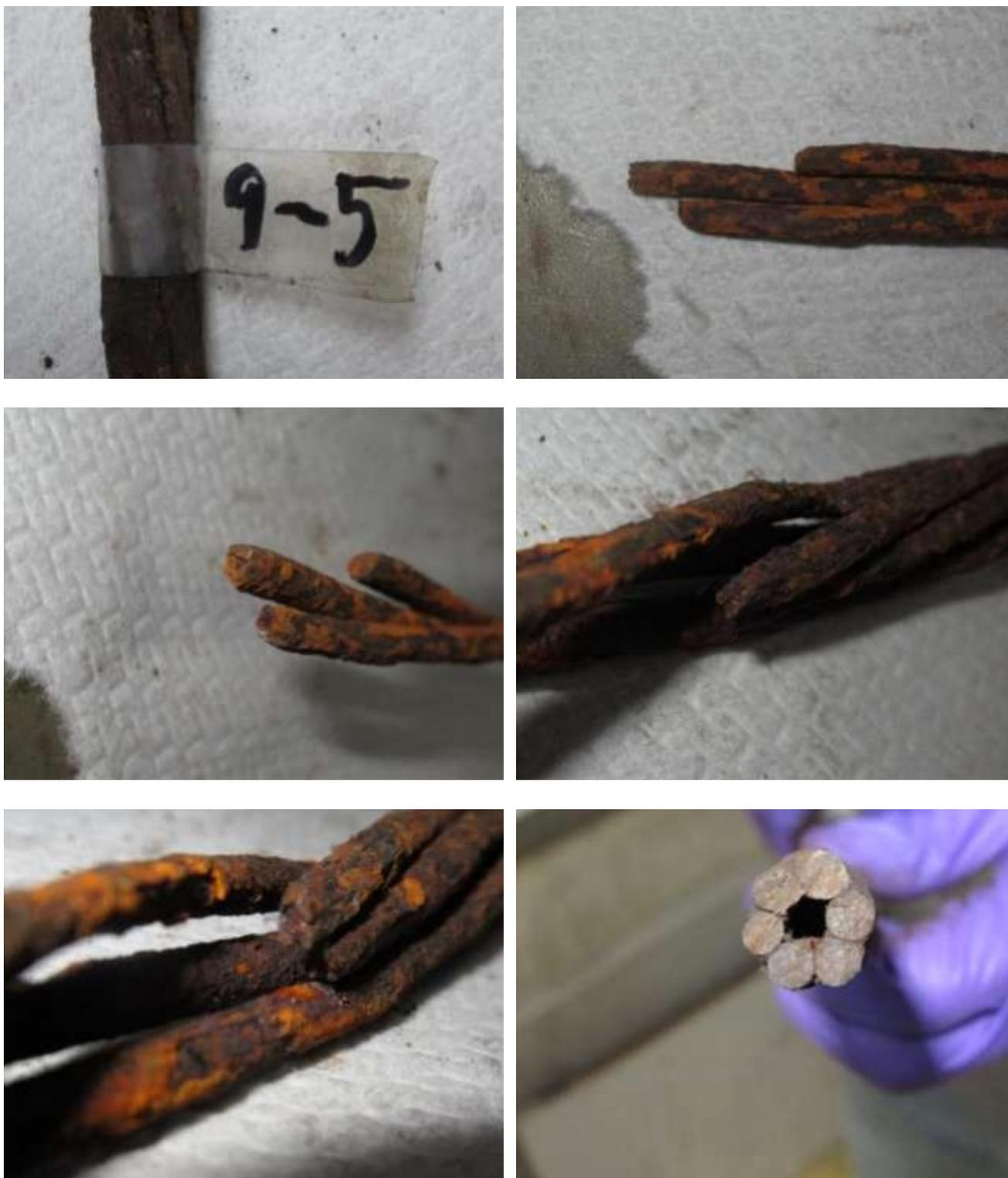
圖109 橋面 9 號錨頭殘留之鋼絞線 9-5 束外觀
