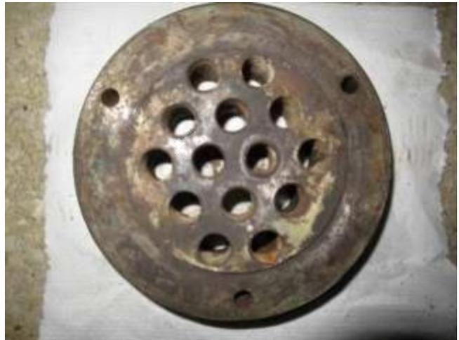
圖74 橋面 3 號錨頭拆解後外觀
