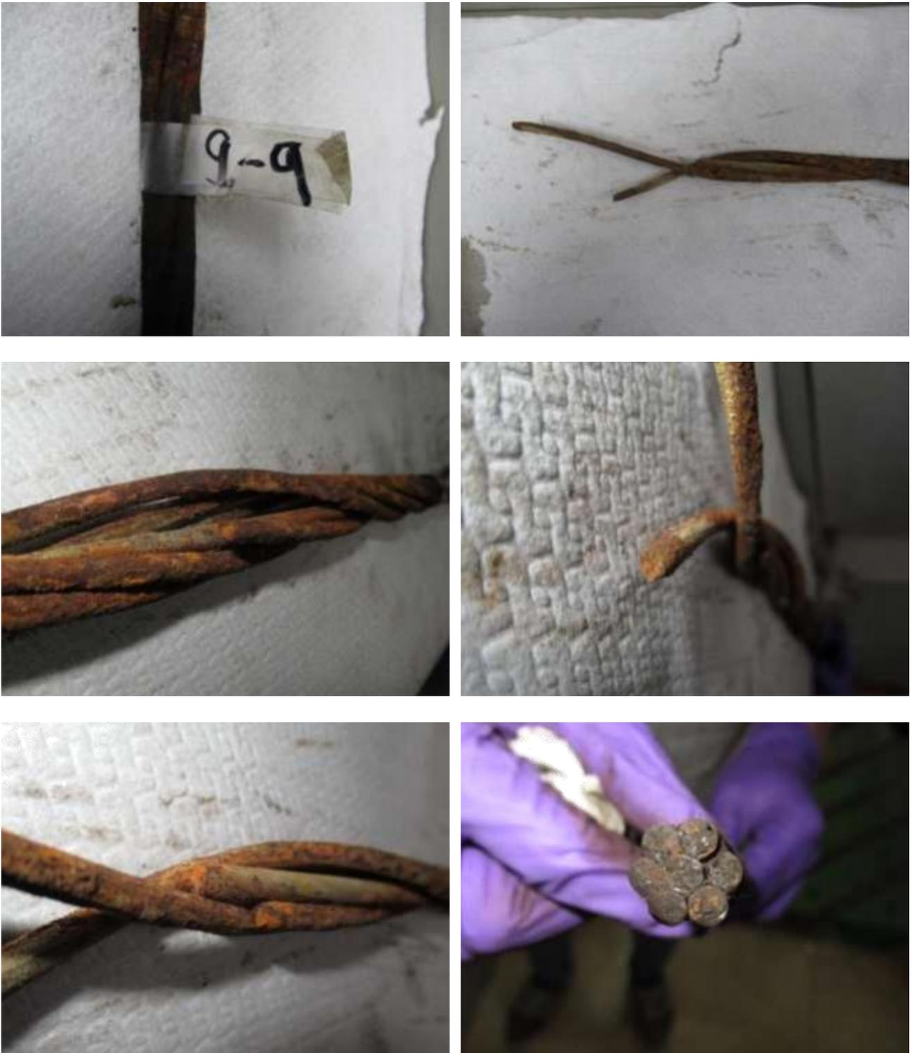
圖113 橋面 9 號錨頭殘留之鋼絞線 9-9 束外觀
