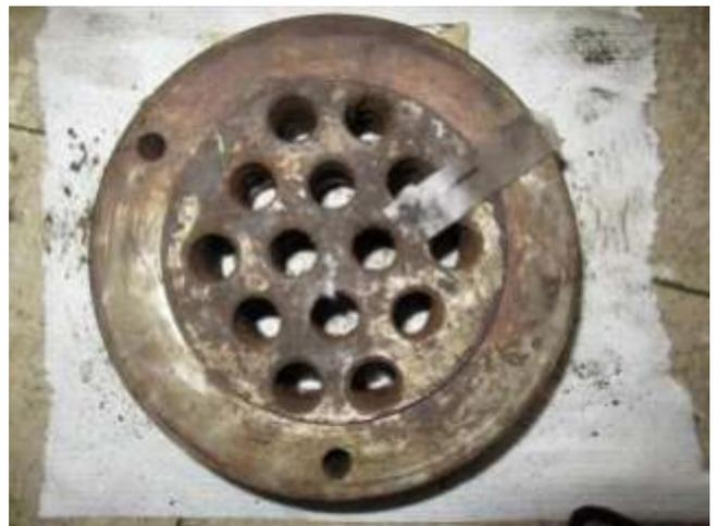
圖82 橋面 11 號錨頭拆解後外觀
