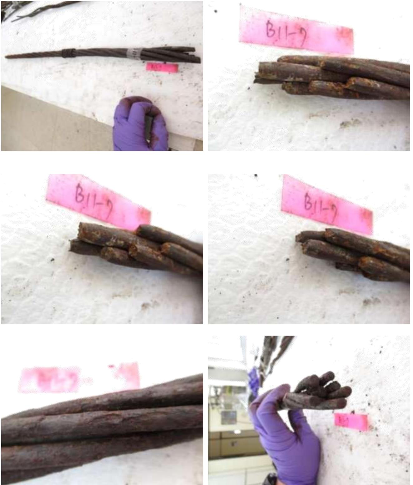
圖137 橋面 11 號錨頭殘留之鋼絞線 11-7 束外觀
