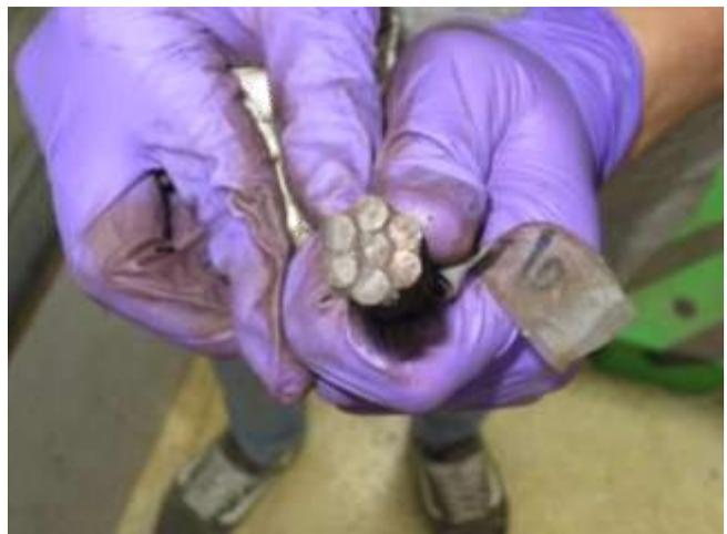
圖128 橋面 10 號錨頭殘留之鋼絞線 10-10 束外觀
