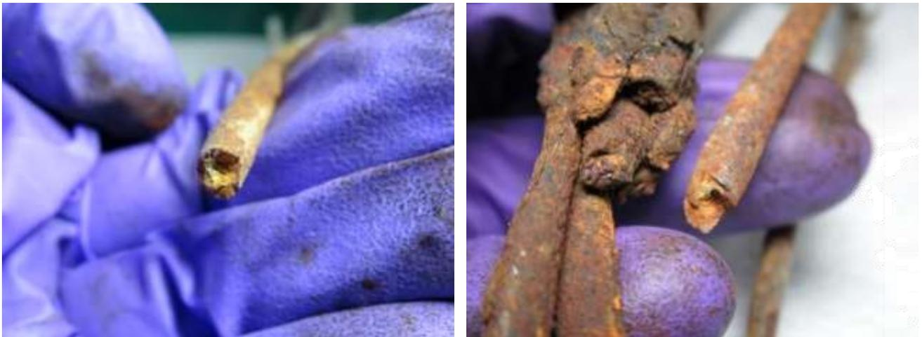
圖172 上拱 12-10 束芯線斷面外觀(左)及與橋面第 12-1 束芯線對應情形(右)
