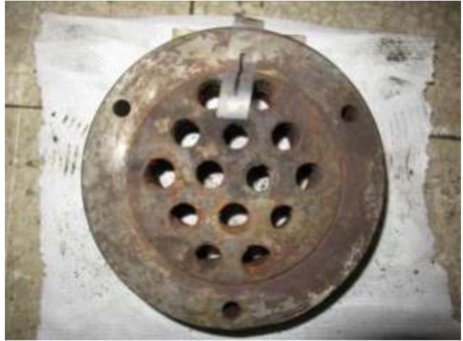
圖78 橋面 7 號錨頭拆解後外觀
