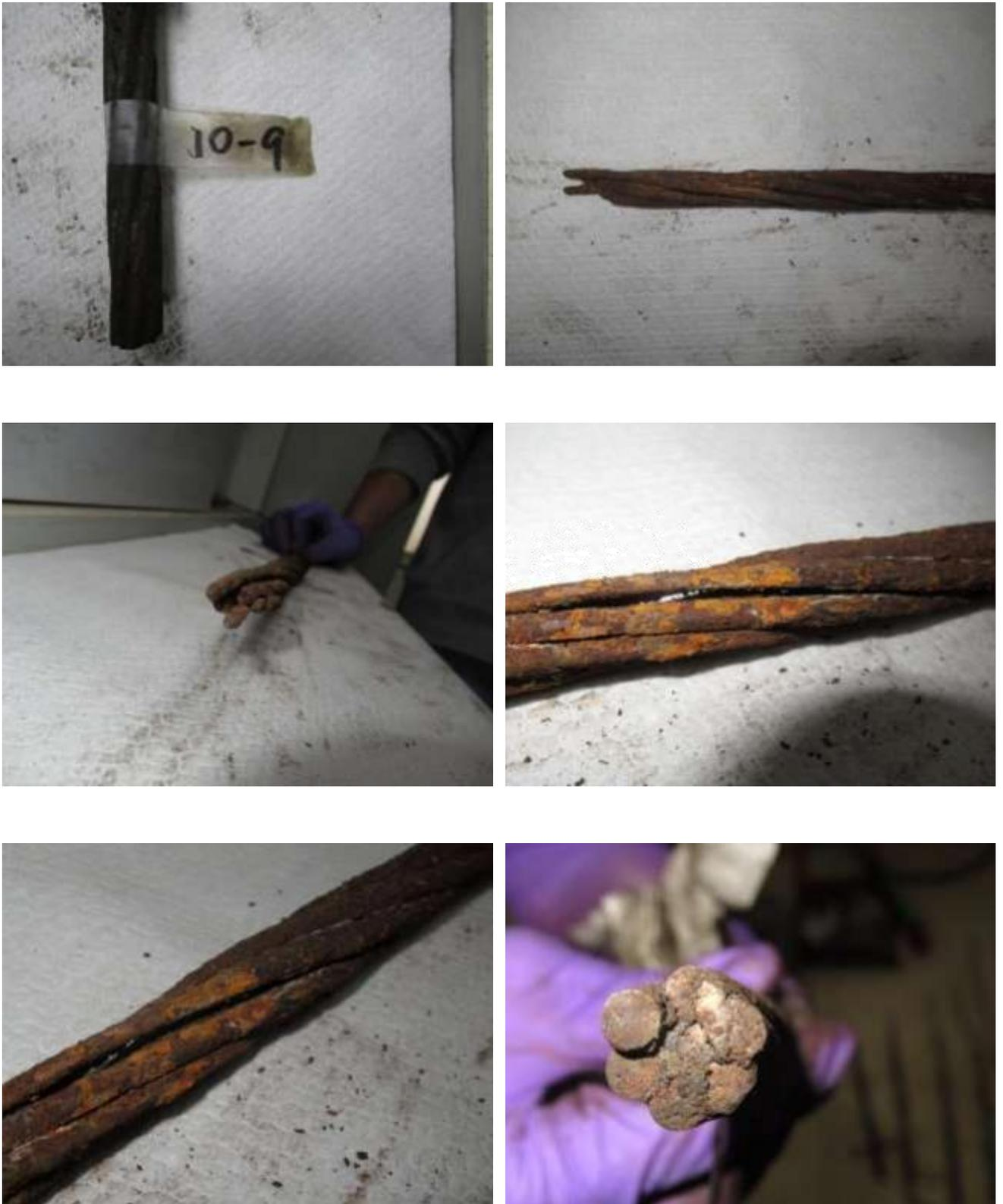
圖127 橋面 10 號錨頭殘留之鋼絞線 10-9 束外觀
