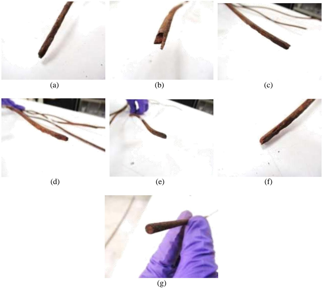
圖32 編號第9股吊索第10束鋼絞線之各鋼線斷面外觀
