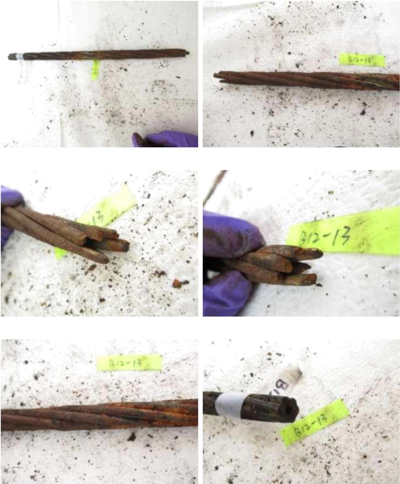
圖154 橋面 12 號錨頭殘留之鋼絞線 12-13 束外觀
