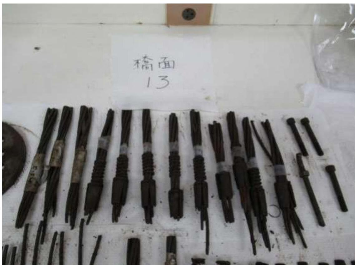
圖155 橋面 13 號錨頭殘留之全部鋼絞線外觀
