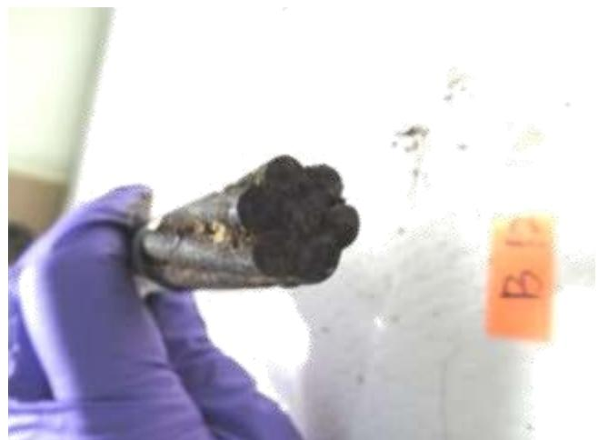
圖142 橋面 12 號錨頭殘留之鋼絞線 12-1 東外觀
