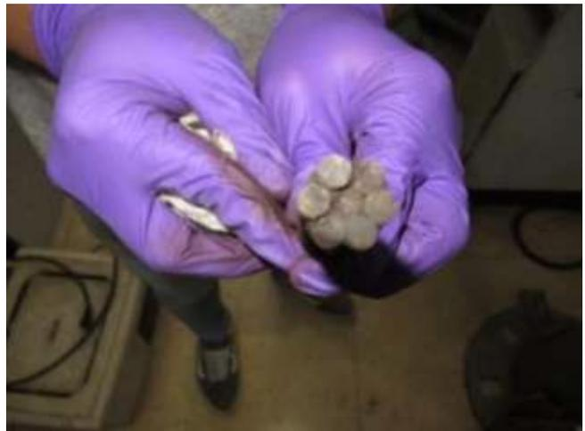
圖112 橋面 9 號錨頭殘留之鋼絞線 9-8 束外觀
