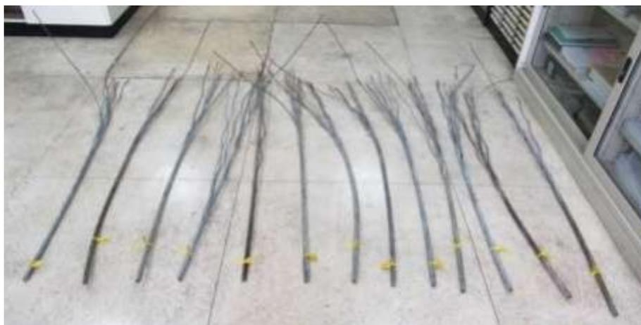
圖20 編號第 12 股吊索之鋼絞線外觀
