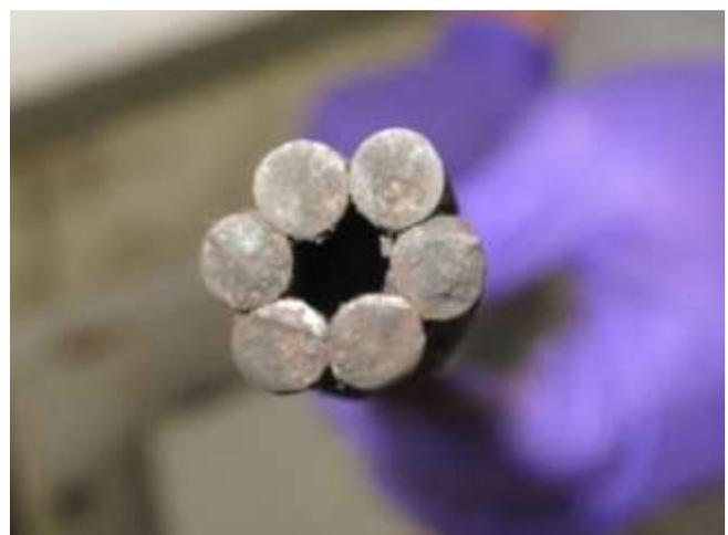
圖108 橋面 9 號錨頭殘留之鋼絞線 9-4 束外觀
