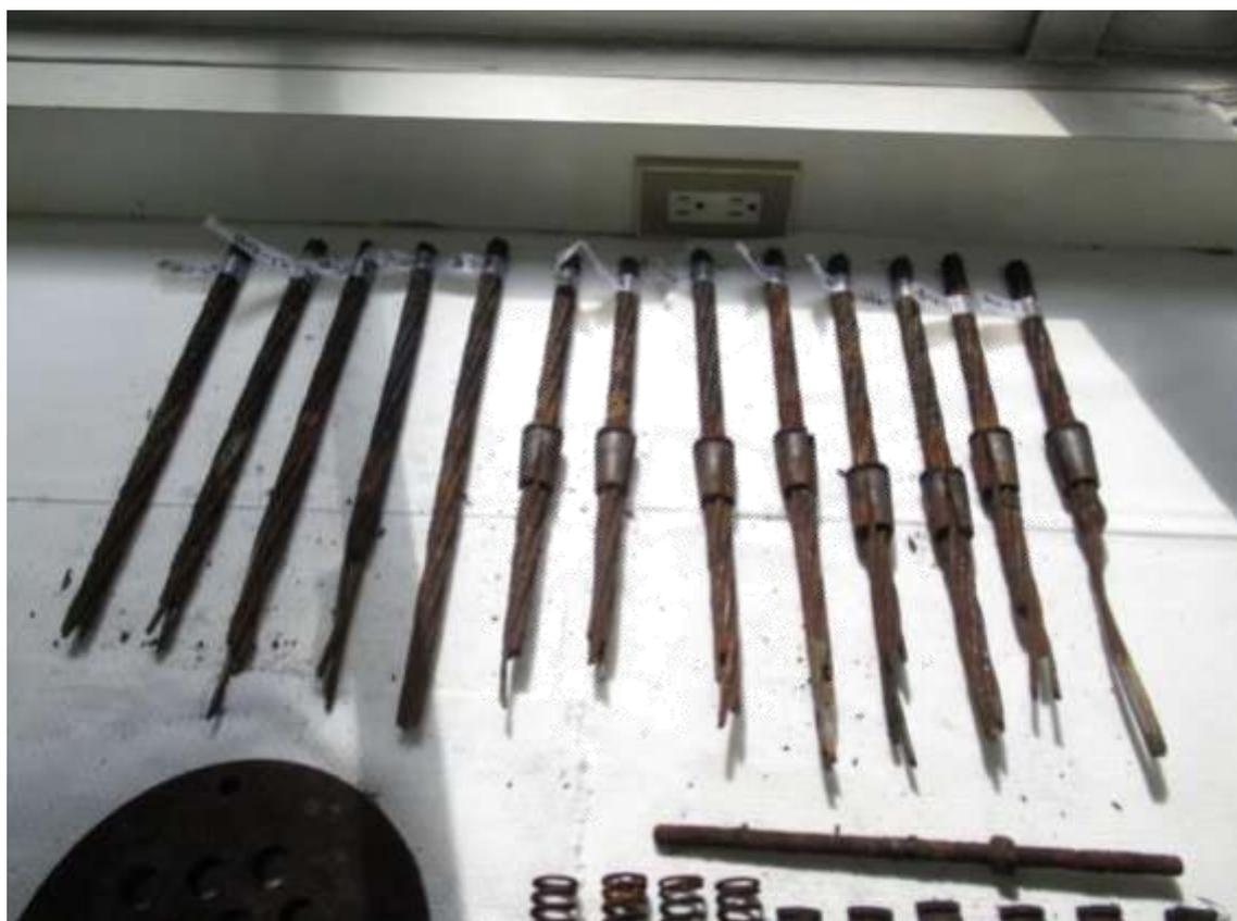
圖141 橋面 12 號錨頭殘留之全部鋼絞線外觀
