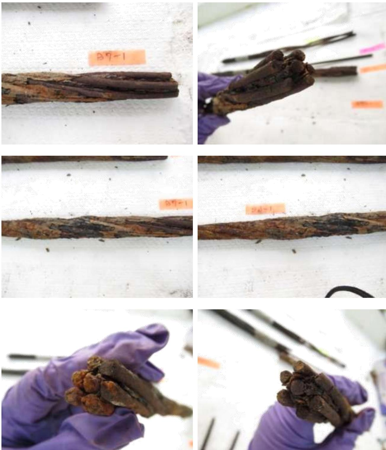
圖99 橋面 7 號錨頭殘留之鋼絞線 7-1 束外觀
