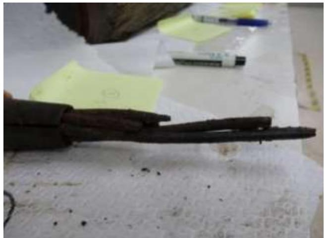
圖158 橋面 13 號錨頭殘留之鋼絞線 13-3 東外觀
