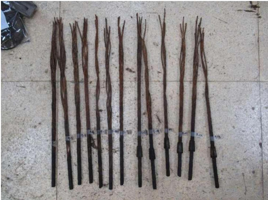
圖104 橋面 9 號錨頭殘留之全部鋼絞線外觀
