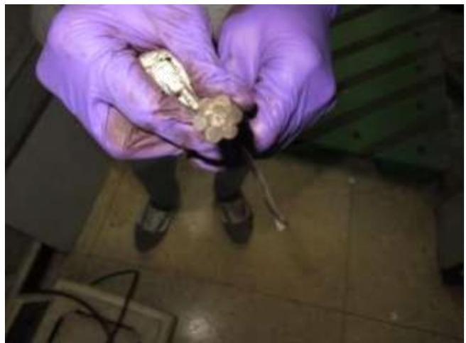
圖126 橋面 10 號錨頭殘留之鋼絞線 10-8 束外觀
