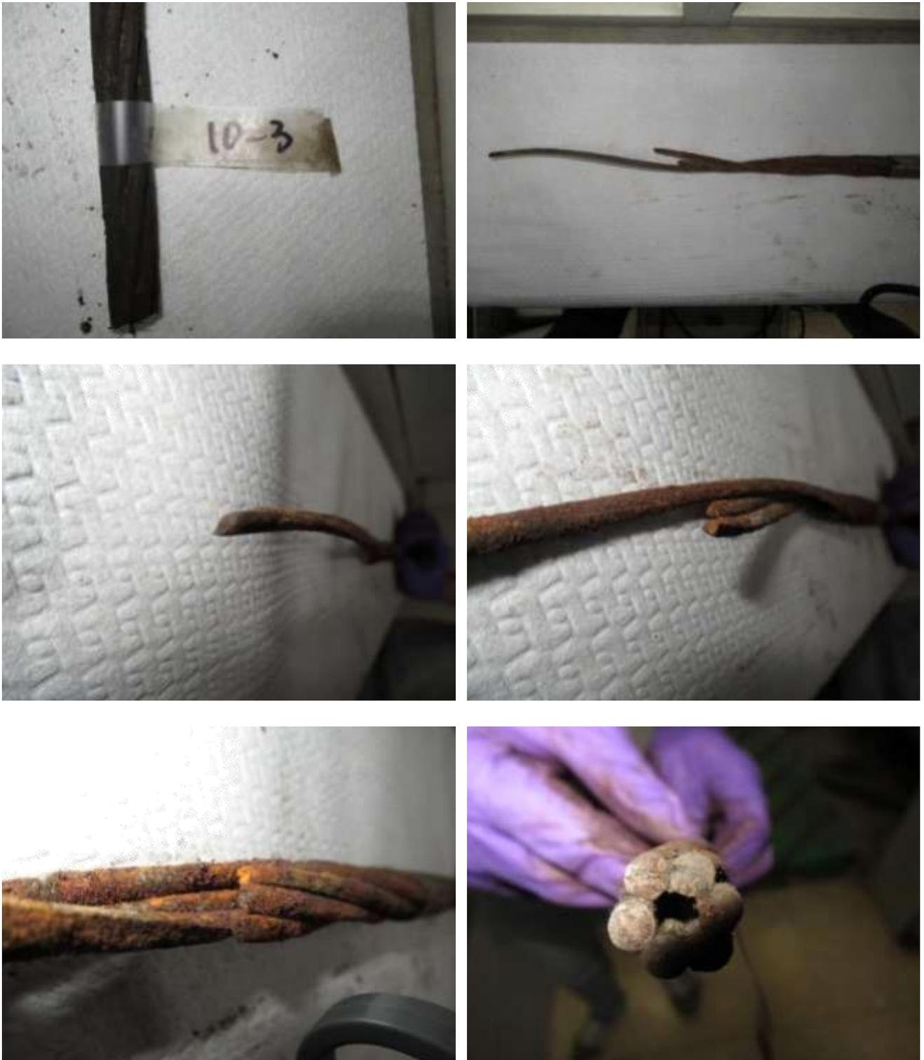
圖121 橋面 10 號錨頭殘留之鋼絞線 10-3 束外觀
