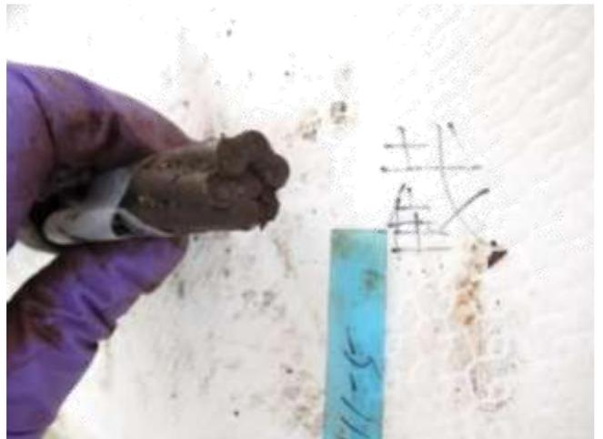
圖135 橋面 11 號錨頭殘留之鋼絞線 11-5 束外觀
