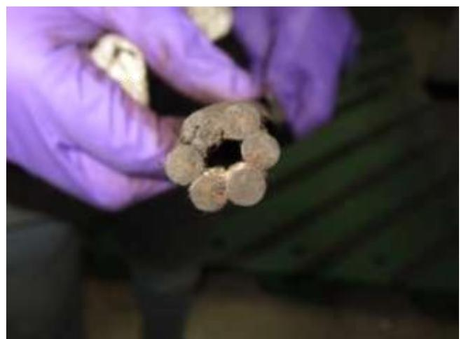
圖116 橋面 9 號錨頭殘留之鋼絞線 9-12 束外觀
