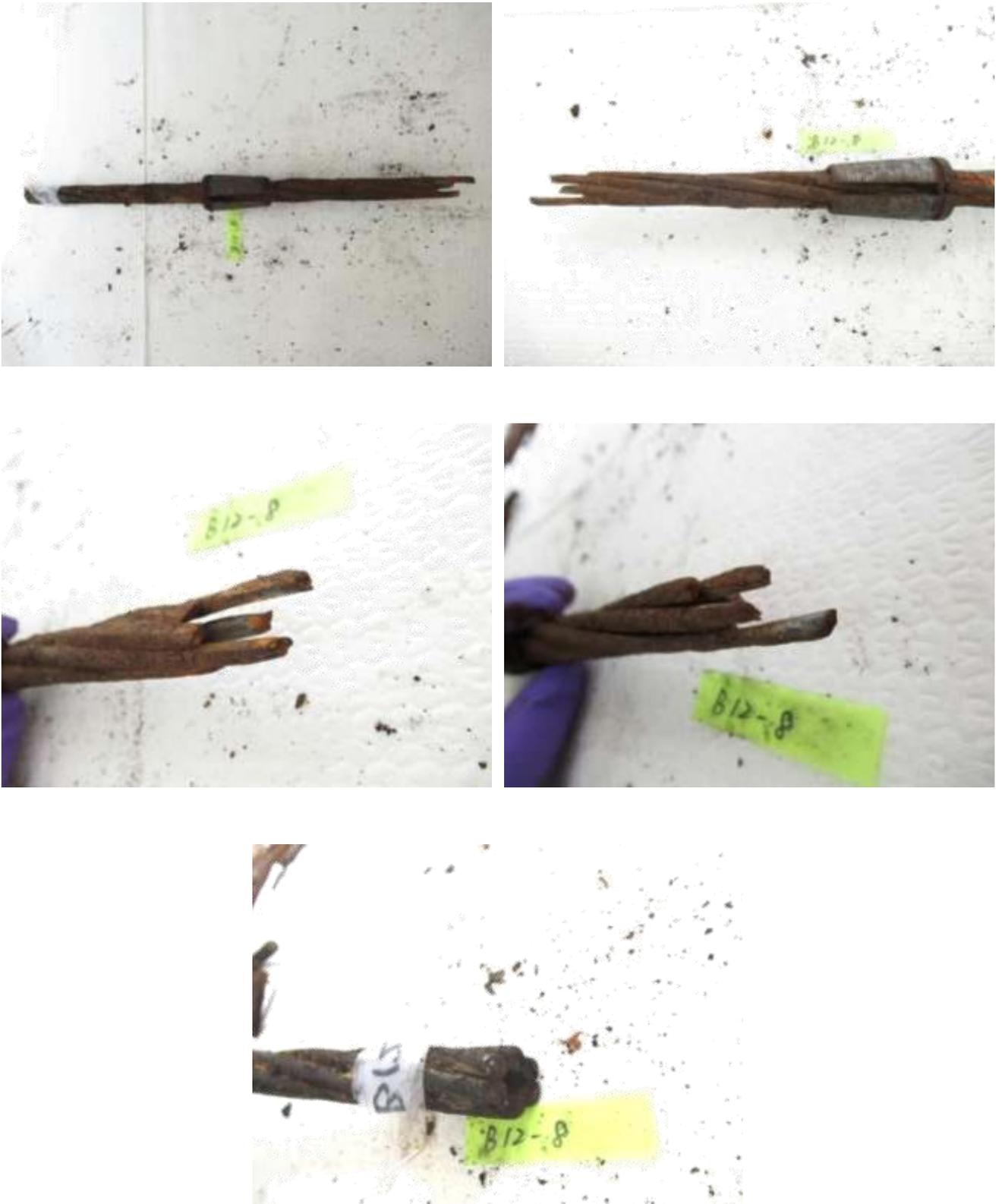
圖149 橋面 12 號錨頭殘留之鋼絞線 12-8 束外觀
