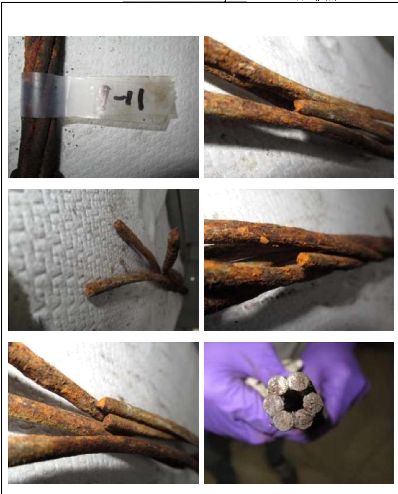
圖115 橋面 9 號錨頭殘留之鋼絞線 9-11 束外觀
