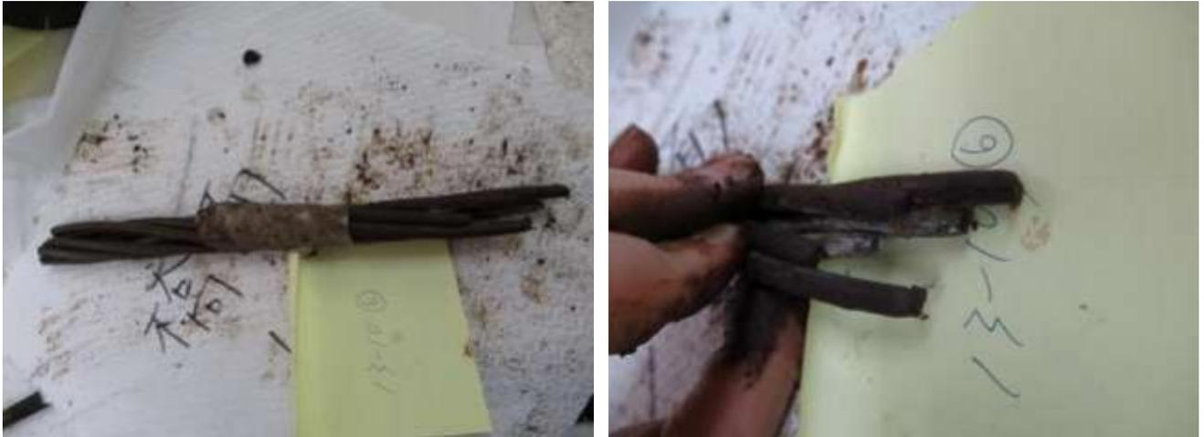
圖165 橋面 13 號錨頭殘留之鋼絞線 13-10 束外觀
