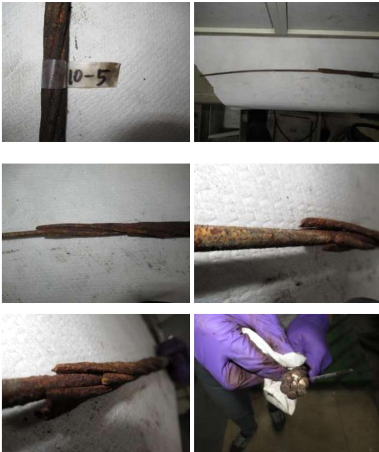
圖123 橋面 10 號錨頭殘留之鋼絞線 10-5 束外觀
