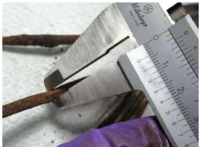
圖180 橋面第 12-1 束之兩條較長邊線鏽蝕中段肉厚及寬度量測情形
