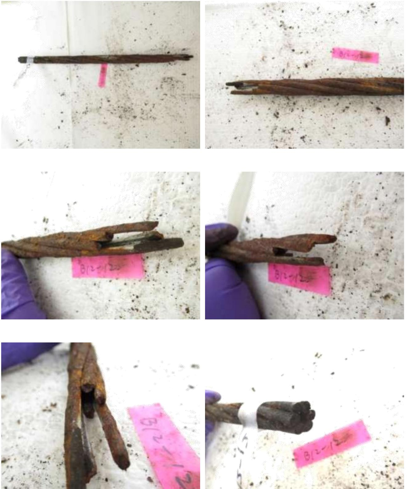
圖153 橋面 12 號錨頭殘留之鋼絞線 12-12 束外觀
