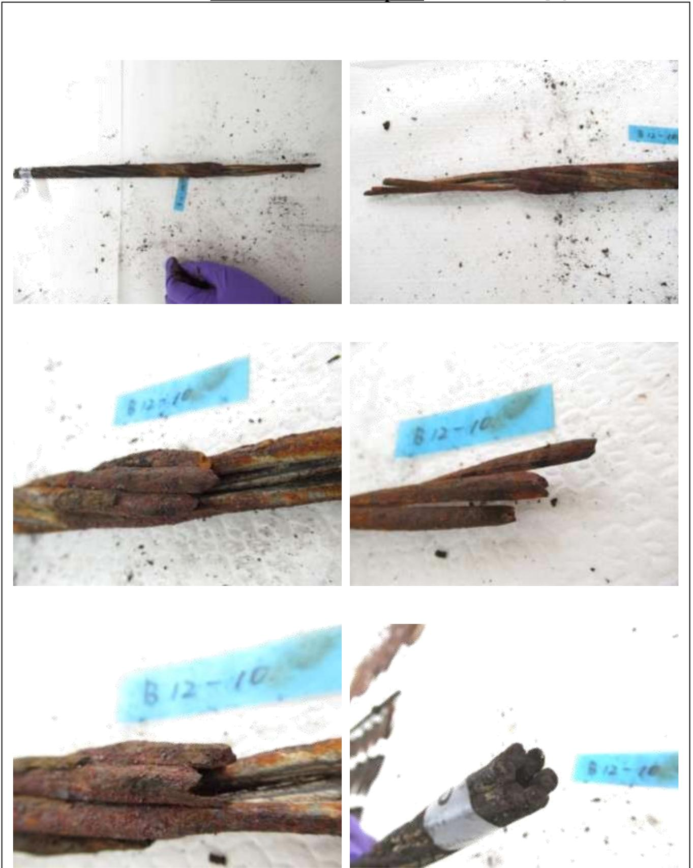
圖151 橋面 12 號錨頭殘留之鋼絞線 12-10 束外觀
