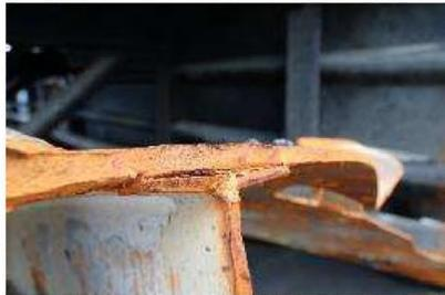
(c) AB3 與 AB4 間垂直向破裂面
