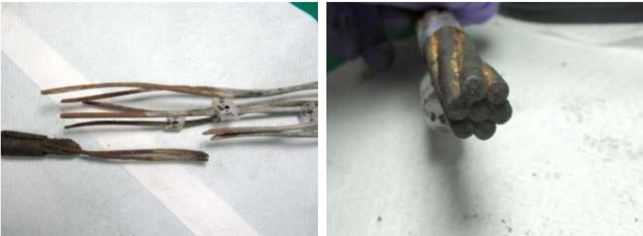
圖170 橋面第 12-1 束與上拱 12-10 束對應外觀(左)及橋面第 12-1 束底部外觀(右)
