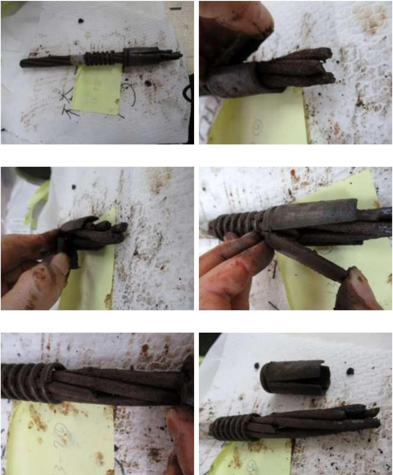
圖162 橋面 13 號錨頭殘留之鋼絞線 13-7 束外觀
