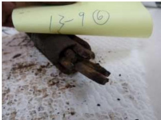
圖164 橋面 13 號錨頭殘留之鋼絞線 13-9 東外觀
