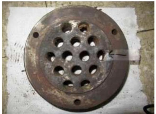
圖77 橋面 6 號錨頭拆解後外觀
