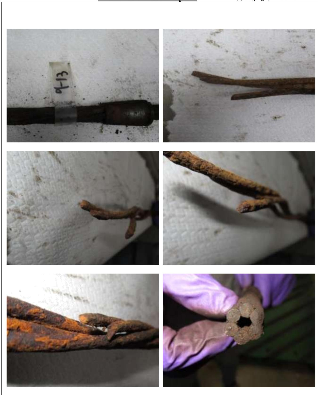
圖117 橋面 9 號錨頭殘留之鋼絞線 9-13 束外觀
