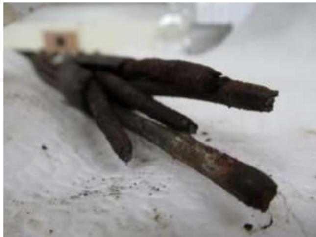
圖156 橋面 13 號錨頭殘留之鋼絞線 13-1 束外觀
