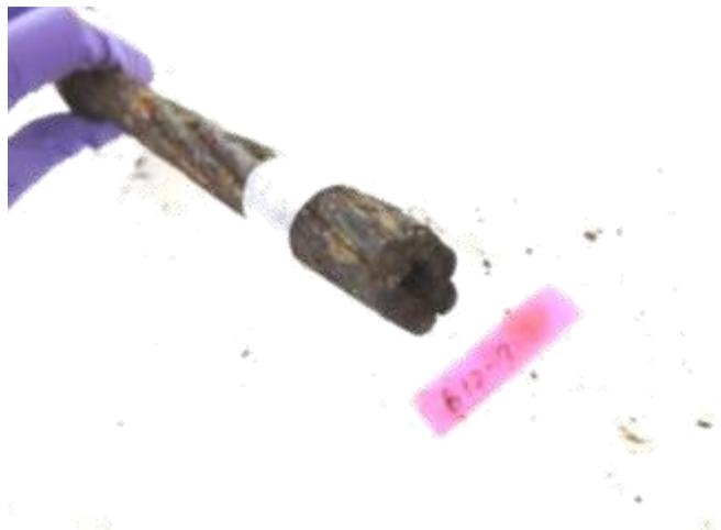
圖148 橋面 12 號錨頭殘留之鋼絞線 12-7 束外觀
