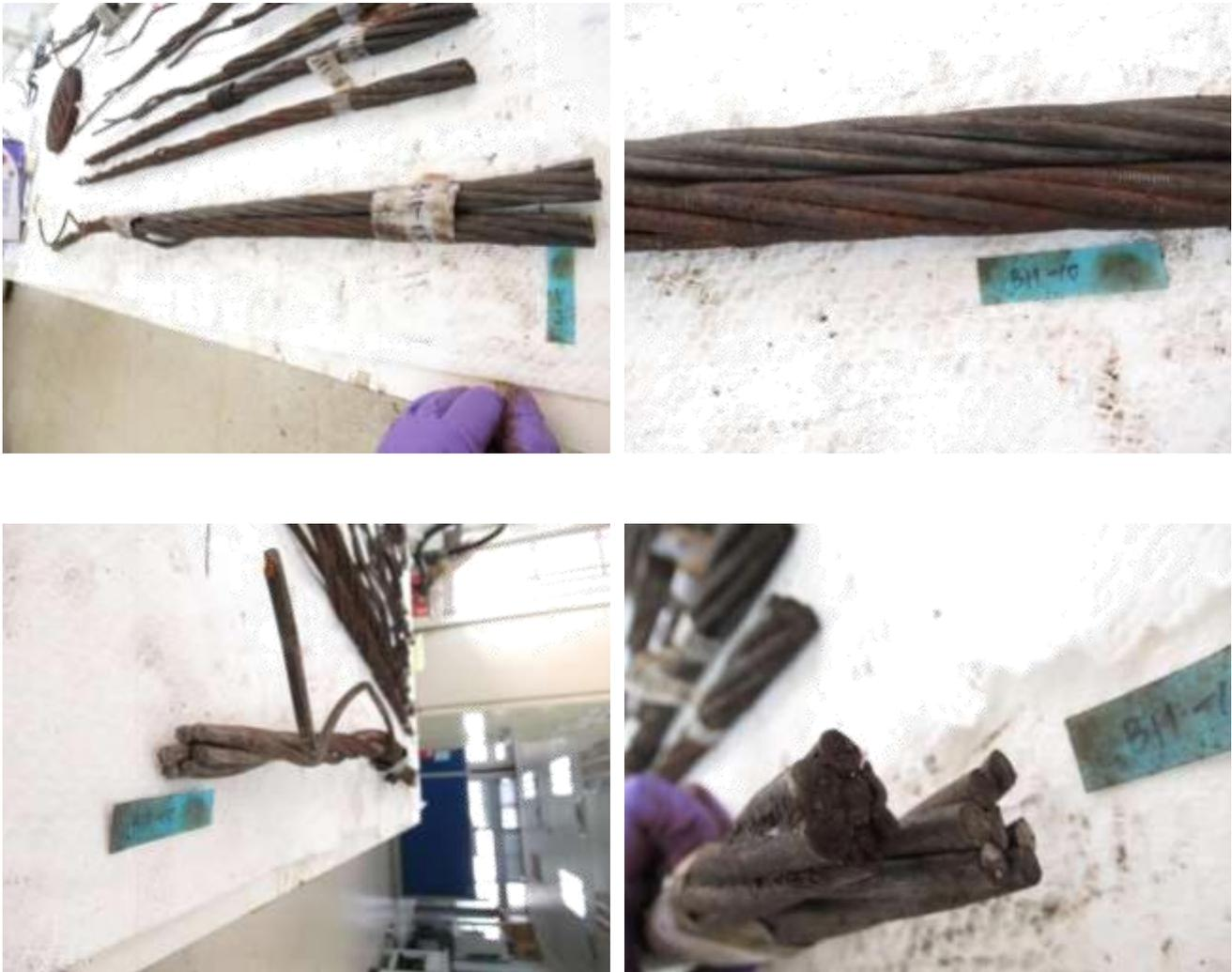
圖140 橋面 11 號錨頭殘留之鋼絞線 11-10 束外觀
