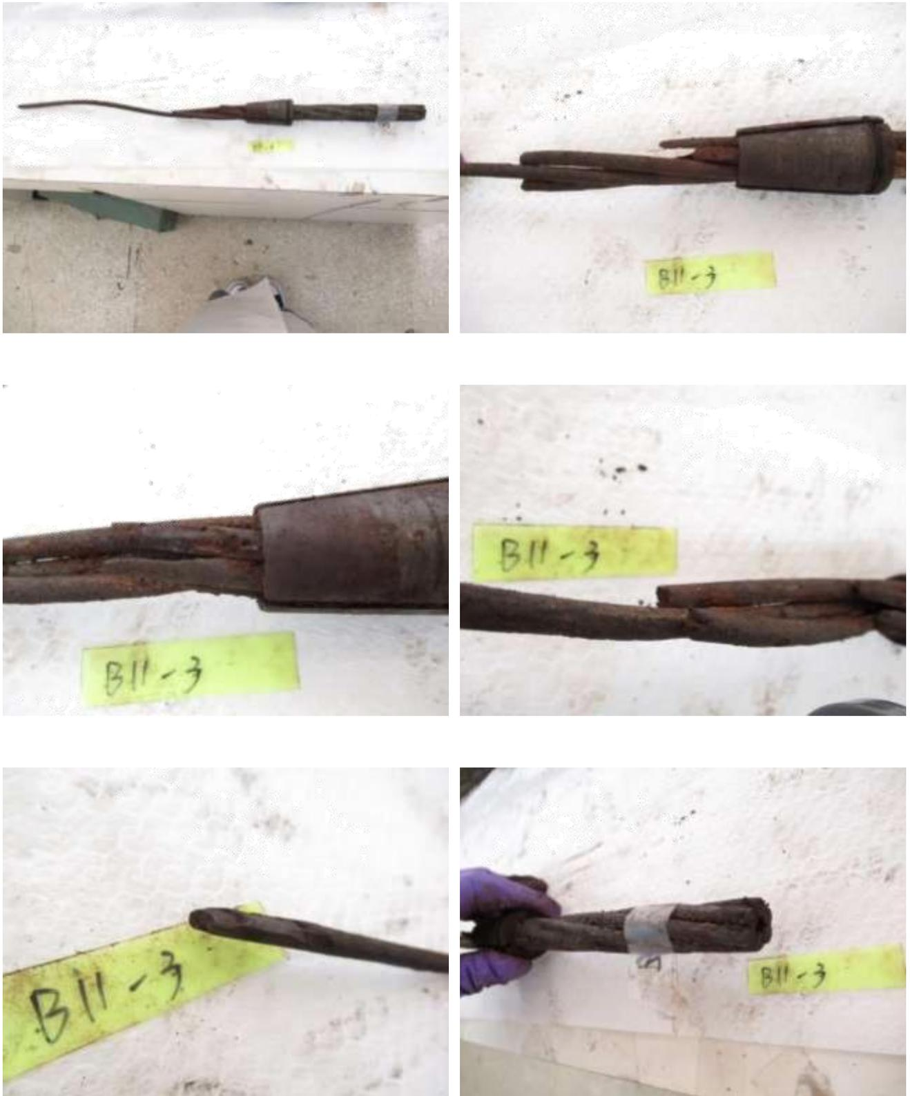
圖133 橋面 11 號錨頭殘留之鋼絞線 11-3 束外觀
