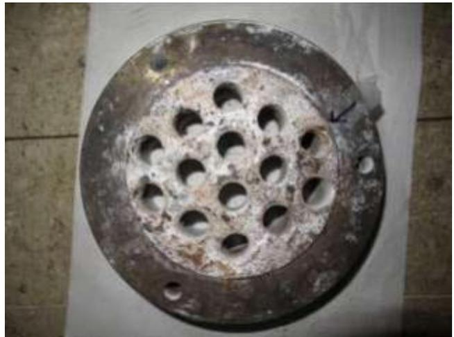
圖73 橋面 2 號錨頭拆解後外觀
