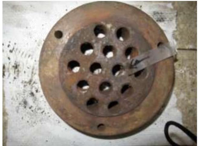
圖81 橋面 10 號錨頭拆解後外觀
