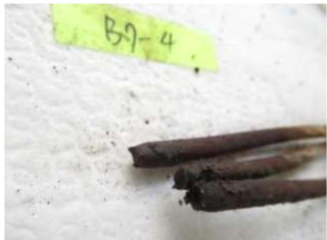
圖102 橋面 7 號錨頭殘留之鋼絞線 7-4 東外觀
