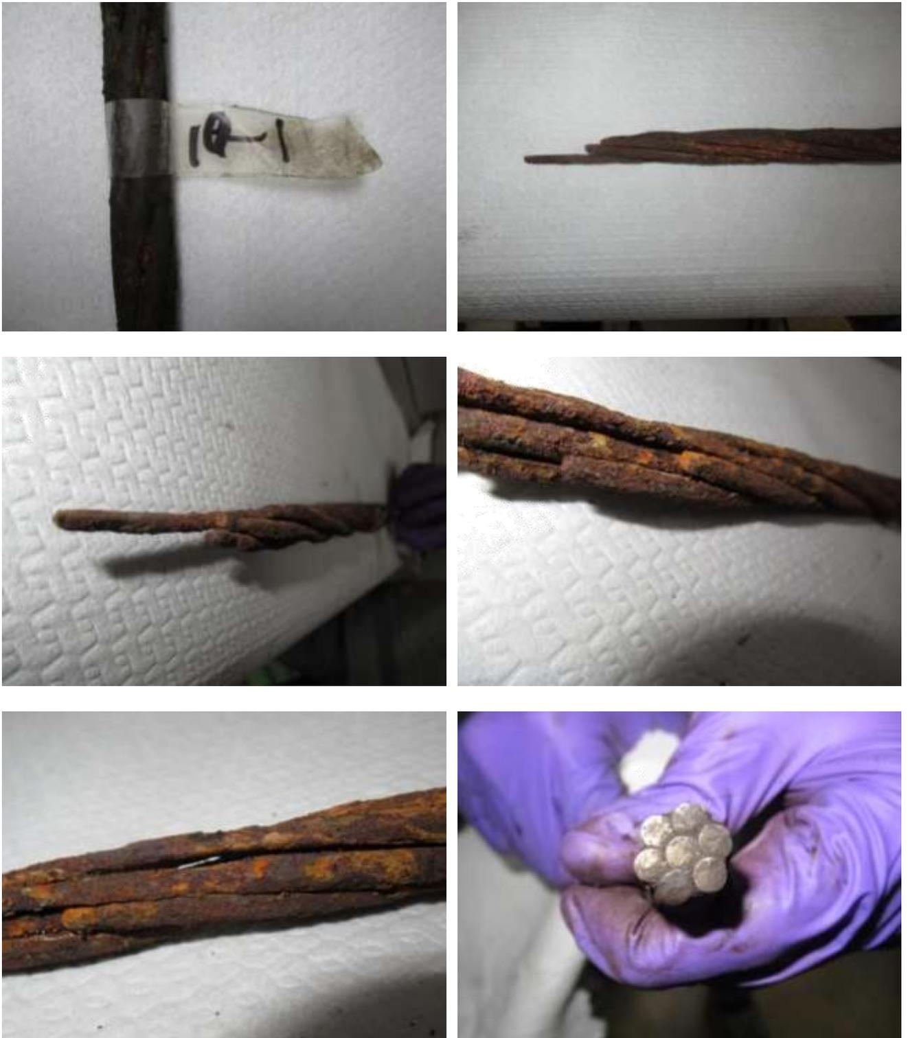
圖119 橋面 10 號錨頭殘留之鋼絞線 10-1 束外觀
