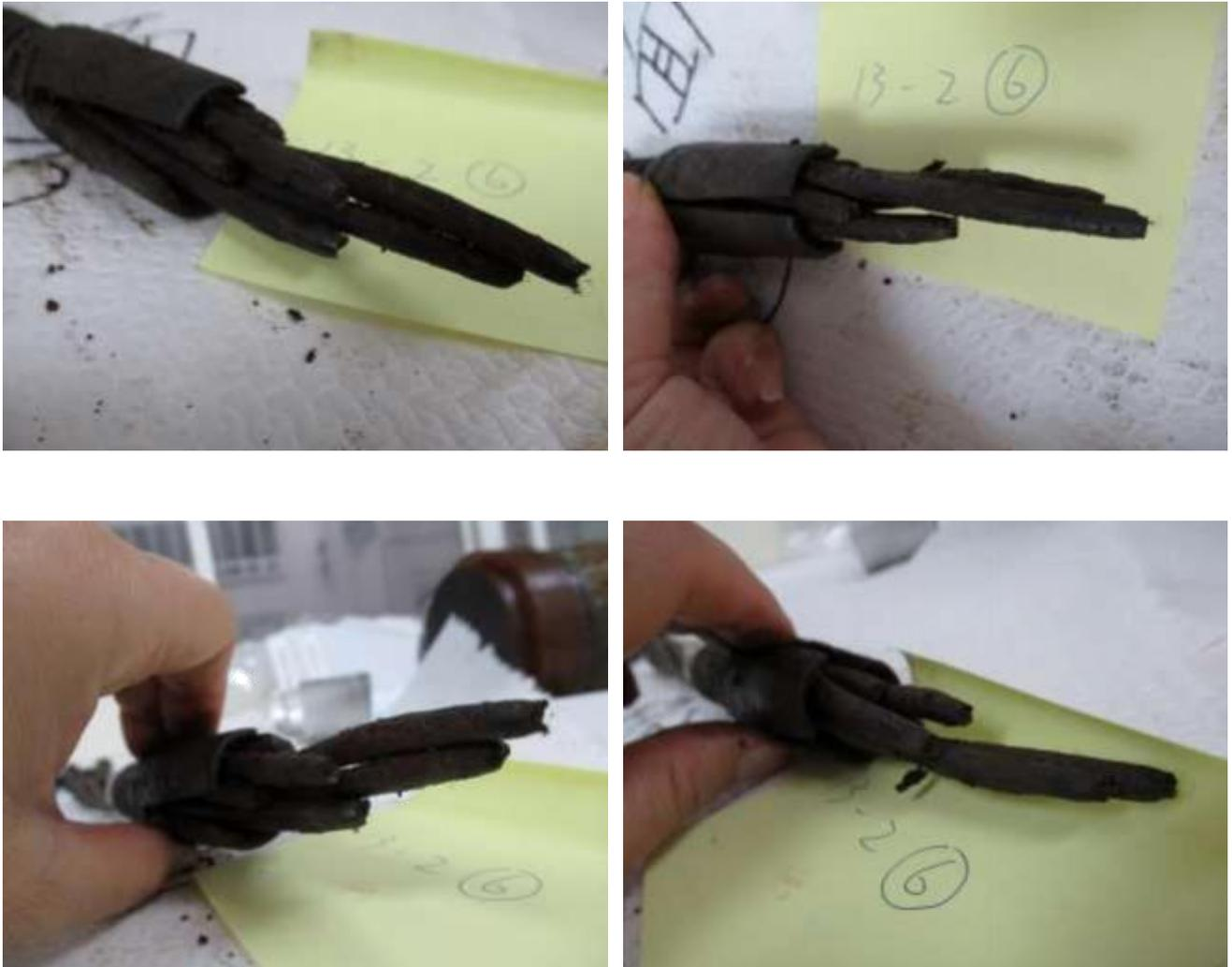
圖157 橋面 13 號錨頭殘留之鋼絞線 13-2 束外觀
