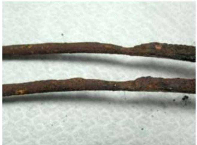
圖179 橋面第 12-1 束之兩條較長邊線鏽蝕中段外觀
