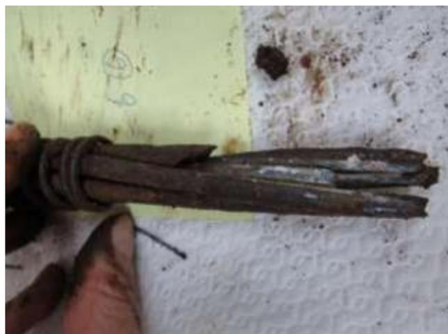
圖161 橋面 13 號錨頭殘留之鋼絞線 13-6 束外觀
