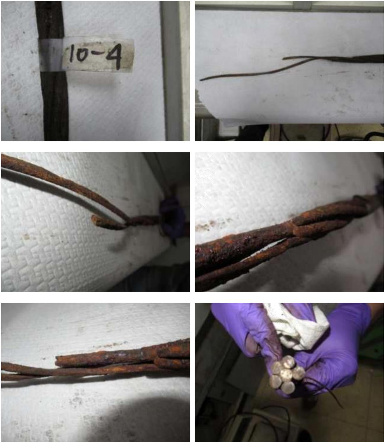
圖122 橋面 10 號錨頭殘留之鋼絞線 10-4 束外觀
