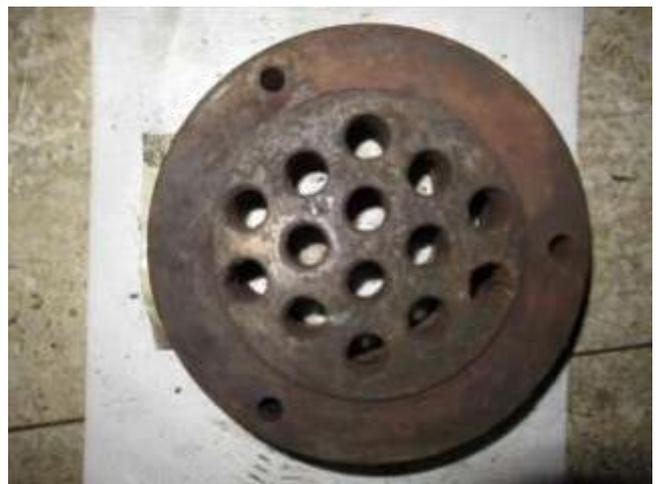
圖76 橋面 5 號錨頭拆解後外觀
