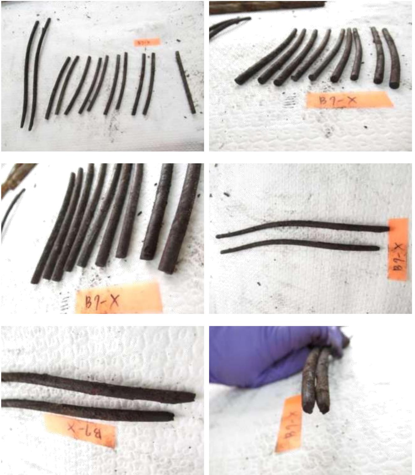
圖103 橋面 7 號錨頭殘留之散落鋼絞線外觀
