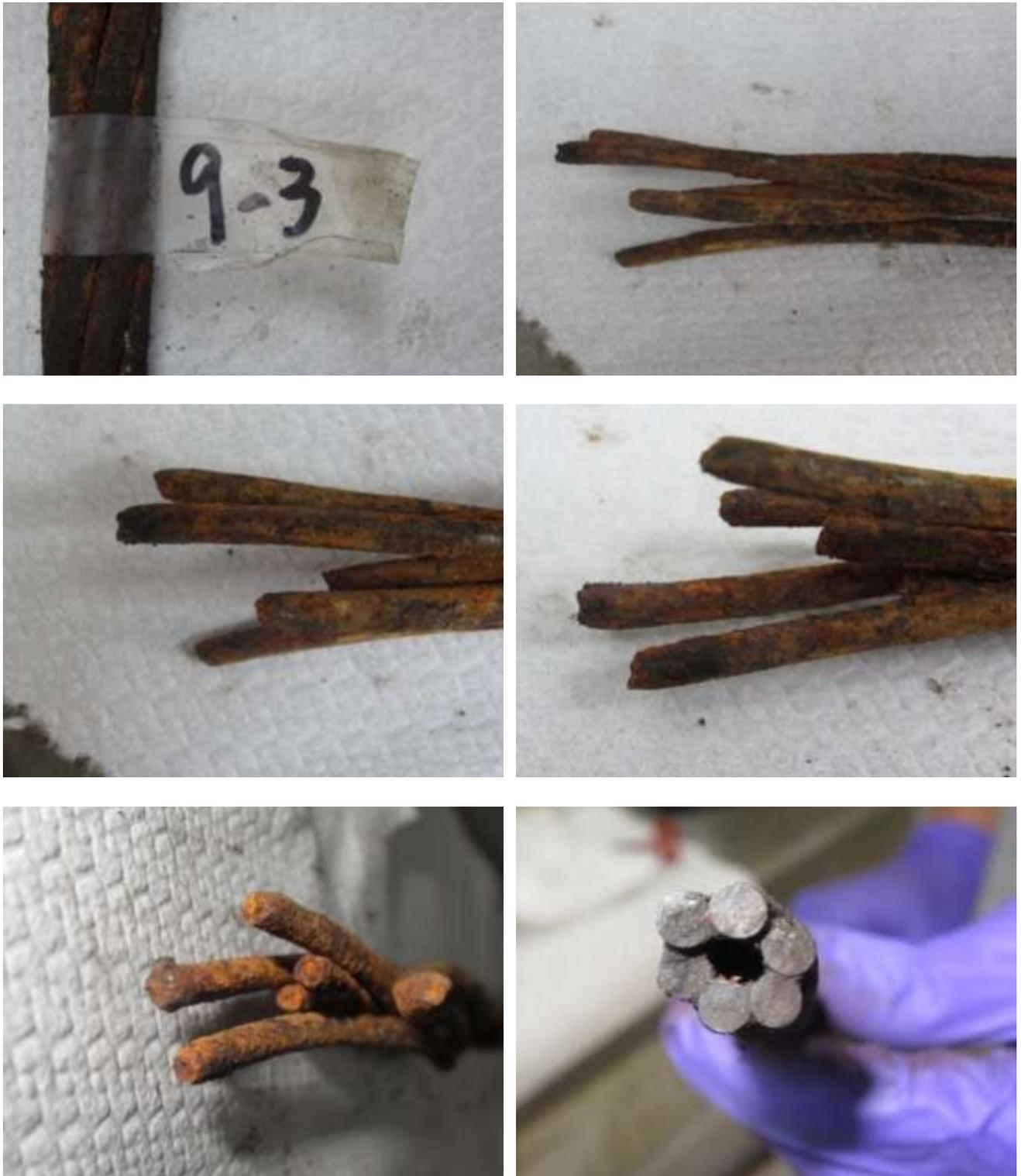
圖107 橋面9號錨頭殘留之鋼絞線9-3束外觀
