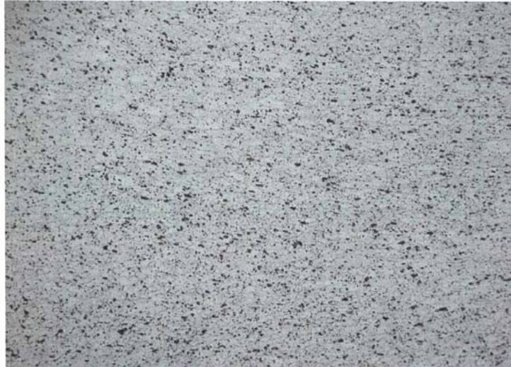
照片六、支撐架試樣直管部的縱向金相，晶粒大小正常 (Kroll's reagent, x 100)
