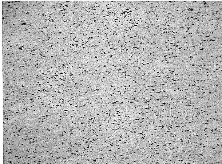
照片五、支撐架試樣耳部的縱向金相，晶粒大小正常 (Kroll's reagent, x 100)
