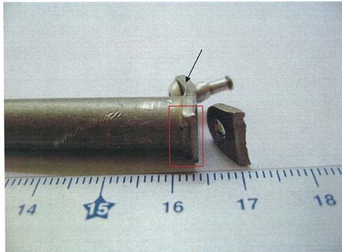
照片三、由另一角度觀察的電纜線支撐架試樣的斷裂情形，箭頭處顯示試樣彎曲
