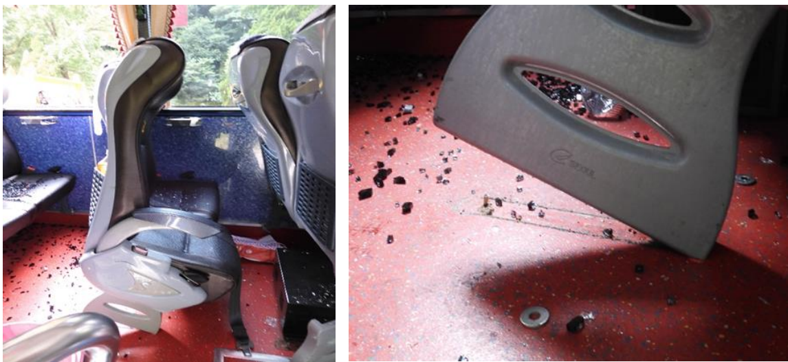
圖 1.12-3 事故車輛座椅脫離及前傾情形
