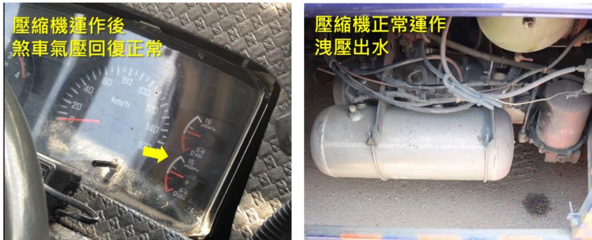
圖 1.13-1 事故車輛測試步驟說明
