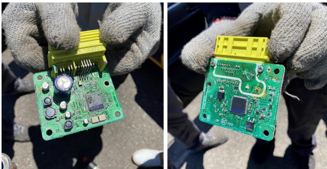
圖 1.9-2 電路板銹蝕情形
