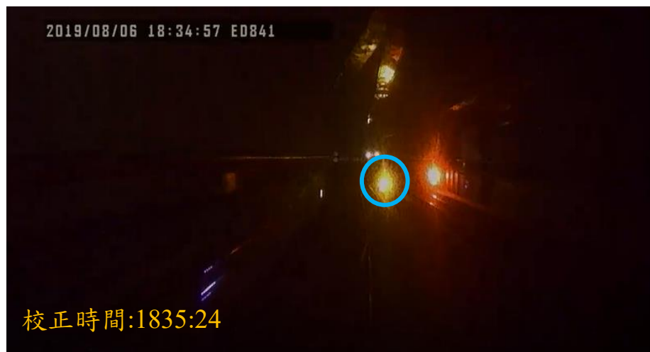
圖 1.12-1 第一閉塞號誌機顯示注意（黃燈）
