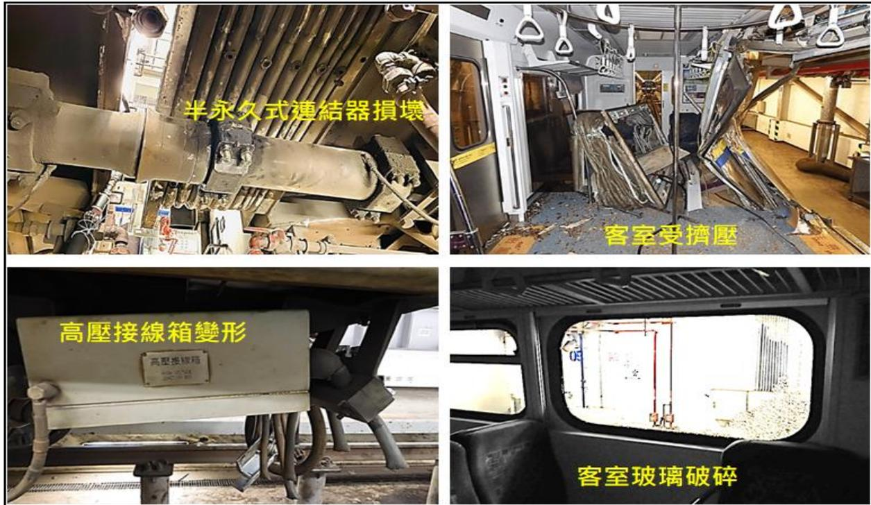
圖 1.2-5 編號 7 車損害情形-2
