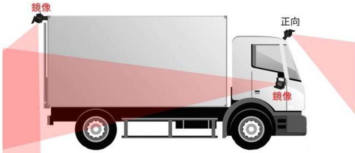
圖 1.11-5 行車視野輔助系統網路示意圖
