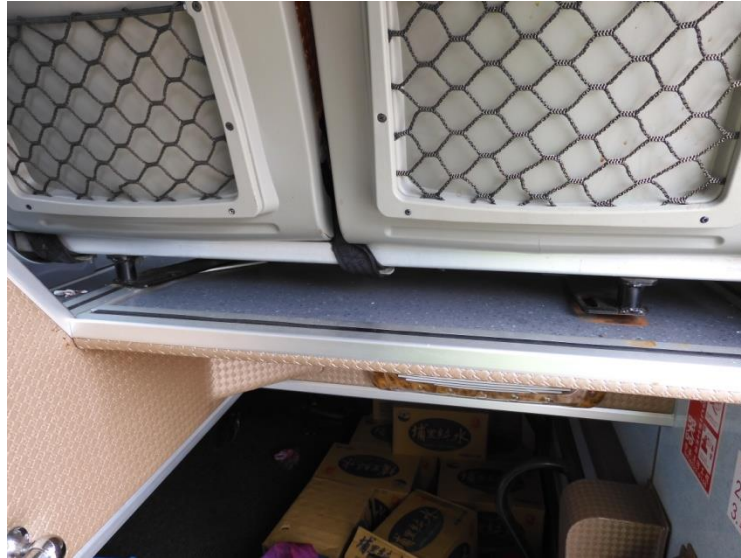
圖 1.12-2 事故車輛 6 排 4 號座椅螺絲鬆脫情形
