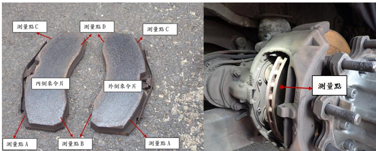
圖 1.3-1 煞車來令片及碟盤檢測點示意圖
