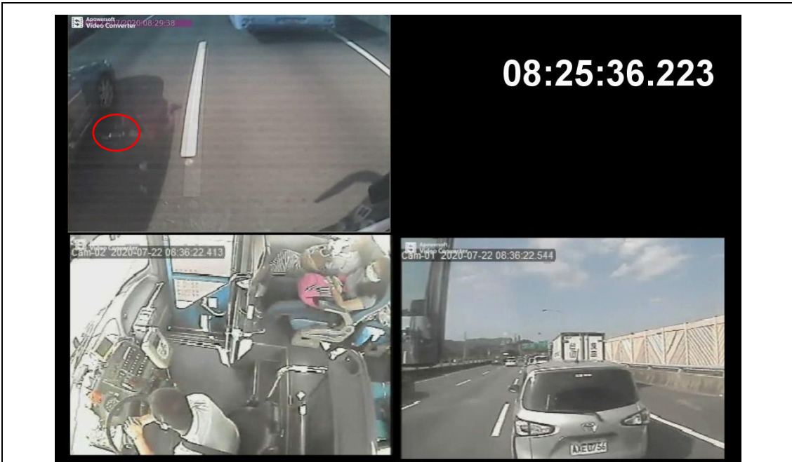
0825:36.223 時，自事故車輛前擋玻璃反射影像可觀察到駕駛員突然向左操作，之後車輛駕駛座有不明物體飛出(1)
