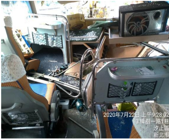
圖 1.3-4 事故車輛損壞情形
