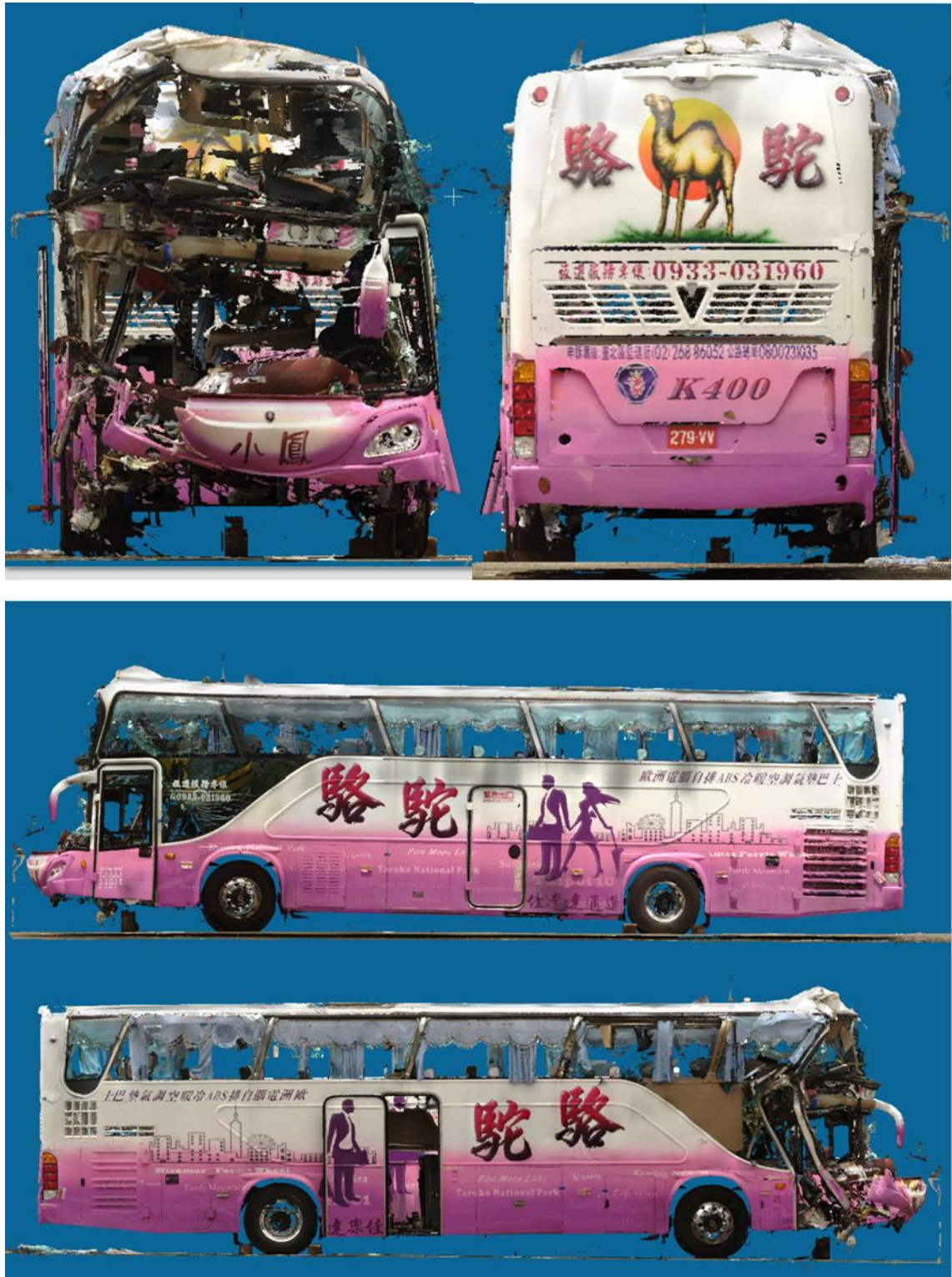
圖 1.13-2 事故車輛高精度 LiDAR 掃描成果圖
