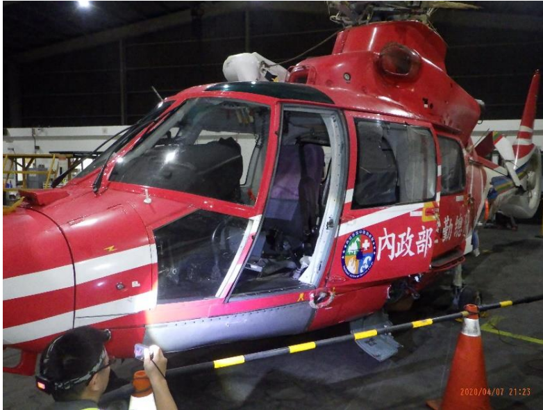
圖 1.12-2 機身左側受損情形
