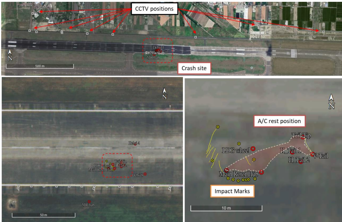
圖 1.12-13 現場測量結 3 果及 CCTV 位置
