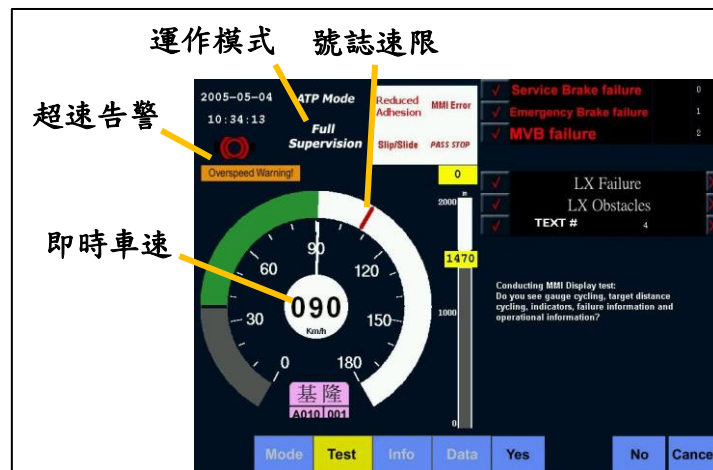
圖 1.9-2 車載 ATP 螢幕畫面說明
