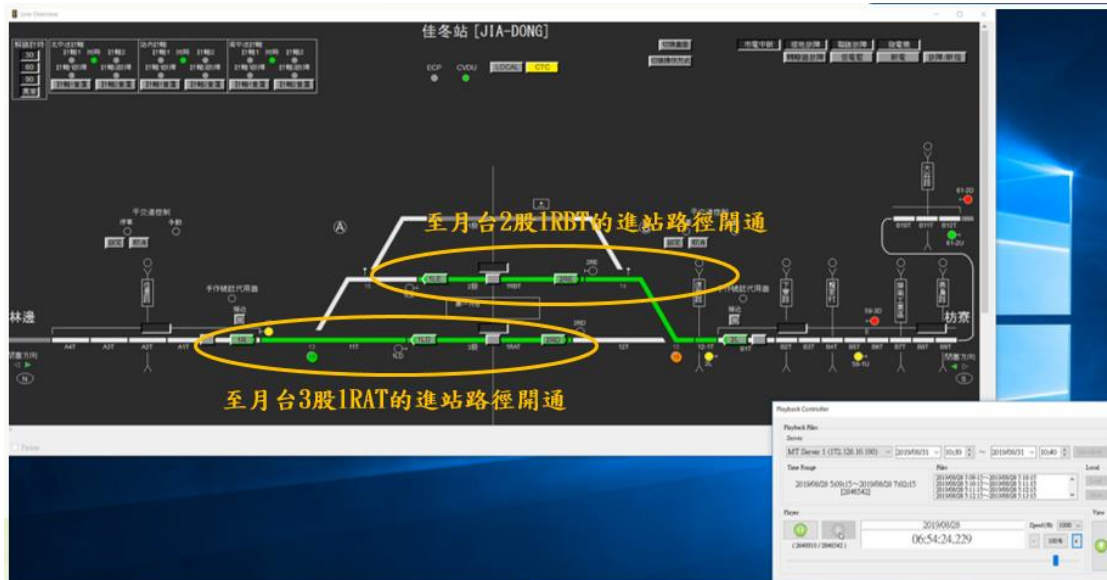
圖 1.9-43 月台 2 股軌道 1RBT 與月台 3 股軌道 1RAT 進站路徑開通
