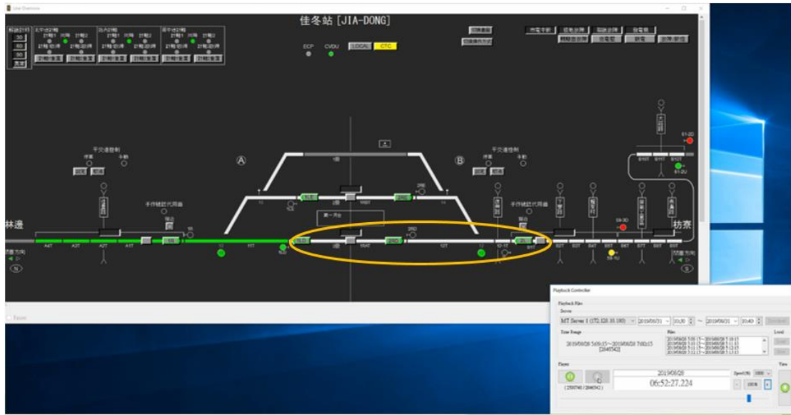
圖 1.9-41 進站號誌機 2L 至站內月台 3 股軌道路徑取消
