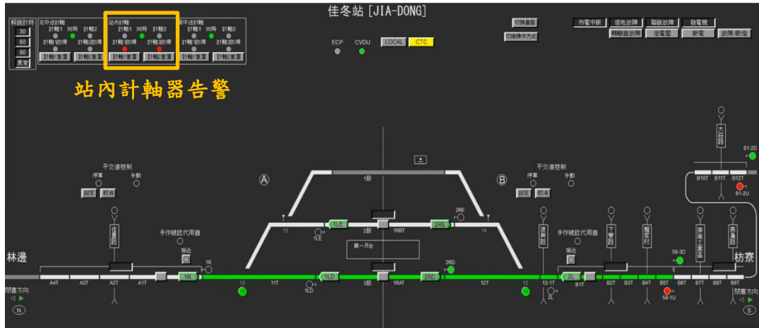
圖 1.9-5 佳冬站之 CVDU 號誌調度與計軸器告警畫面
