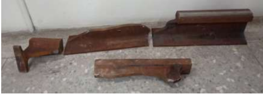
圖 1.1-2 鋼軌斷裂（分離）
