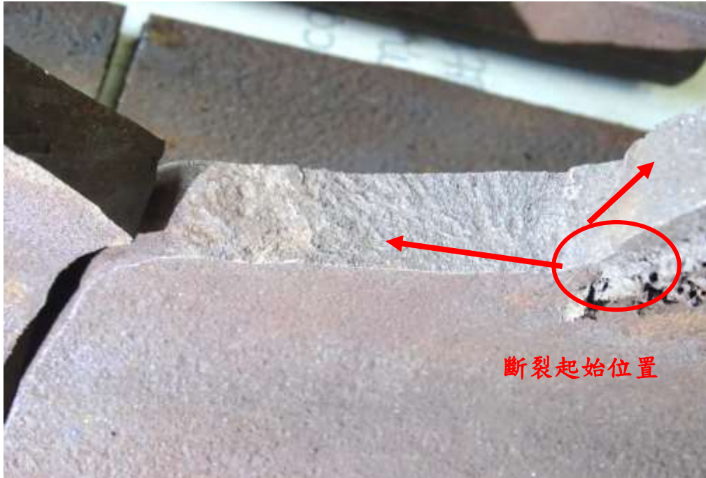
照片六：鋼軌斷裂起始位置位於軌腹表面訊號線接點處（圓圈處），破裂成長由訊號線接
