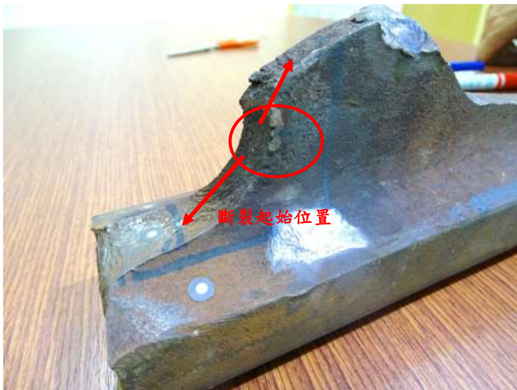
照片十四：斷裂鋼軌之破裂面呈現快速破壞型態
