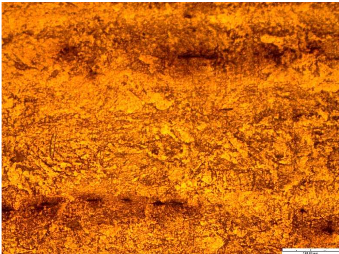
照片二十六：鋼軌母材金相組織為變韌鐵組織與肥粒鐵組織，倍率 200X
