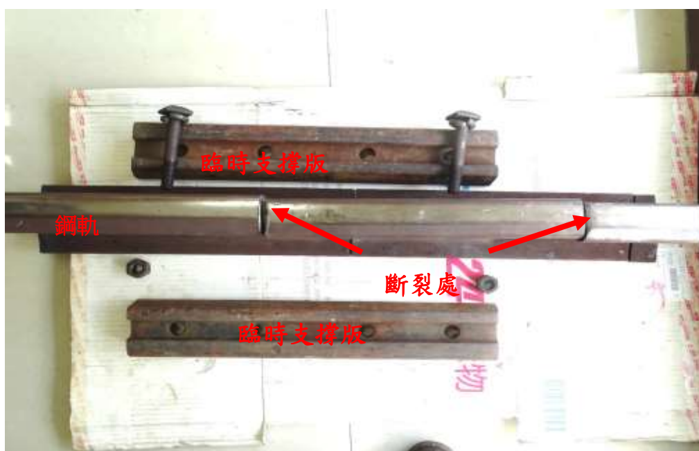
照片二：斷裂鋼軌組合後外觀
