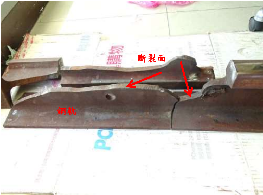
照片四：斷裂鋼軌斷面呈現快速破壞形貌
