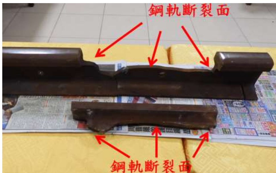
圖 1.11-2 鋼軌斷裂面生鏽
