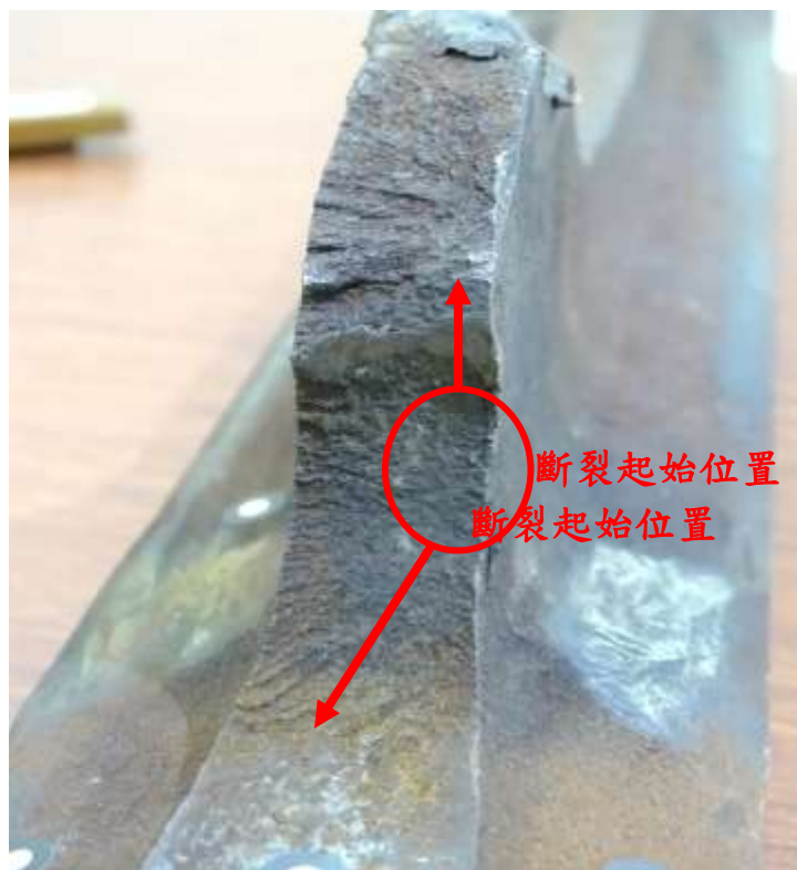
照片十三：斷裂脫軌之鋼軌斷裂起始位置位於表面訊號線接點處（圓圈處），破裂成長由訊號線接點往鋼軌內部成長延伸
