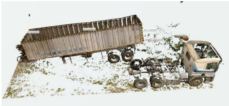
圖 4.4.1-1 以 FARO 進行事故車斗尺寸丈量
