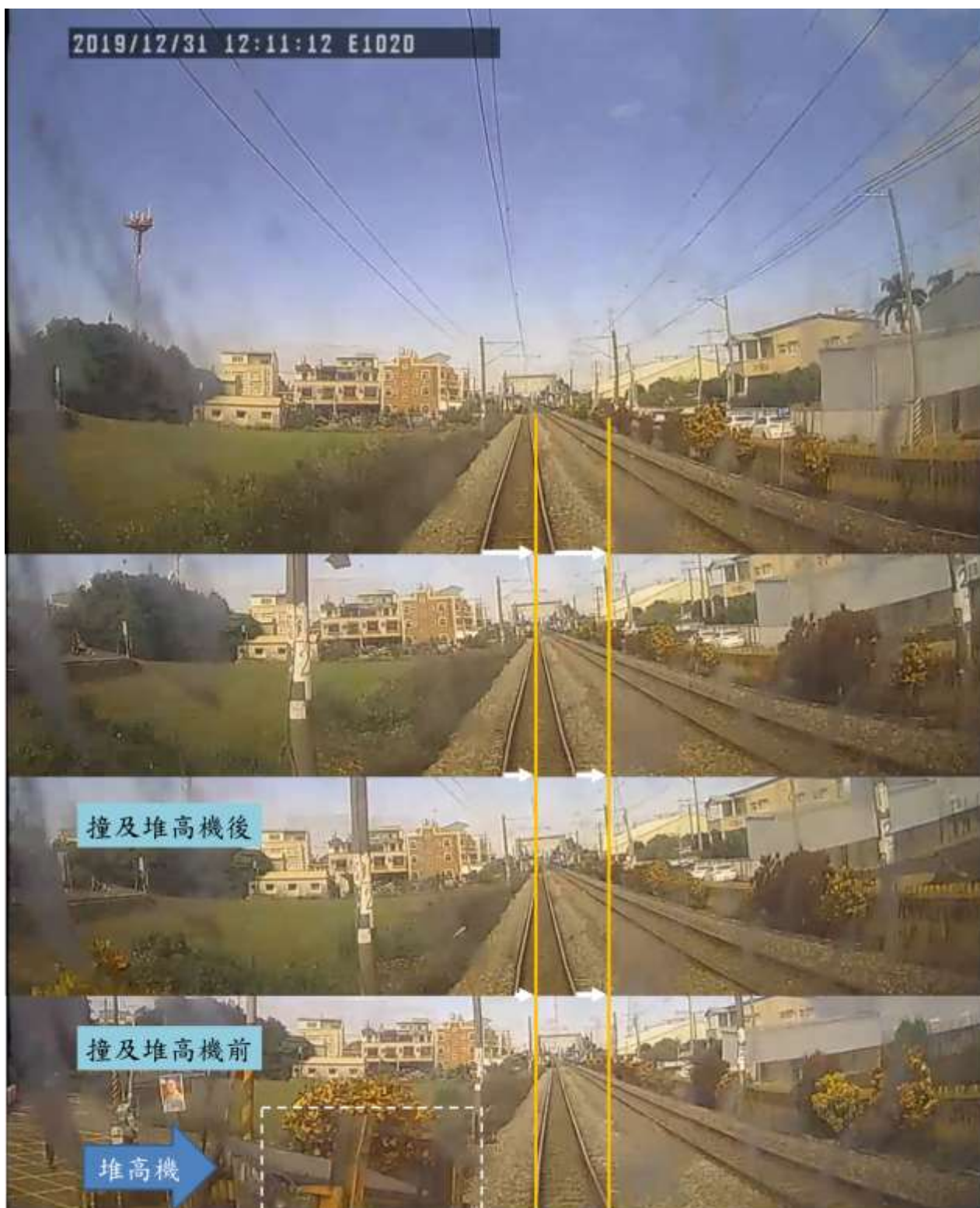
圖 1.11-3 事故列車撞及堆高機後機車頭偏移
