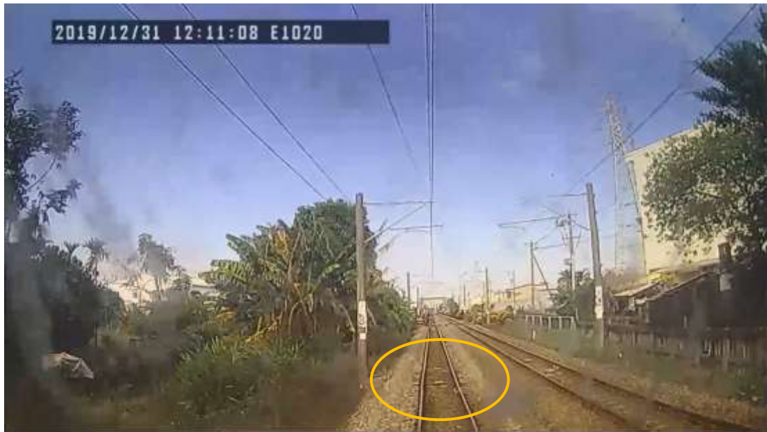
圖 1.11-1 第 118 次車通過新興巷平交道前 ATP 地上感應子
