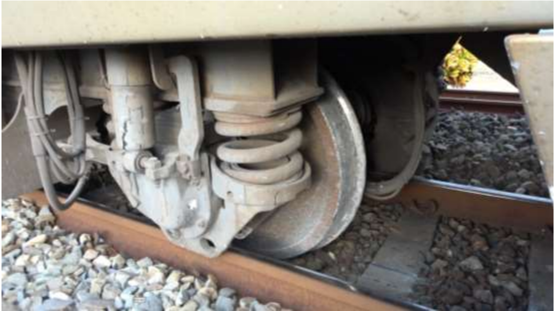
圖 1.1-6 E1020 機車第二軸出軌
