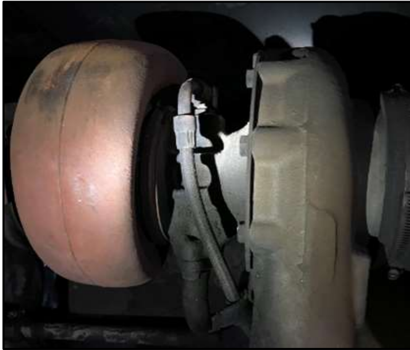
圖 1.11-2 事故列車其它渦輪增壓機（未裝隔熱罩）
