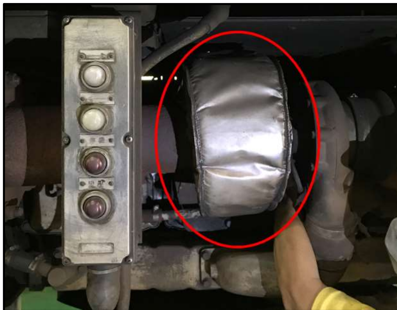
圖 1.11-1 事故列車使用之渦輪增壓機隔熱罩
