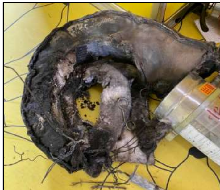
圖 1.1-2 渦輪增壓機護罩火災殘骸
