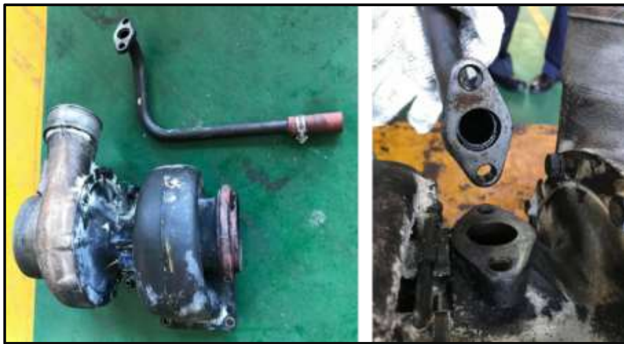
圖 1.7-6 潤滑油回油管與渦輪增壓機接合處
