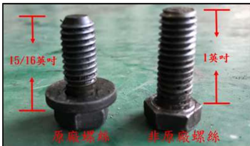
圖 1.7-12 事故列車回油管接合處使用之不同型式螺絲
