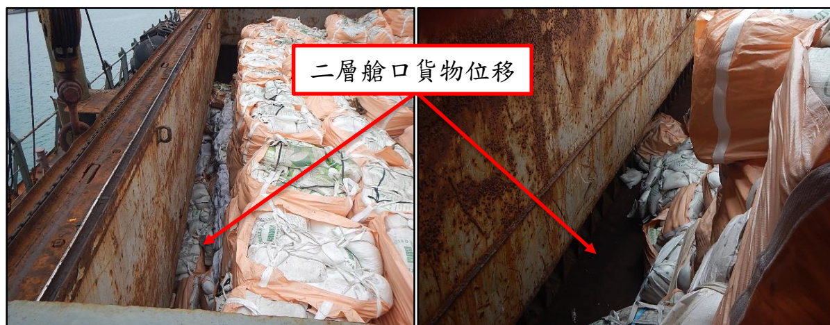
圖 1.8.2-3 LI FUNG 二層甲板艙口噸袋貨物位移狀況
