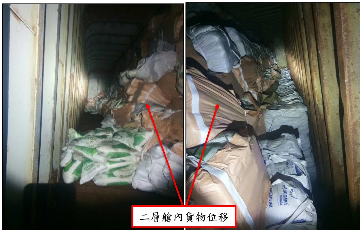
圖 1.8.2-4 LI FUNG 二層甲板艙內噸袋貨物位移狀況
