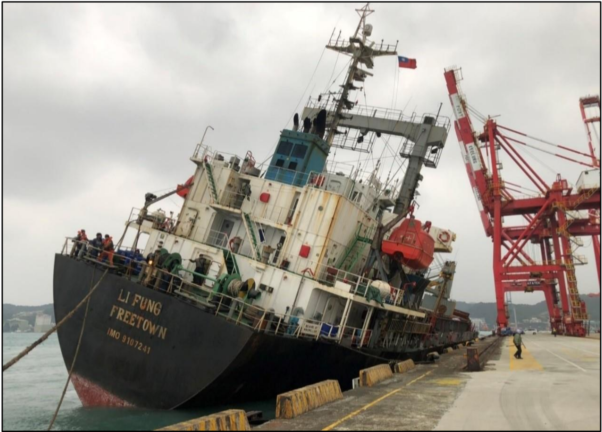
圖 1.1-1 LI FUNG 船身右傾 20 度情形
