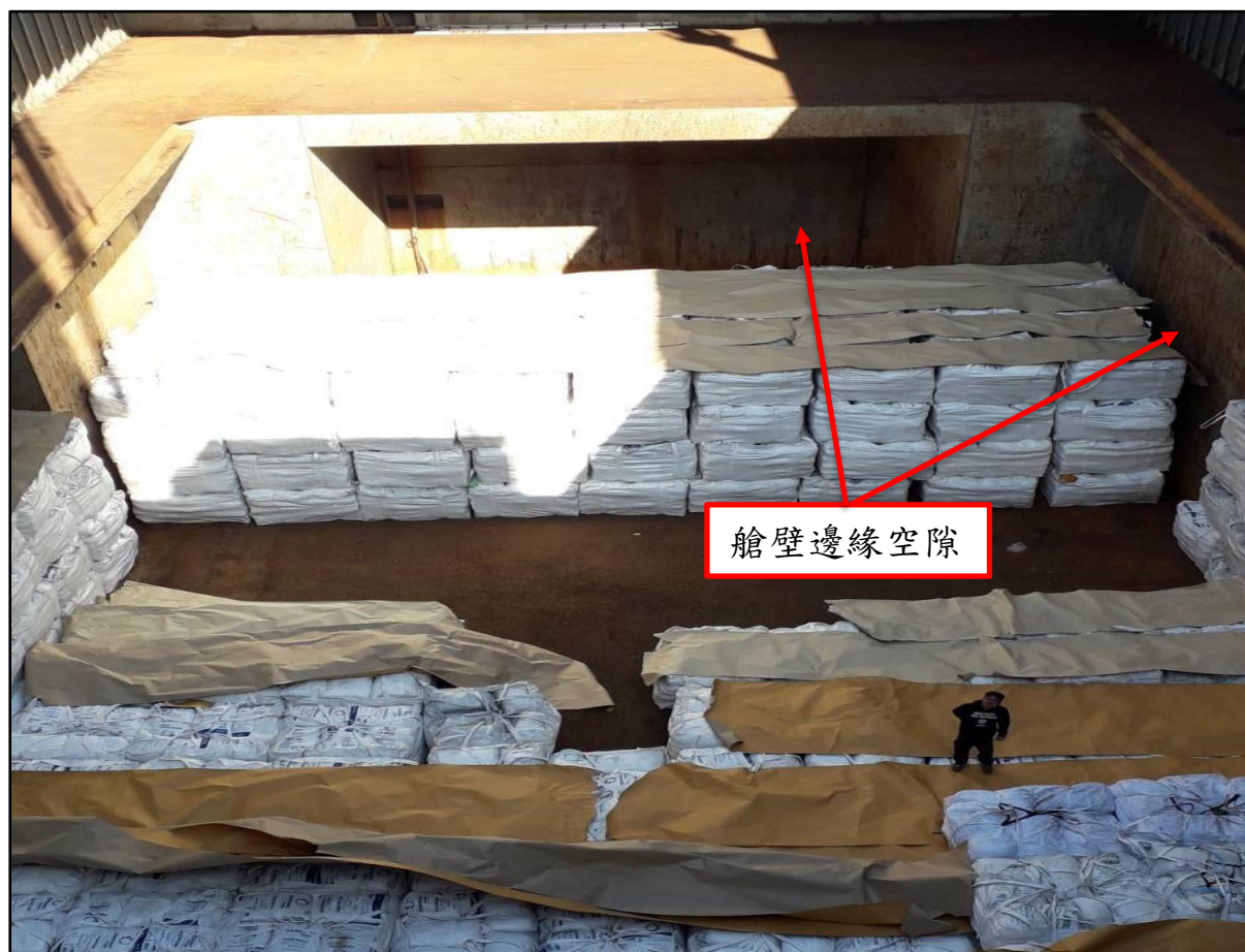
圖 1.8.2-1 LI FUNG 貨艙艙底板裝載噸袋貨物狀況
