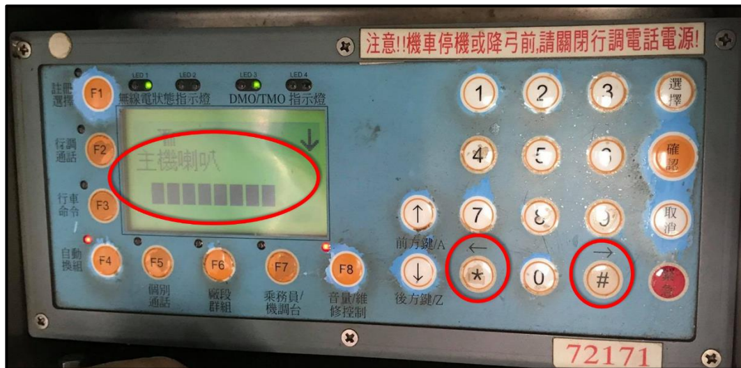
圖 1.9-1 行調無線電車上台音量調整方式
