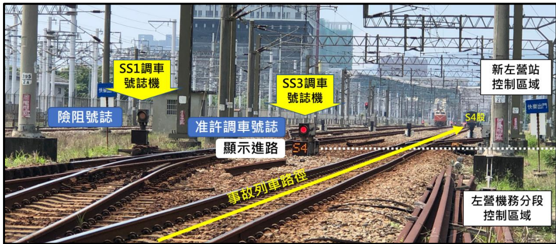
圖 1.7-12 SS3 調車號誌機顯示（非事故當日）
