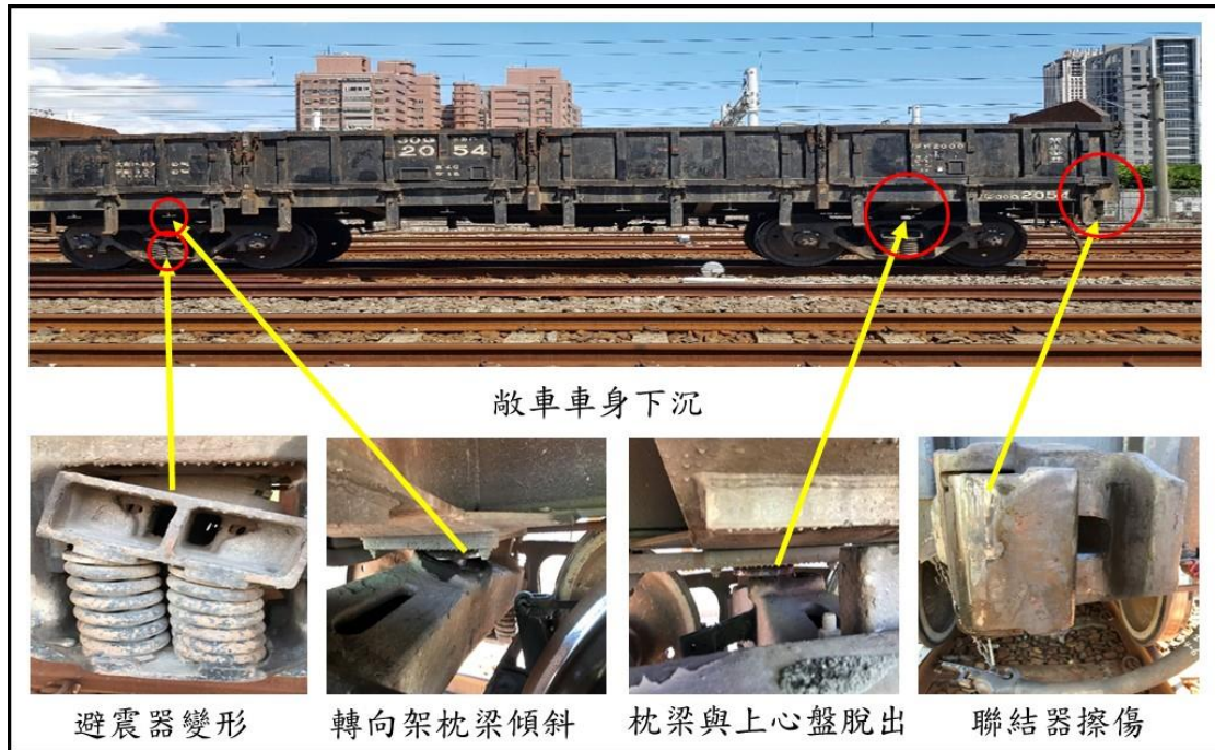
圖 1.3-1 30G2054 敞車損害情形示意圖
