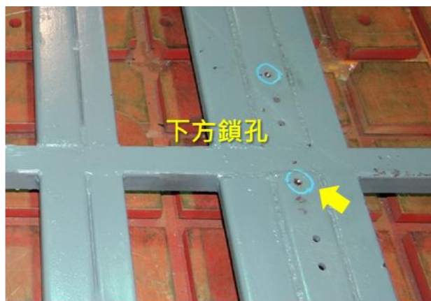
圖 1.14-2 民國 102 年安全帶固定裝置檢測過程
