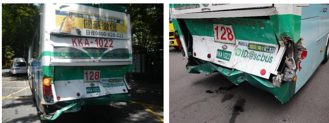
圖 1.4-1 三重客運公車損壞情形
