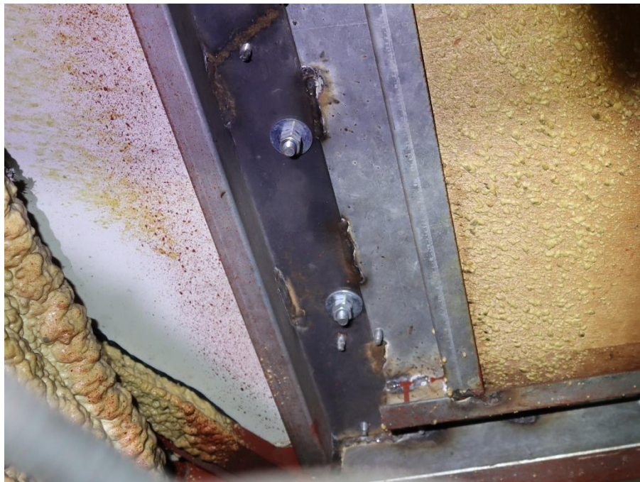
圖 2.4-2 另一同型大客車之座椅固定裝置螺絲鎖附情形
