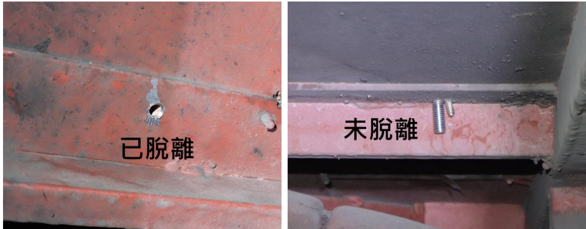
圖 2.4-1 事故車輛座椅固定裝置螺絲檢視狀況
