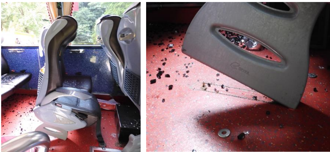
圖 1.12-3 事故車輛座椅脫離及前傾情形
