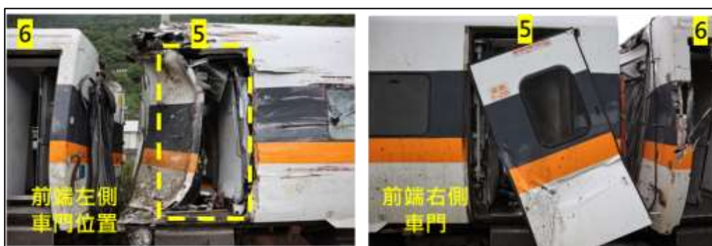
圖 1.13-6 第 5 車前端左、右側車門及玄關通道
