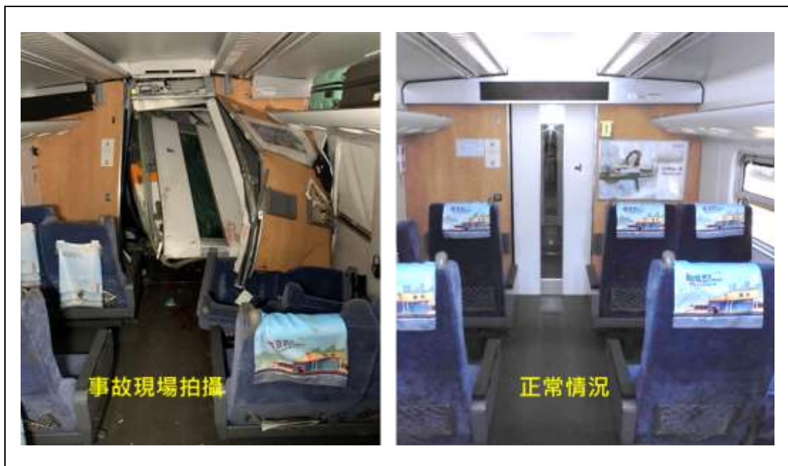
圖 1.13-3 第 4 車前端受損情形
