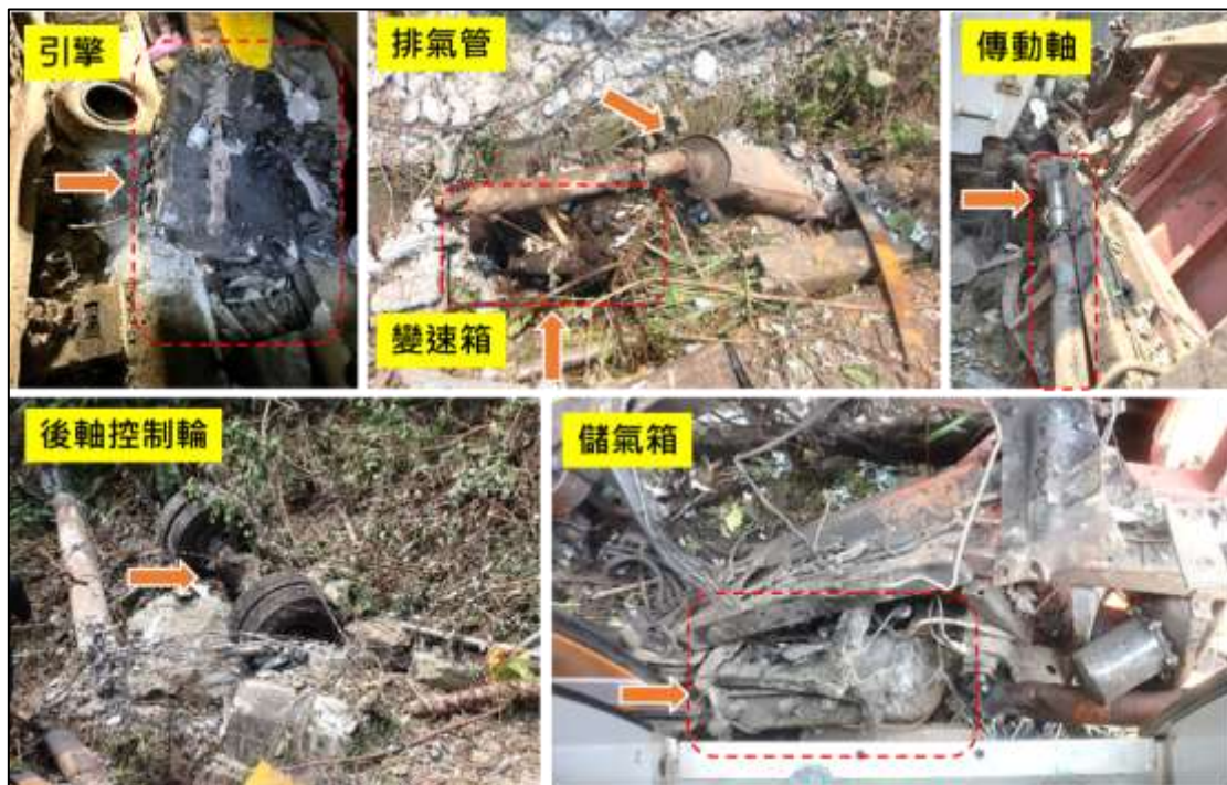
圖 1.3-14 大貨車零組件受損情形
