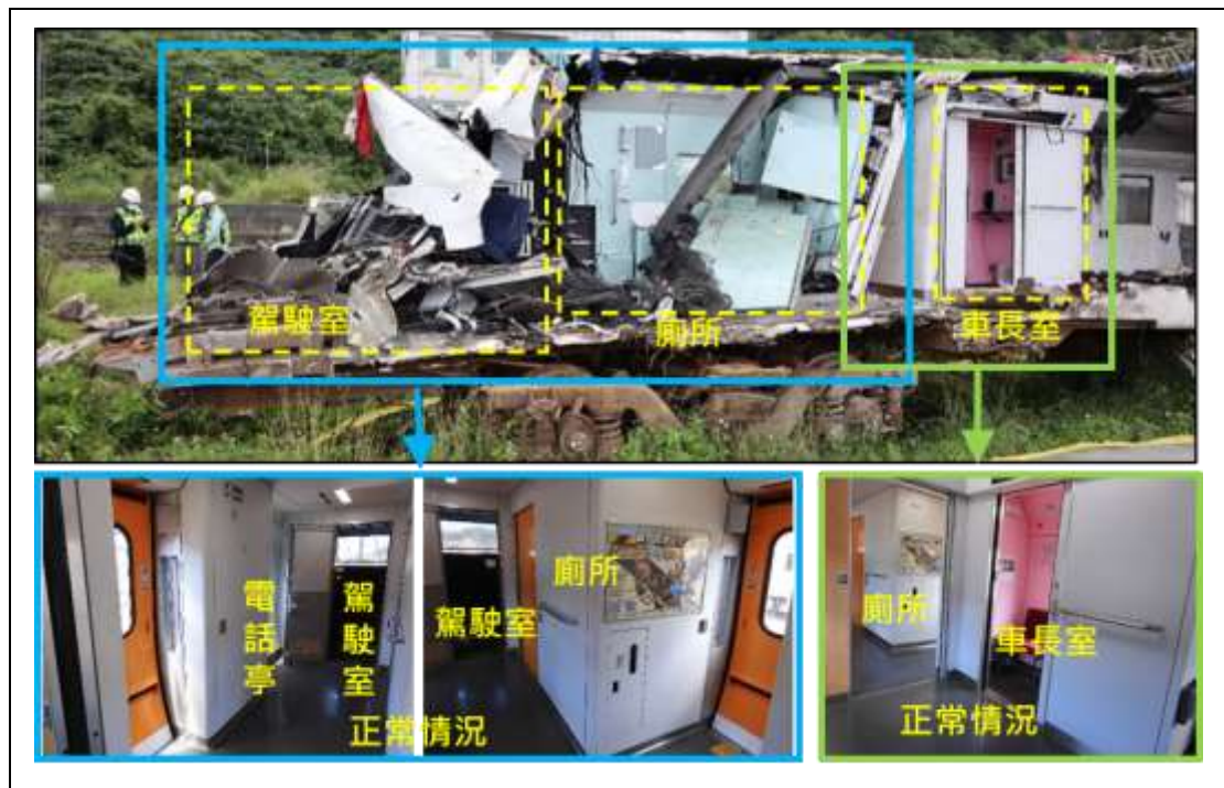
圖 1.13-22 第 8 車前段受損情形
