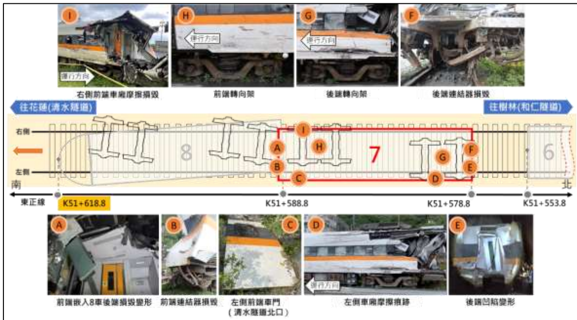
圖 1.3-2 第 7 車損害情形
