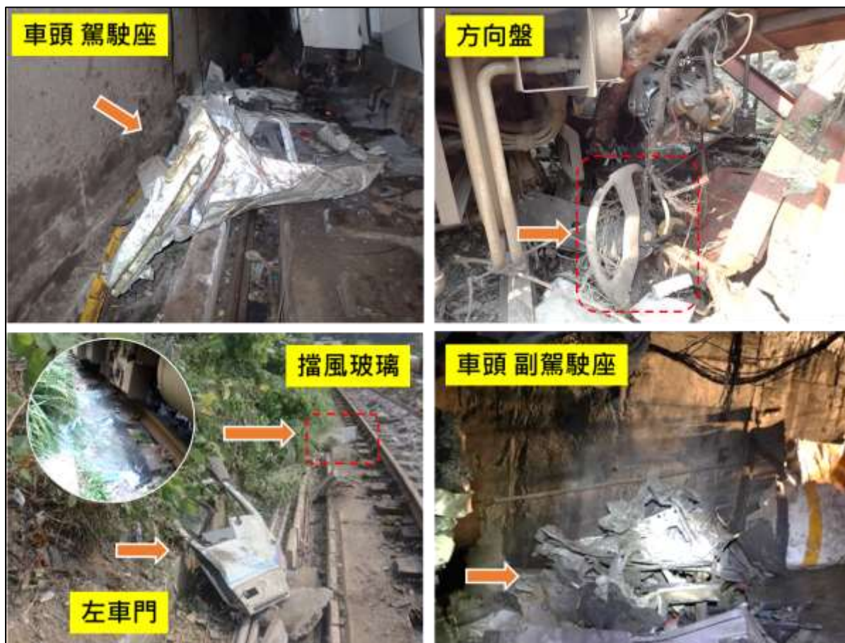
圖 1.3-12 大貨車車頭受損情形
