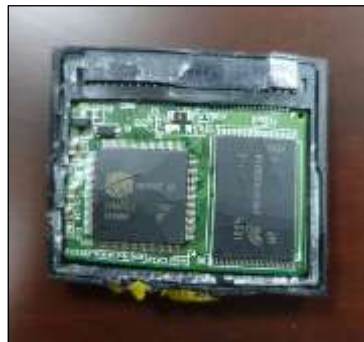
圖 1.10-6 開啟記憶卡外蓋後之內部照片
