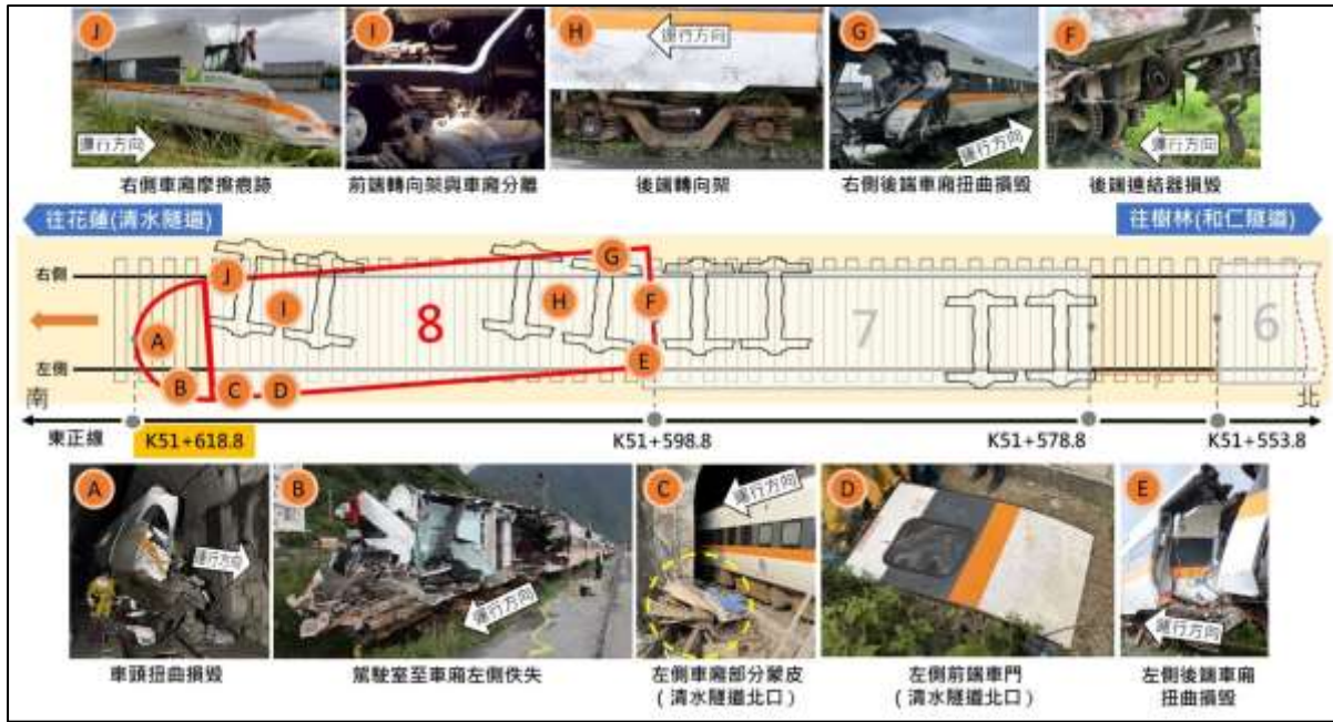
圖 1.3-1 第 8 車損害情形
