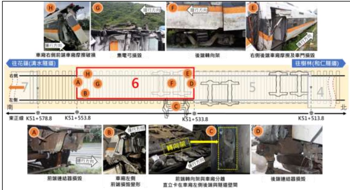
圖 1.3-3 第 6 車損害情形
