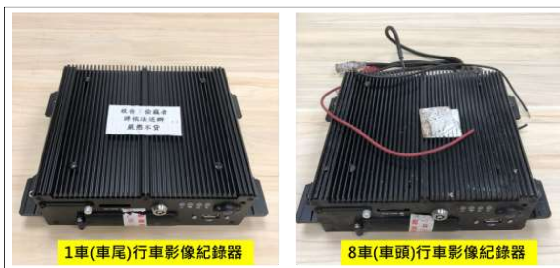
圖 1.10-12 事故列車行車影像紀錄器
