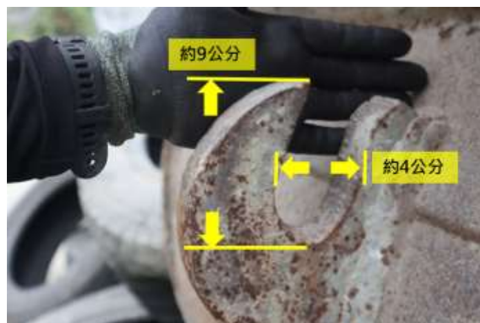
圖 1.8-4 挖斗裝置上之掛勾外觀照片
