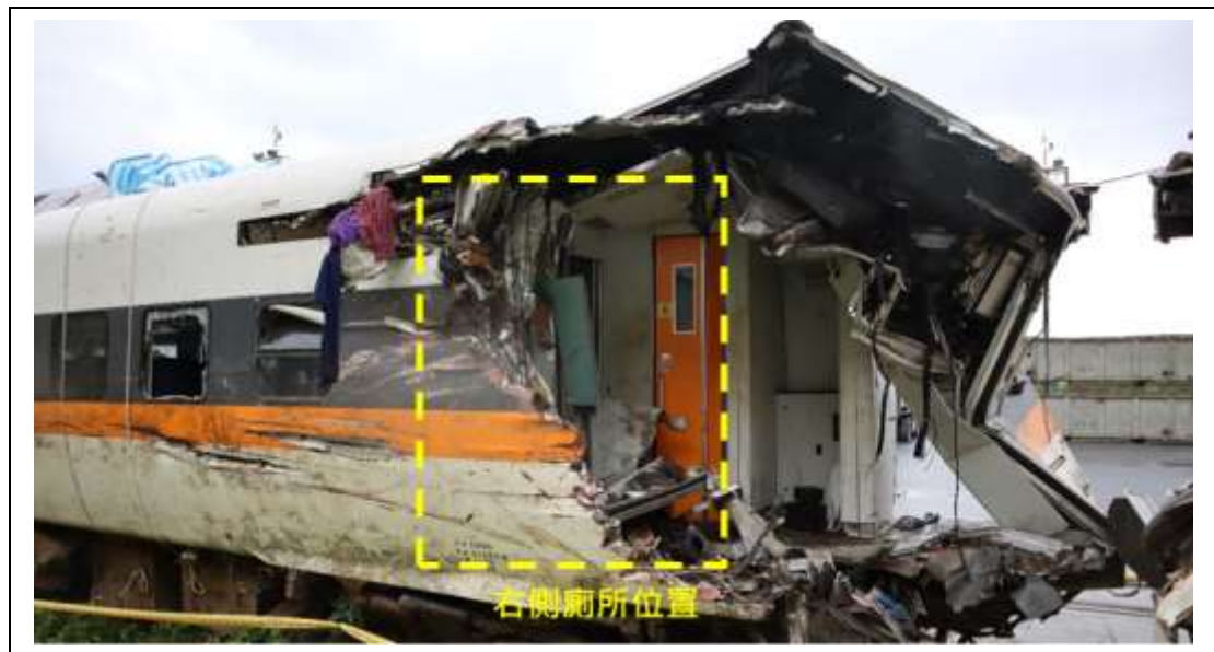
圖 1.13-17 第 7 車女廁受損情形
