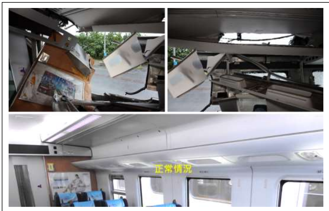
圖 1.13-20 第 7 車後端左側受損情形
