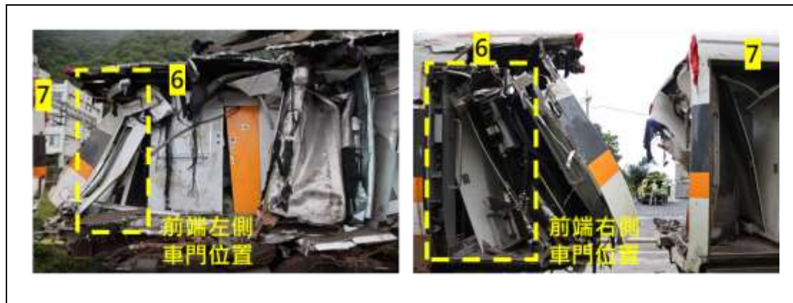
圖 1.13-11 第 6 車前端左、右側車門及玄關通道
