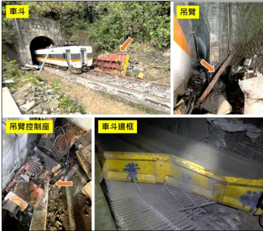
圖 1.3-13 大貨車車身受損情形
