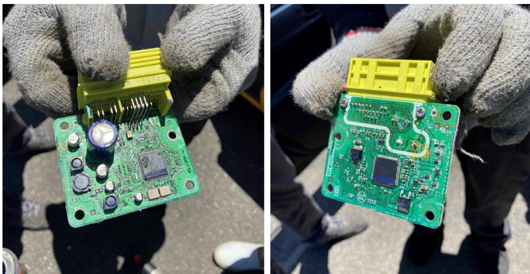
圖 1.9-3 電路板銹蝕情形
