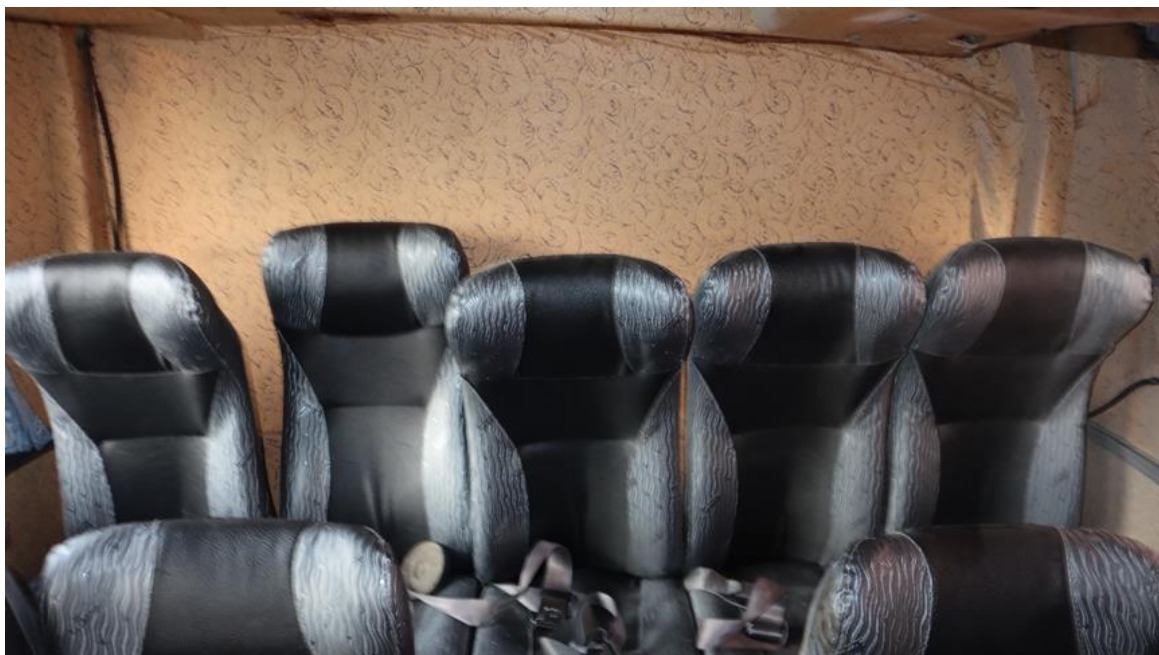
圖 1.12-1 事故車輛 6 排座椅前傾情形
