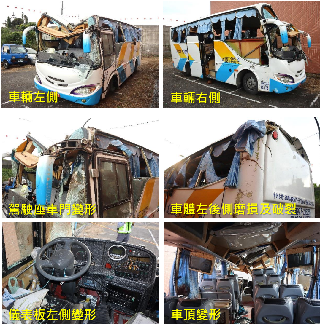
圖 1.3-8 事故車輛損壞情形
