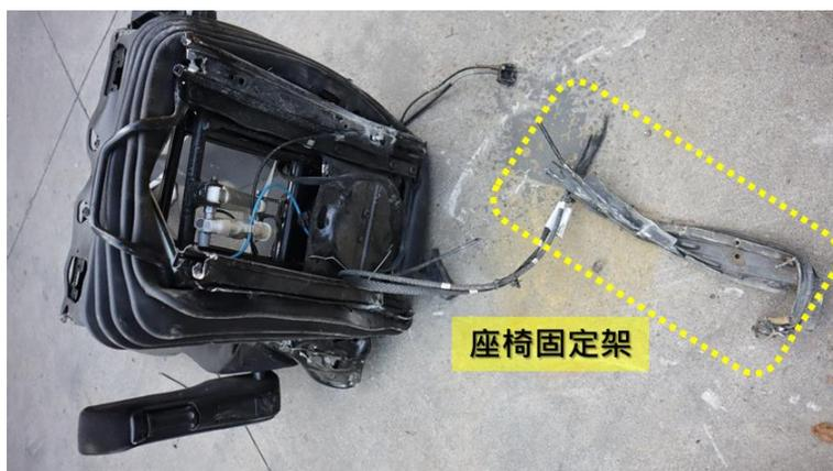
圖 35 事故車輛座椅底部損壞情形
