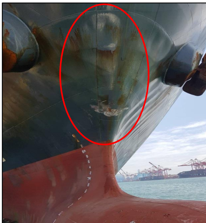
圖 1.10-1 MARCLIFF 船艏擦撞痕跡
