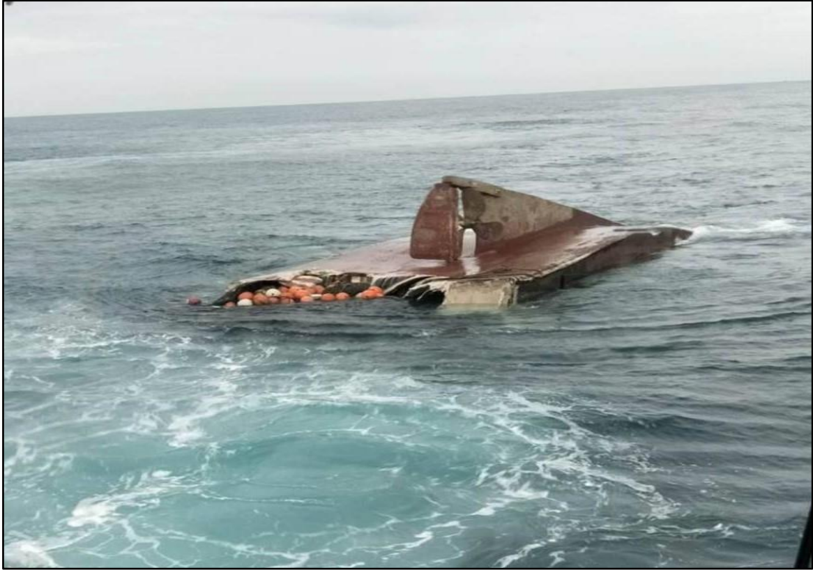
圖 1.10-5 新億鰻殘骸現場船艙撞擊處呈圓形凹陷
