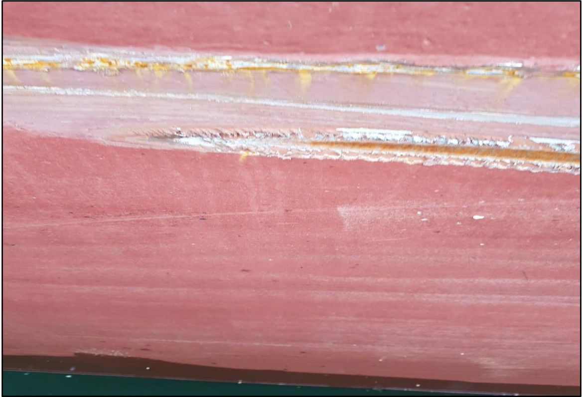
圖 1.10-3 MARCLIFF 右舷船殼擦撞痕跡 (二)
