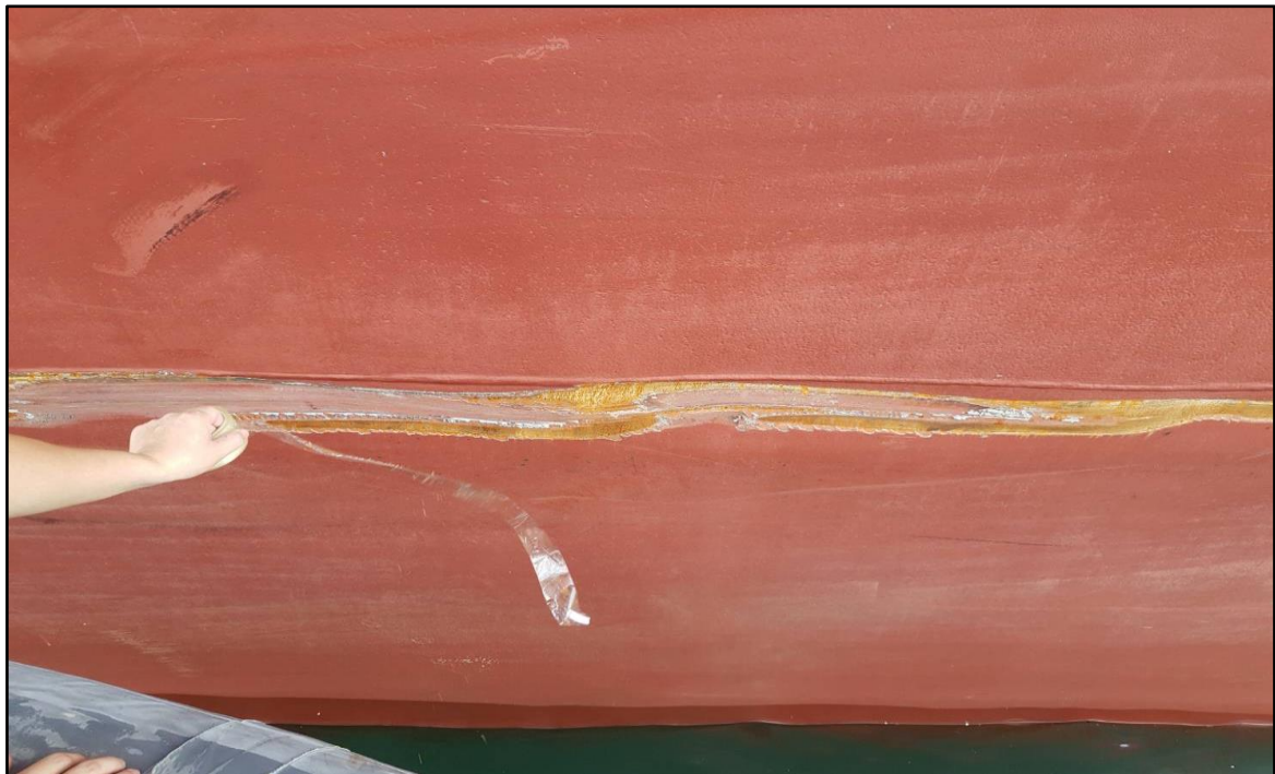
圖 1.10-4 MARCLIFF 右舷船殼擦撞痕跡 (三)
