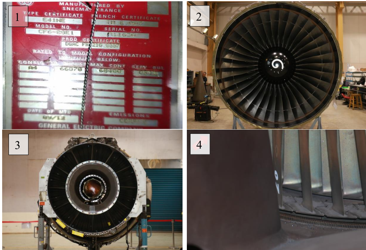
圖 1.16-1 發動機進、排氣口目視檢查
