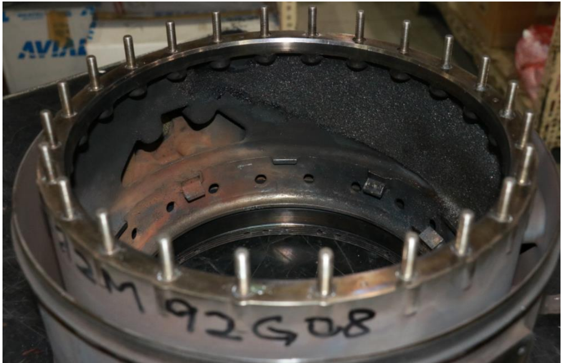
圖 2.4-7 油室內部熱損變色與金屬噴濺狀況
