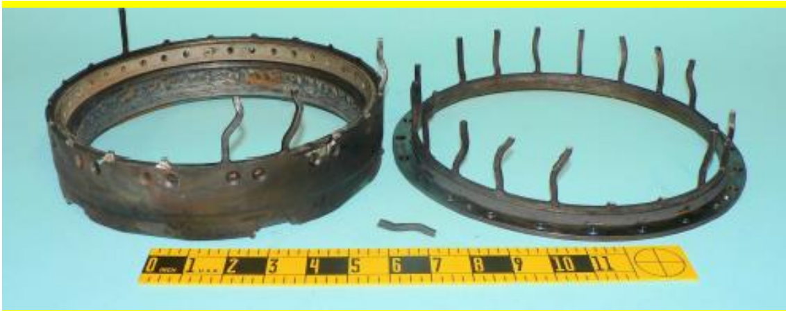
圖 2.4-9 4B/4R 軸承室受損狀況
