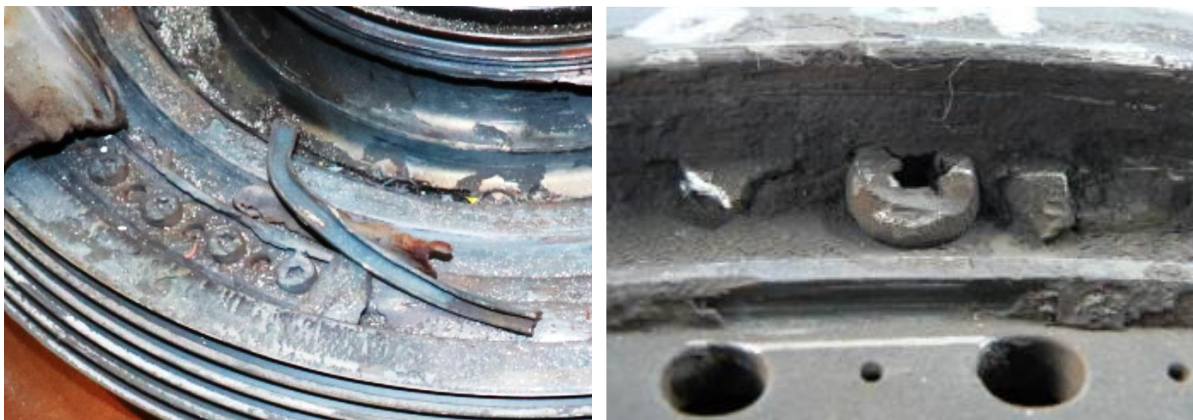
圖 2.4-10 CDP 轉子螺桿頭磨損
