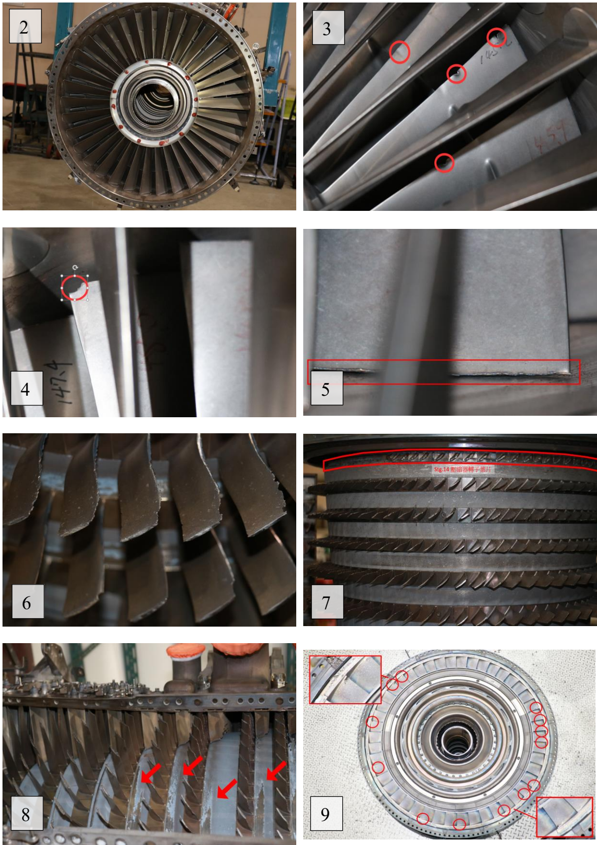
圖 1.16-20 壓縮器損傷狀況
