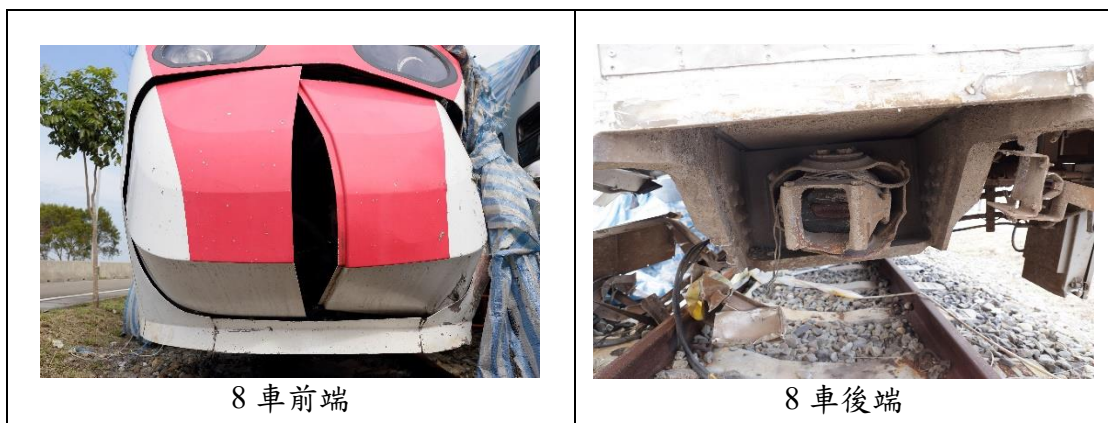
圖 1.3-2 第 8 車前後連結器損傷概況圖
