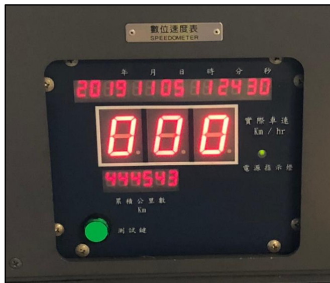
圖 1.8-6 數位車速表顯示即時車速
