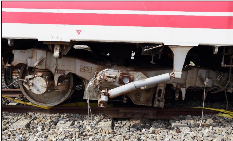
圖 1.3-11 第 6 車轉向架損傷概況圖
