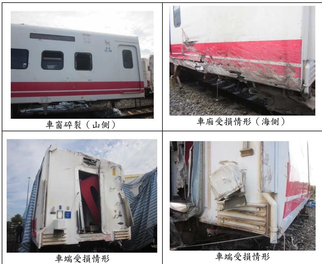
圖 1.3-13 第 4 車損傷概況圖
