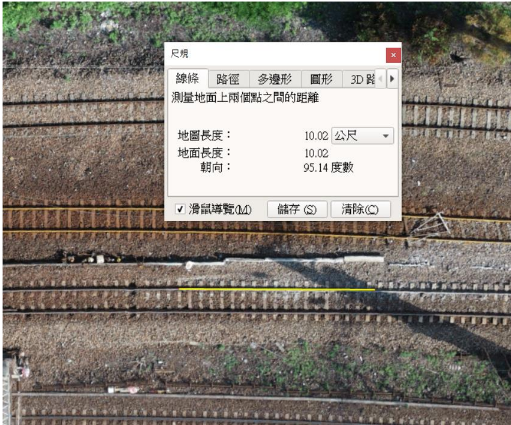
圖 1.10-8 空拍圖 10 公尺長度測量（介曲線）
