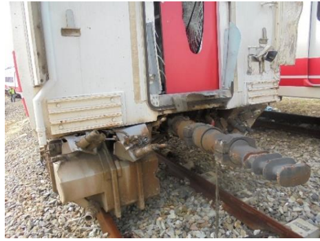
連結器受損情形
