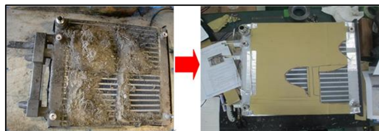
圖 2.2-3 事故列車 1 車冷卻器鰭片狀態模擬
