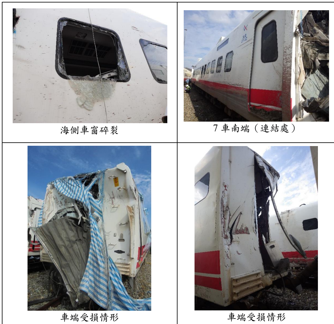
圖 1.3-5 第 7 車車廂損傷概況圖
