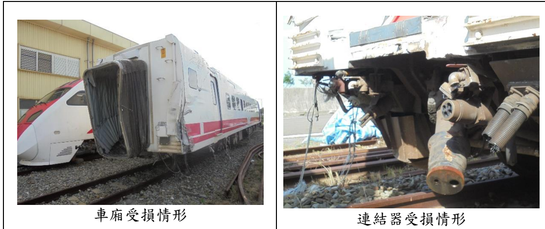
圖 1.3-13 第 4 車損傷概況圖
