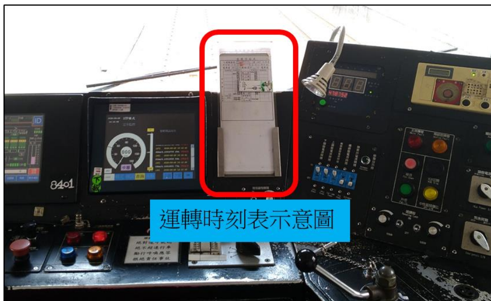
圖 1.9-26 運轉時刻表示意圖（非事故列車）
