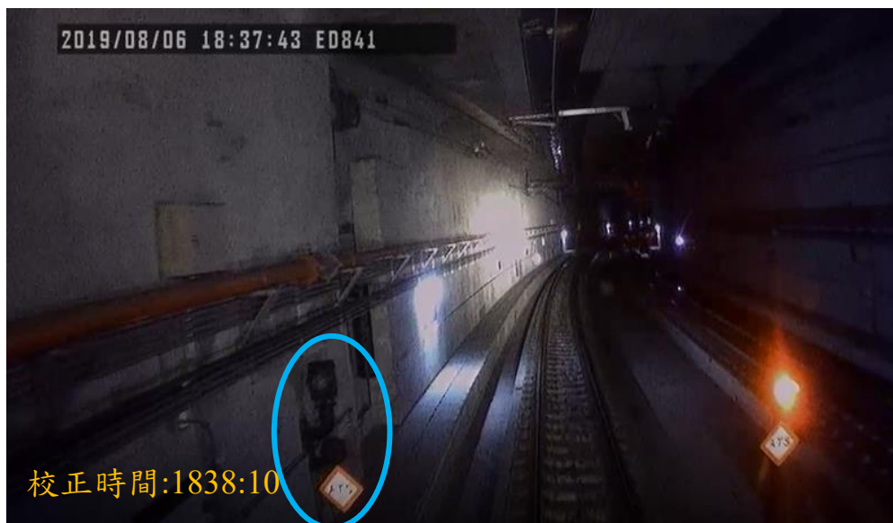
圖 1.12-8 高雄站 ATS 標誌
