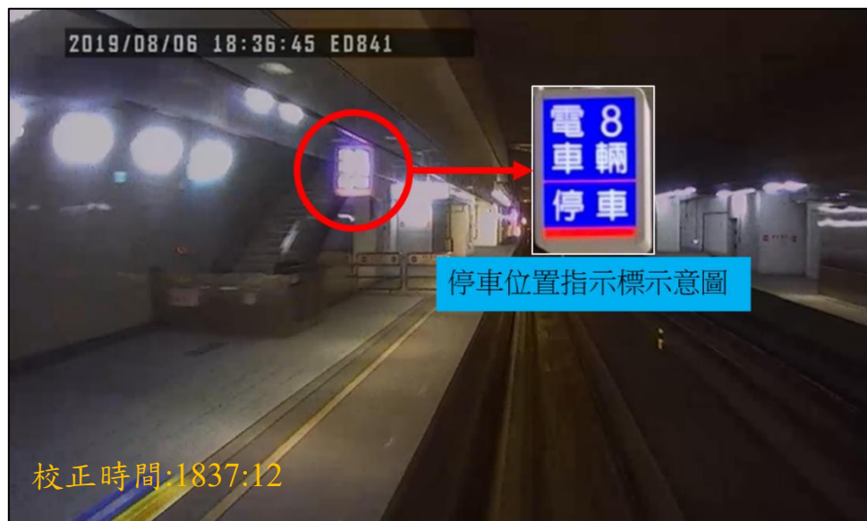
圖 1.12-5 三塊厝站電車 8 輛停車位置指示標
