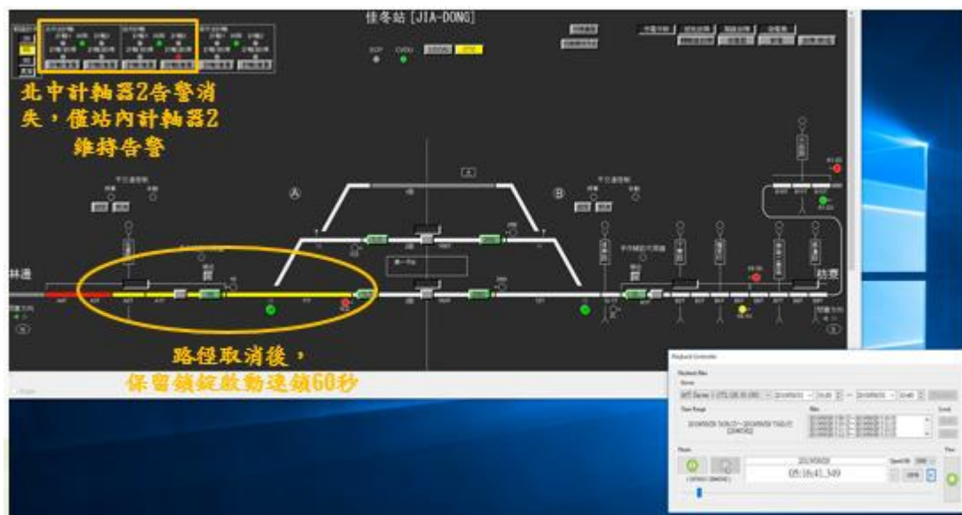
圖 1.9-11 第 3504 次車佳冬站離站期間產生之異常 (3)
