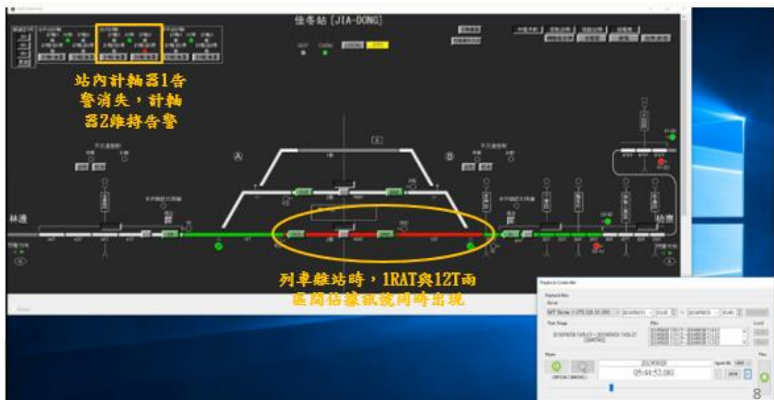
圖 1.9-15 第 3042A 次車通過佳冬站期間產生之異常 (4)
