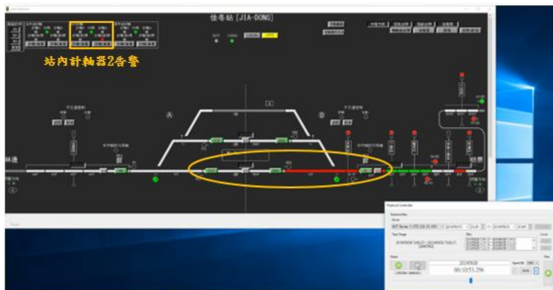
圖 1.9-30 第 333 次車佳冬站離站期間產生之異常 (1)
