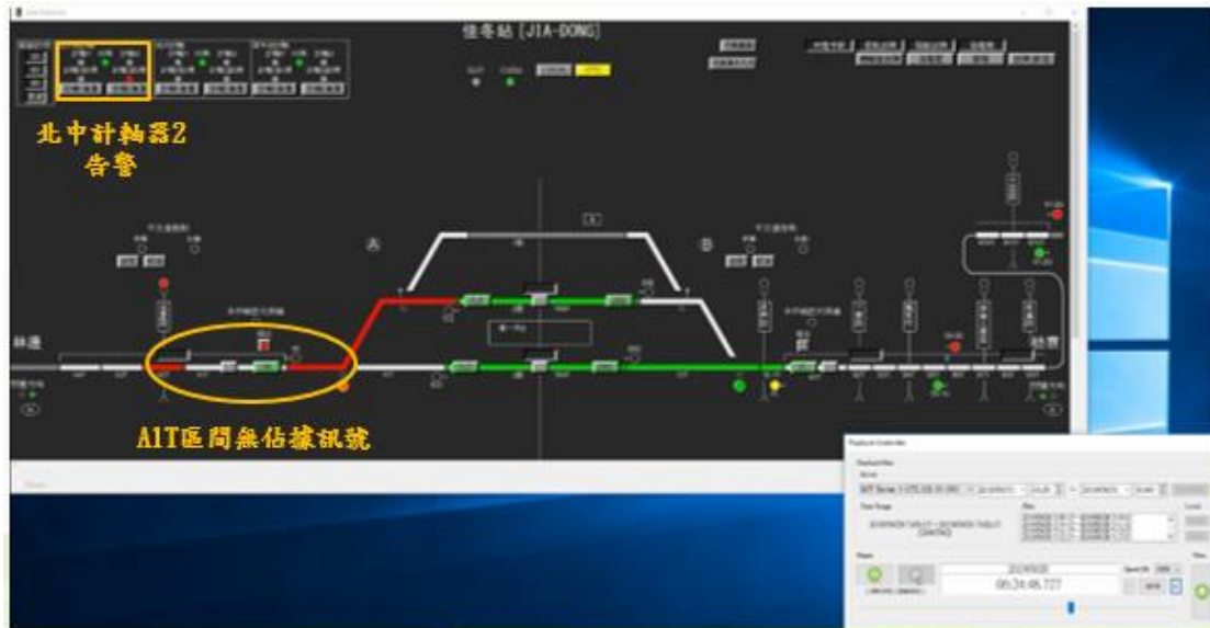
圖 1.9-32 第 3503 次車佳冬站進站期間產生之異常 (1)
