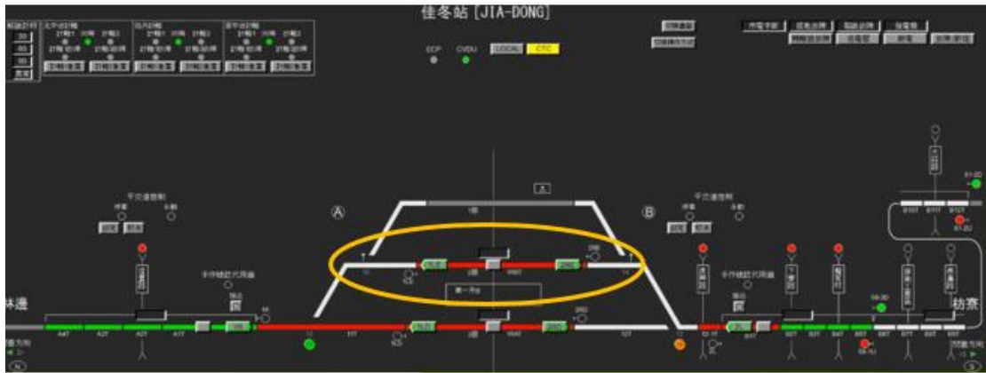
圖 1.9-37 第 3503 次車佳冬站離站期間產生之異常 (2)
