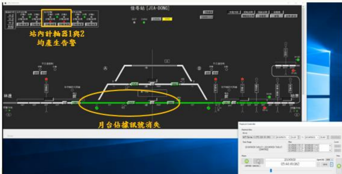
圖 1.9-14 第 3042A 次車通過佳冬站期間產生之異常 (3)
