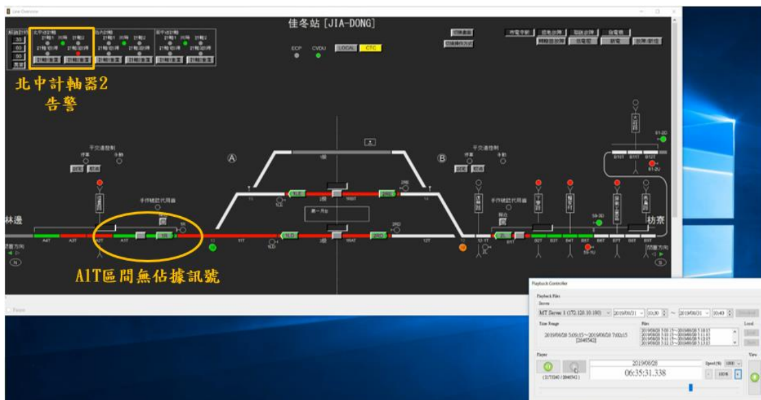
圖 1.9-38 第 3042 次車佳冬站離站期間產生之異常 (1)
