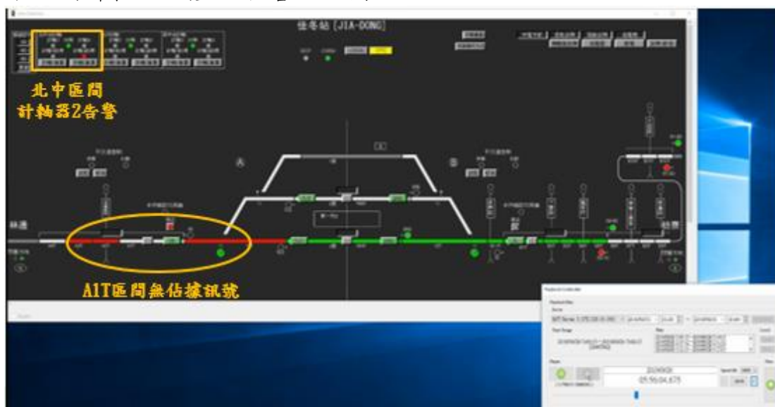
圖 1.9-18 第 3501 次車佳冬站進站期間產生之異常 (1)
