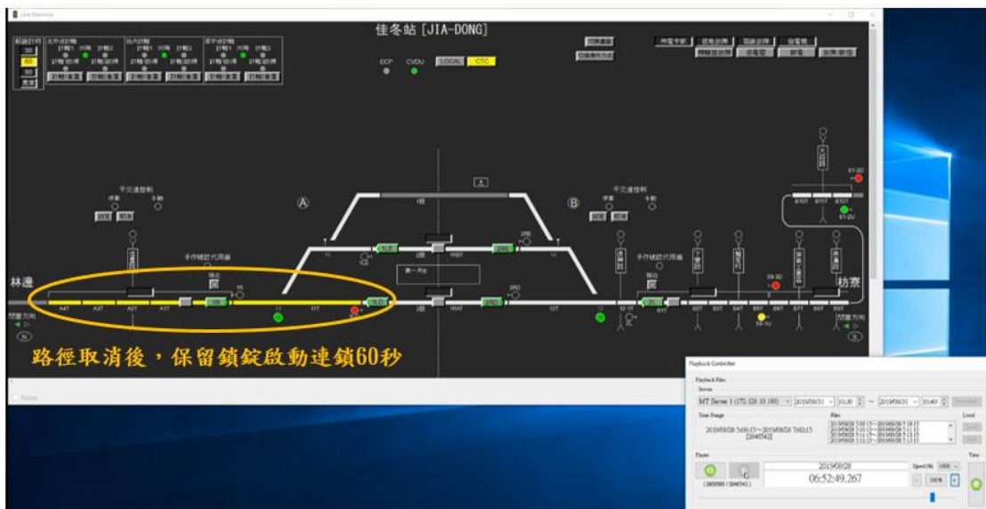
圖 1.9-42 月台出發號誌機路徑取消，保留鎖錠啟動聯鎖 60 秒
