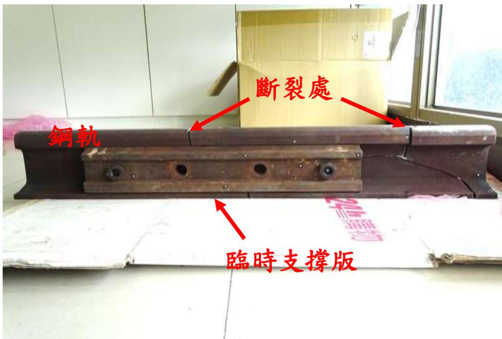
照片一：斷裂鋼軌組合後外觀
