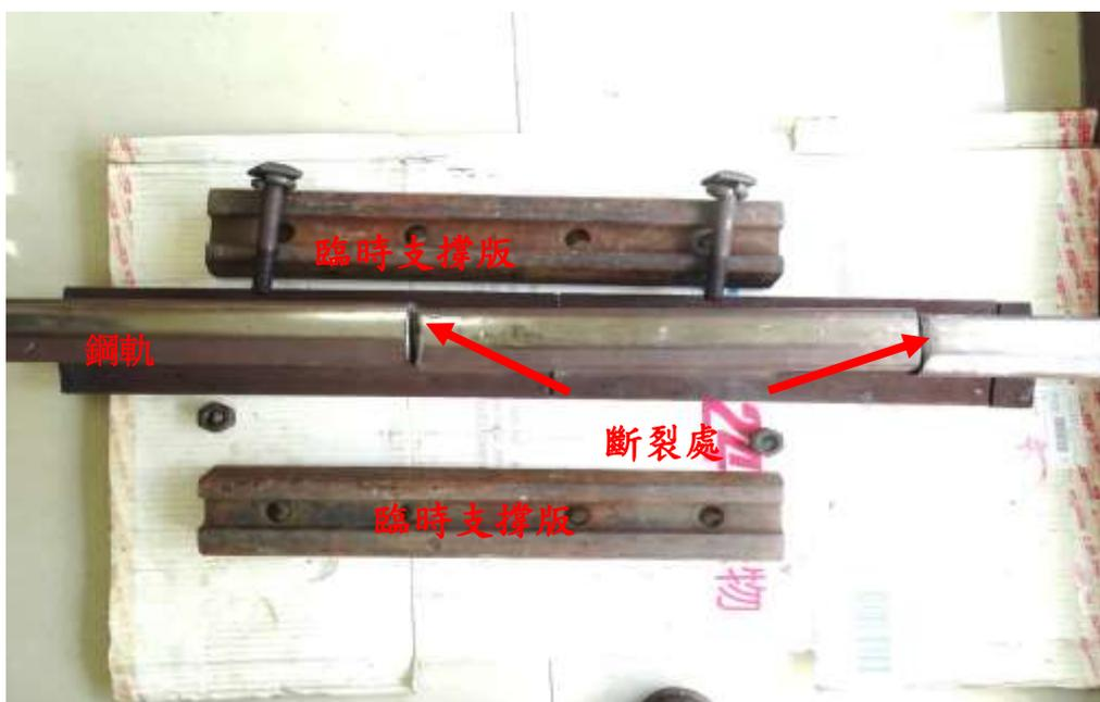
照片二：斷裂鋼軌組合後外觀
