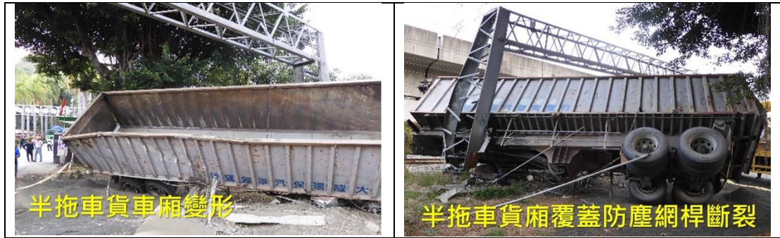
圖 1.2-8 曳引車及半拖車損害情形
