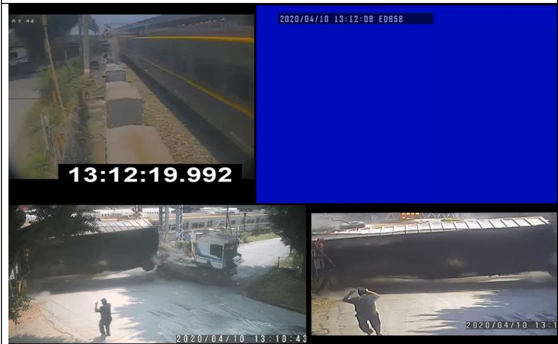
1312:20.0 時，事故車輛車斗與車頭分離。
