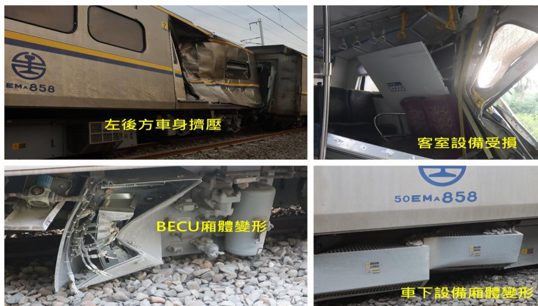
圖 1.2-4 編號 7 車損害情形-1
