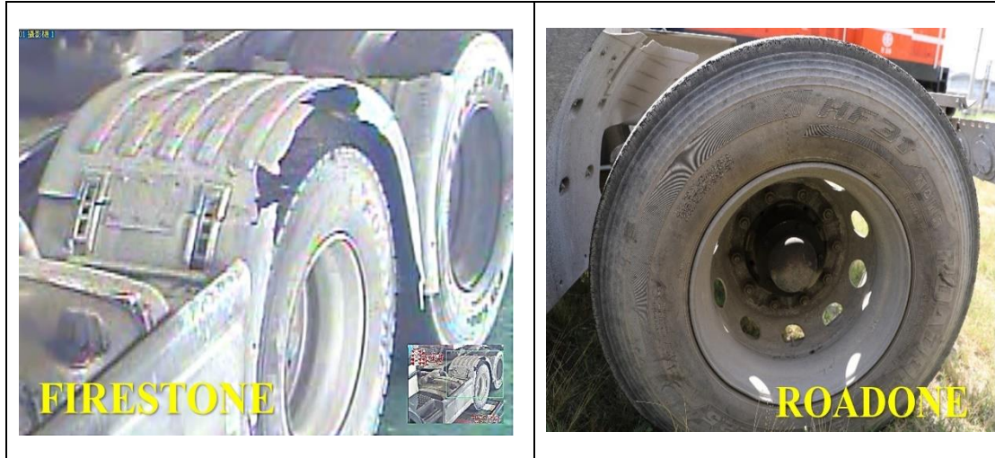
圖 1.8-7 半聯結車輪胎比對圖（左圖驗車照片、右圖事故發生照片）
