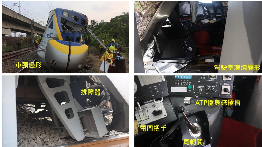
圖 1.2-2 編號 8 車損害情形-1
