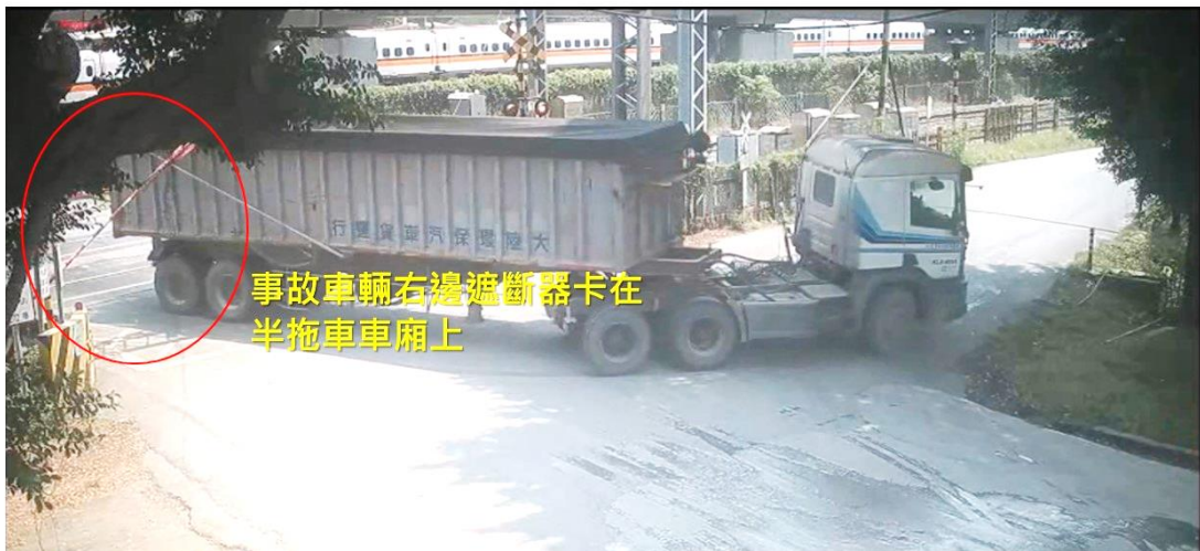
圖 2.1-1 平交道西側出口端遮斷器放下情形
