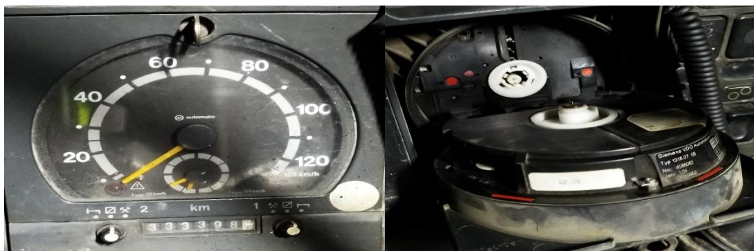
圖 1.11-1 事故車輛機械式行車紀錄器
