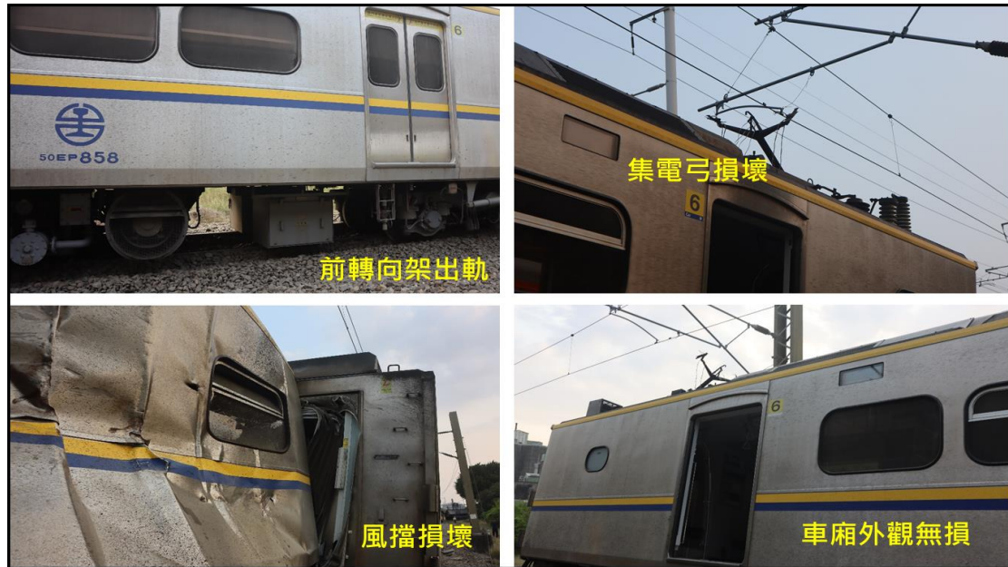
圖 1.2-6 編號6車損害情形-1
