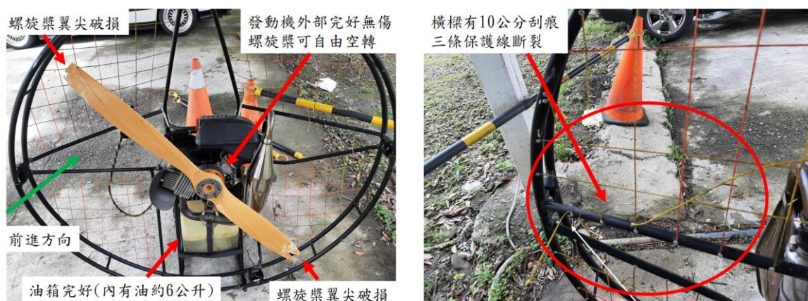
圖 3-6 事故載具之殘骸初步檢視2
