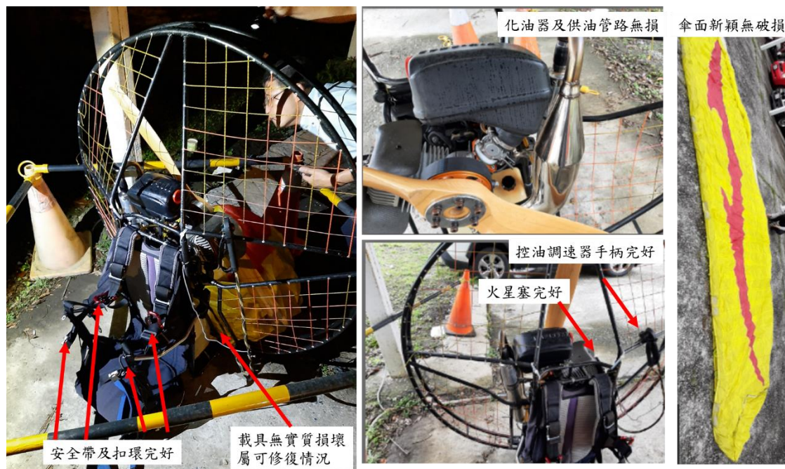
圖 3-5 事故載具殘骸之初步檢視1
