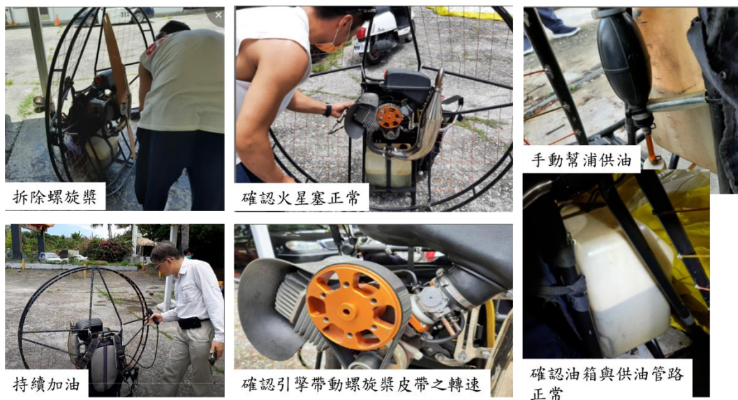
圖 3-8 事故載具之引擎測試圖
