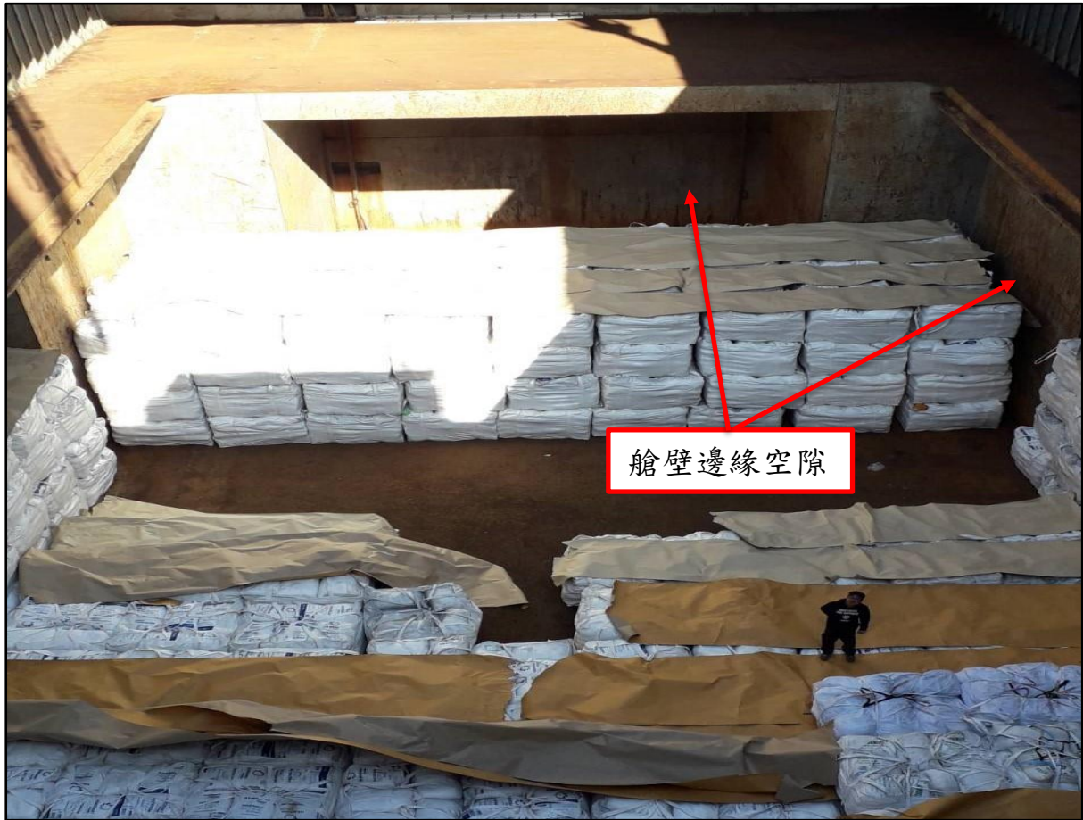
圖 1.8.2-1 利豐貨艙艙底板裝載噸袋貨物狀況
