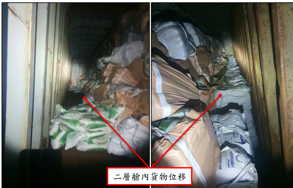
圖 1.8.2-4 利豐二層甲板艙內噸袋貨物位移狀況
