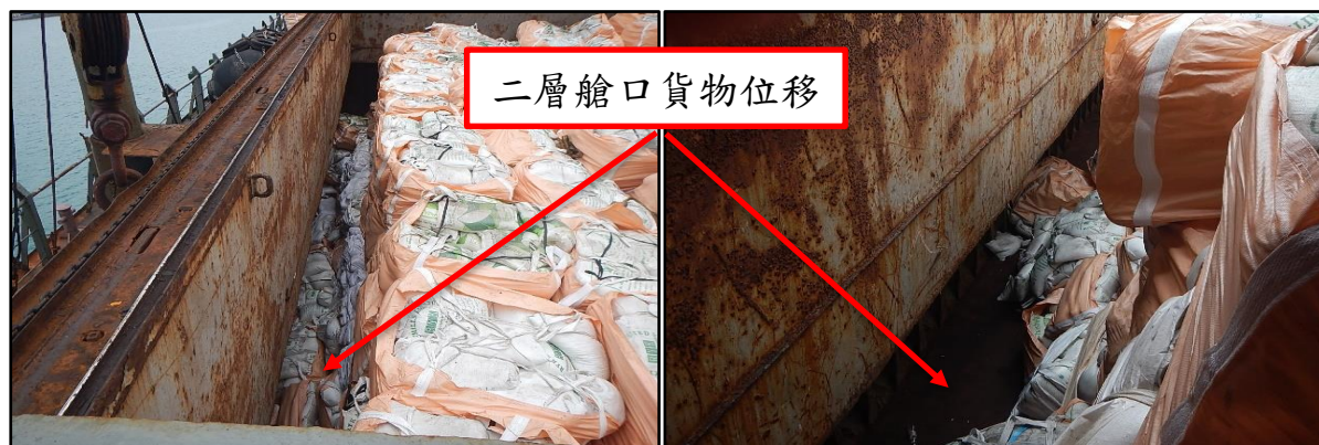
圖 1.8.2-3 利豐二層甲板艙口噸袋貨物位移狀況
