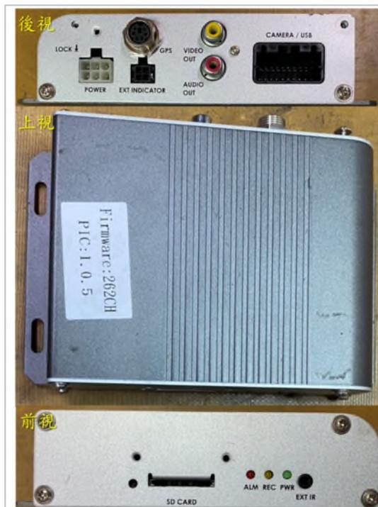
圖 1.9-7 車威視行車視野輔助系統外觀
