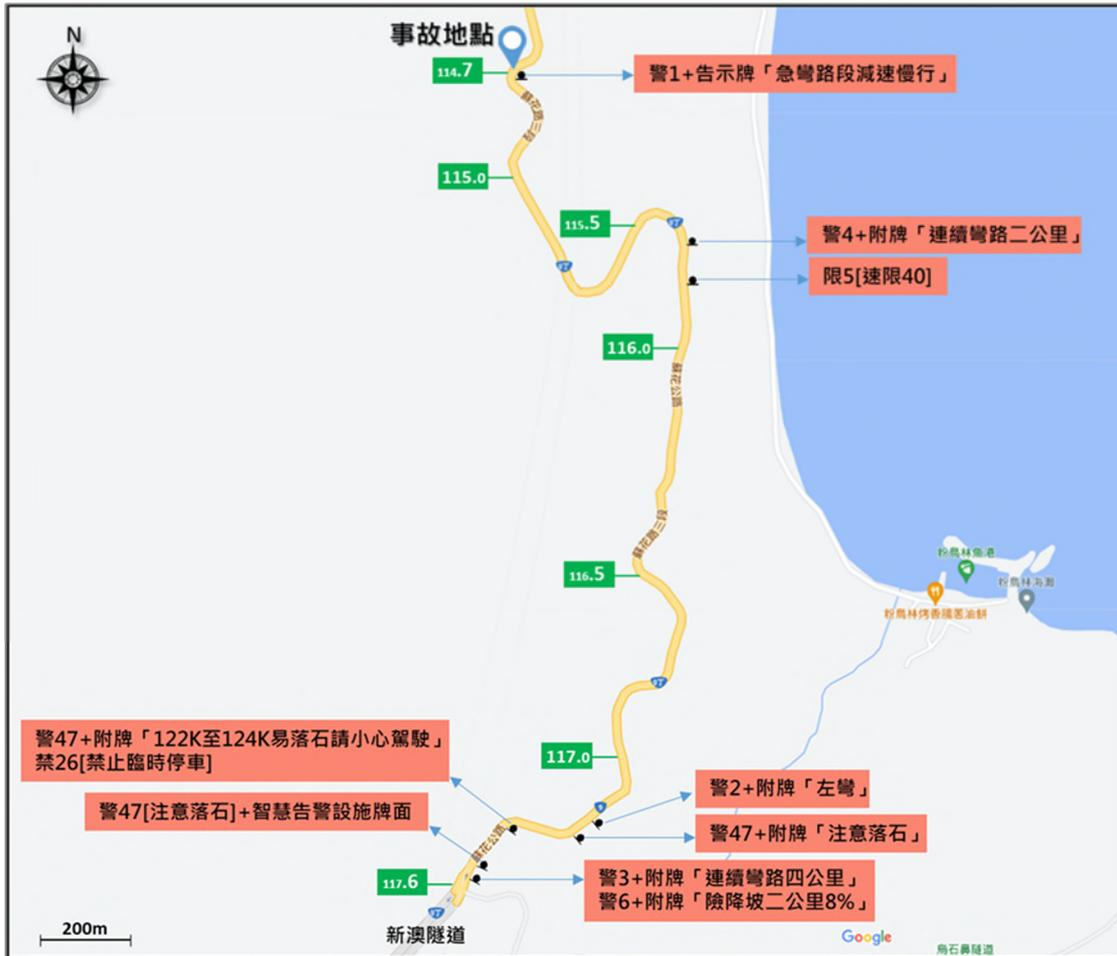
圖 1.8-6 新澳隧道出口至事故地點沿線標誌設置示意圖
