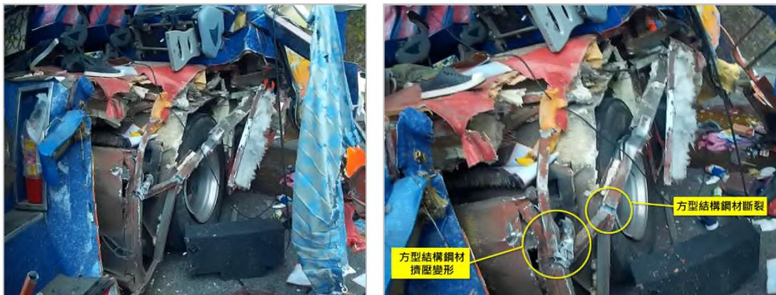
圖 1.3-23 事故車輛左側安全門至第 9 排座椅損壞情形
