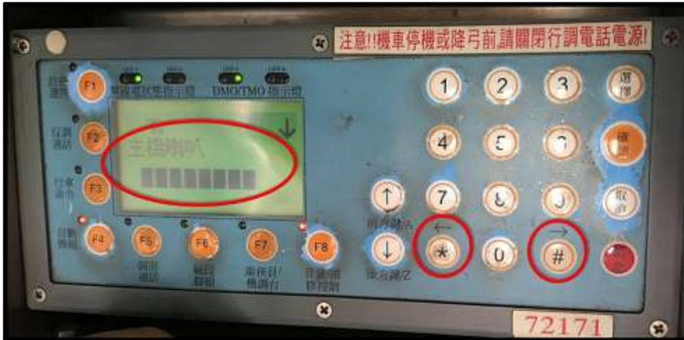
圖 1.9-1 行調無線電車上台音量調整方式
