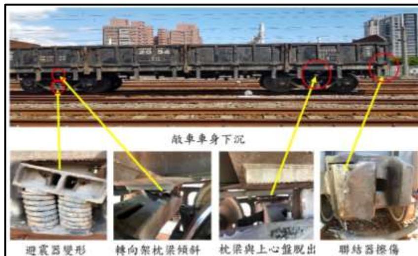
圖 1.3 30G2054 敞車損害情形示意圖
