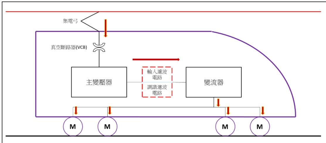
圖 1.7-1 E1000 型電力機車動力簡略運作方式
