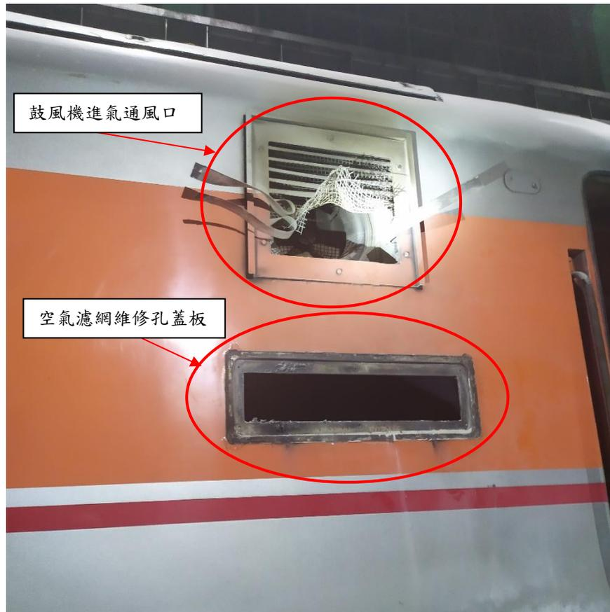
圖 1.1-2 「鼓風機進氣通風口」及「空氣濾網維修孔蓋板」
