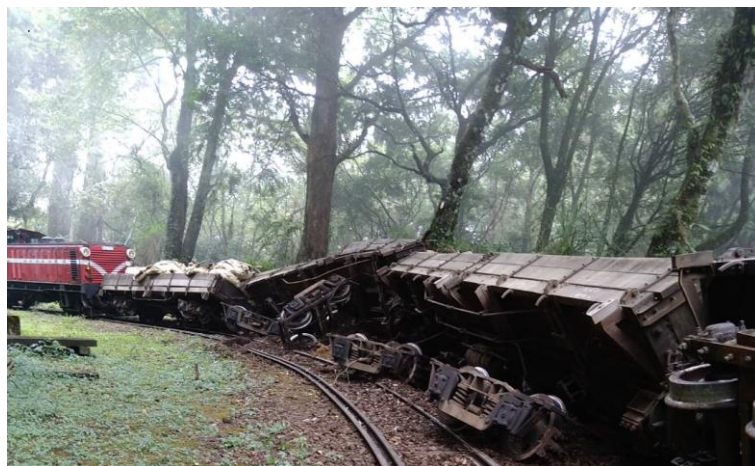
圖 2.1.3-9 1015 阿里山林業鐵路及文化資產管理處第 664 次車重大鐵道事故照片
