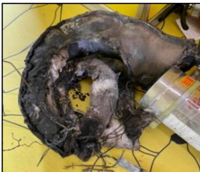
圖 1.1-2 渦輪增壓機護罩火災殘骸
