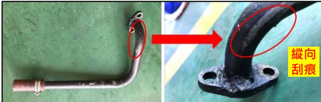
圖 1.8-11 回油管下方彎曲處左側縱向刮痕
