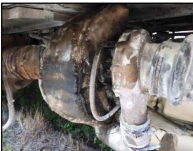
圖 1.1-1 車底左(山)側渦輪增壓機與護罩損毀
