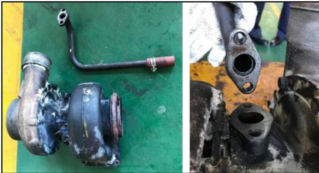
圖 1.8-6 潤滑油回油管與渦輪增壓機接合處
