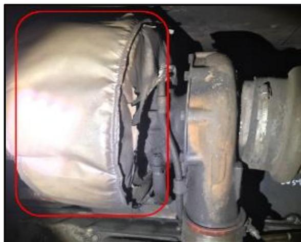
圖 1.13-1 事故車輛使用之渦輪增壓機隔熱罩
