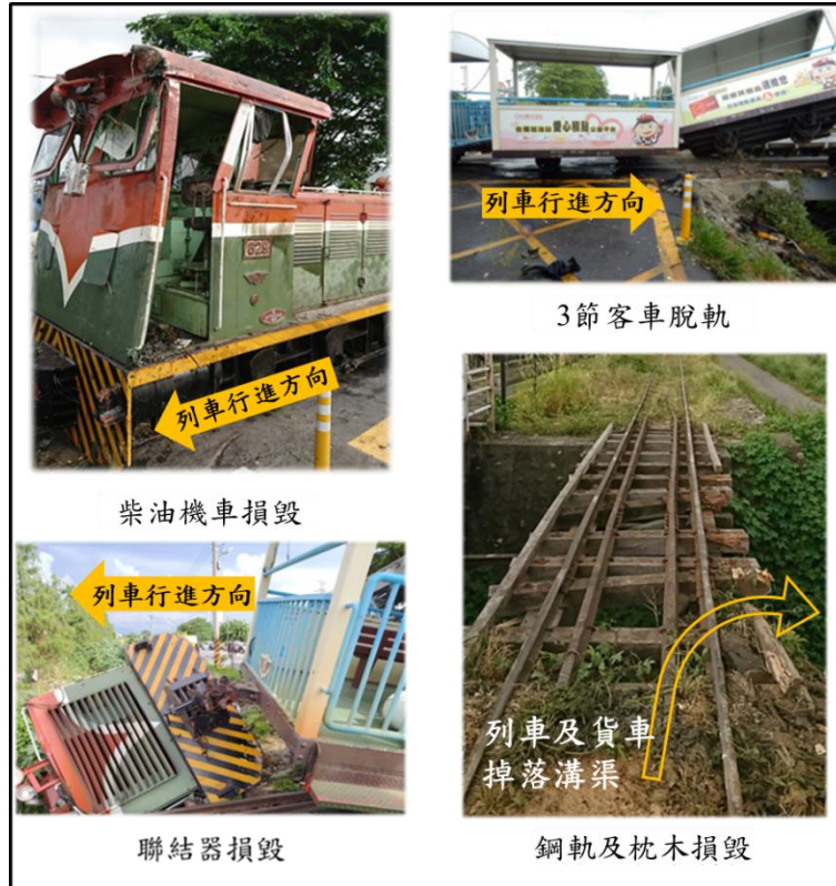
圖 3 事故列車、鋼軌及枕木損害情形
