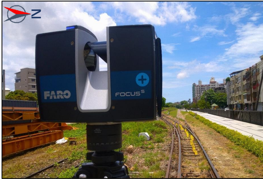
圖 4 FARO FocusS 350 plus 雷射掃描儀
