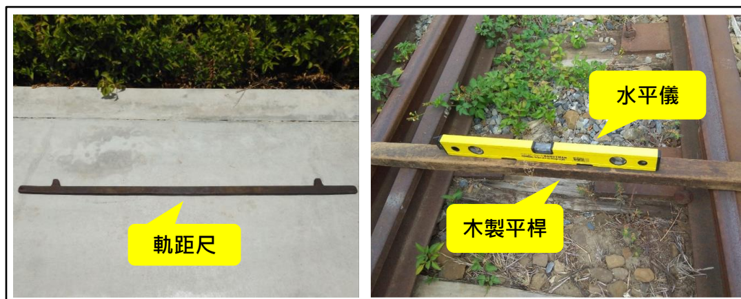
圖 17 新營鐵道文化園區軌道檢測設備
