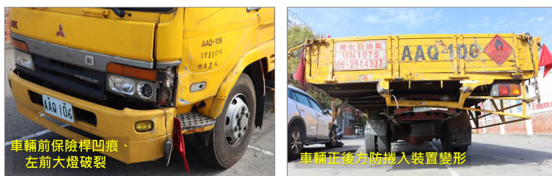
圖 6 事故車輛 A 損壞情形
