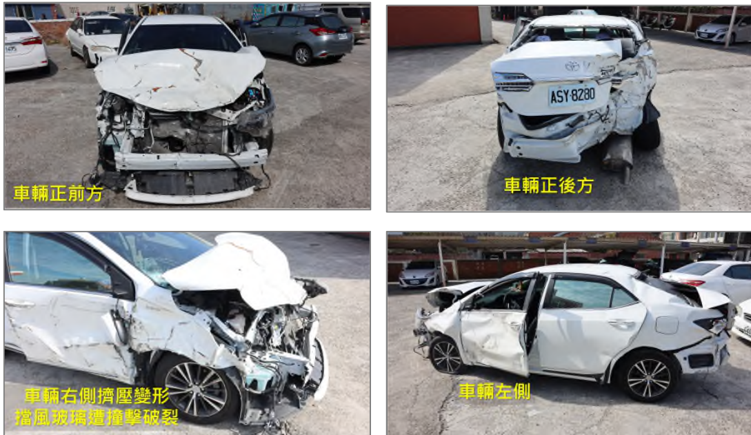
圖 9 事故車輛 U 損壞情形
