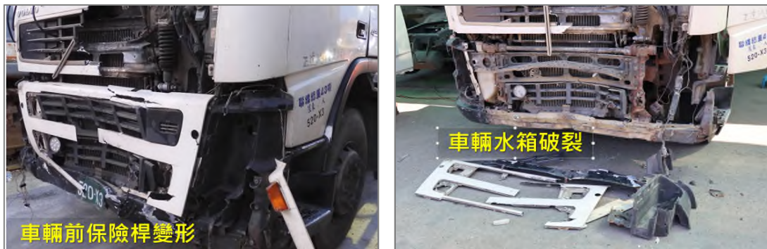
圖 10 事故車輛 U 損壞情形
