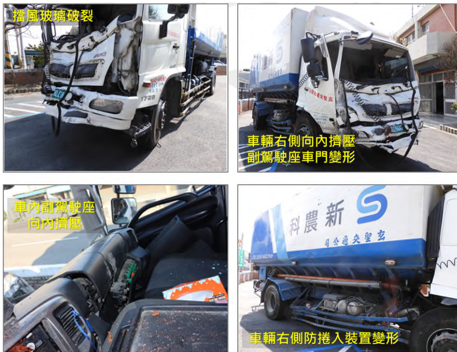
圖 8 事故車輛 F 損壞情形
